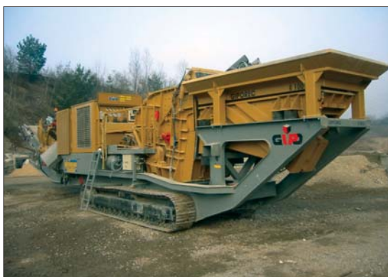
W ciągu miesiąca maszyna zużywa przeciętnie około 6.000 litrów oleju roślinnego przerabiając przy tym 13.000 ton materiału
