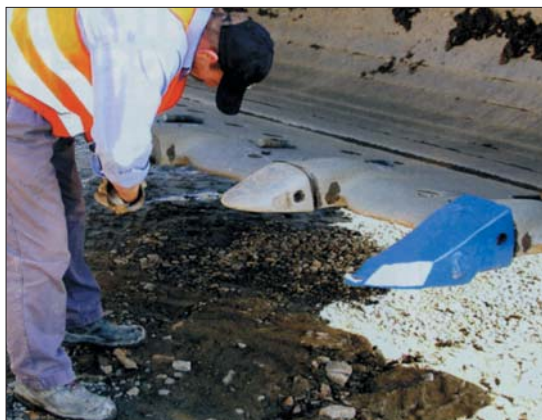
Wymiana zęba jest na ogół bardzo prosta, stanowi kwestię minut i nie przysparza większych kłopotów. Nie jest do tego potrzebny warsztat, ani specjalistyczne narzędzia
