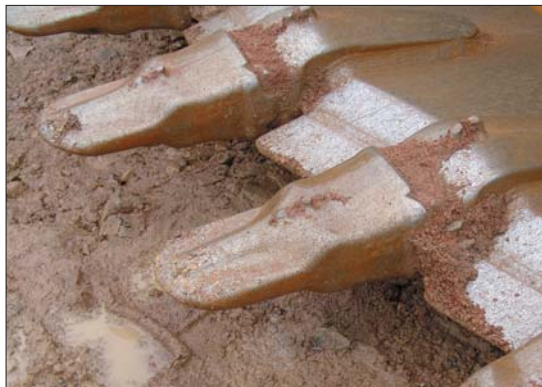
Zęby w maszynach ulegają zużyciu. Zaniechanie działań związanych z ich wymianą, prowadzi do przykrych następstw technicznych, a w konsekwencji także finansowych
