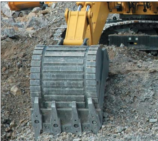
W łyżce Komatsu zamontowano system zębów K VX Ripper HD
