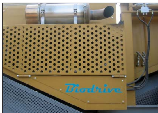
Silnik kruszarki poddany został niewielkim przeróbkom. Specjaliści firmy BIODRIVE AG zastosowali grzałkę filtra i bloku
