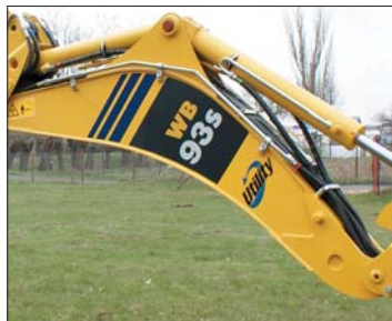
Łukowy profil wysięgnika zapewnia większy udźwieg koparki i ułatwia omijanie przeszkód
