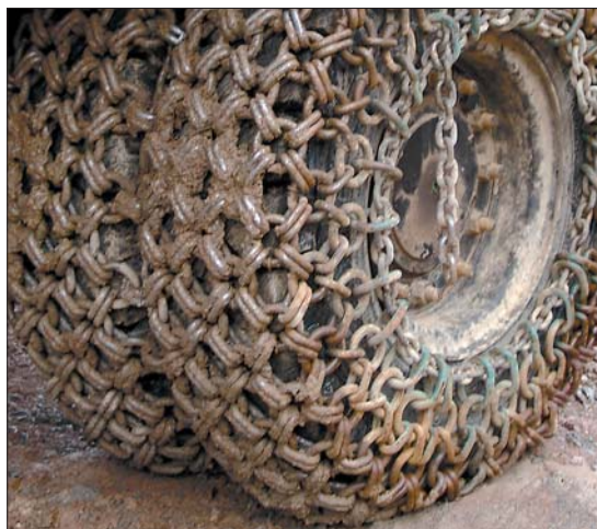
Odpowiednie dobranie rodzaju ogumienia do warunków, w jakich pracuje maszyna oraz stosowanie łańcuchów ochronnych na koła pozwalają przedłużyć żywotność opon
