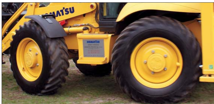
Wszystkie koła maszyny mają ten sam rozmiar, co daje korzystniejszy rozkład obciążeń i większą przyczepność
