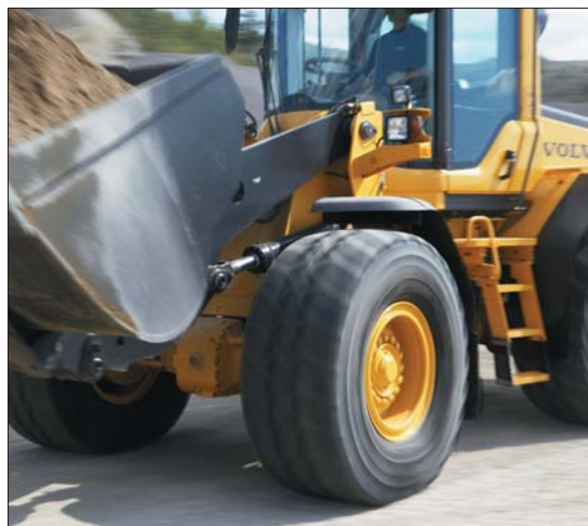
Wynikająca z braku umiejętności operatora praca zrywami, szybkie podjazdy i częste hamowanie prowadzić mogą do uszkodzenia struktury mieszanki gumowej i przegrzania osnowy
