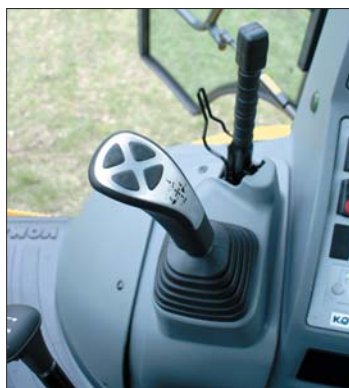
Wielofunkcyjny joystick ładowarki pozwala sterować łożką 4w1, sprzęgłem i prędkością
