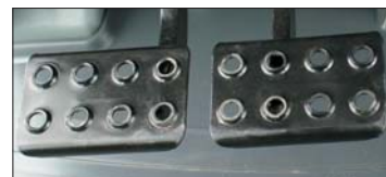
Hamulce tarczowe są uruchamiane za pomocą dwóch oddzielnych pedałów
