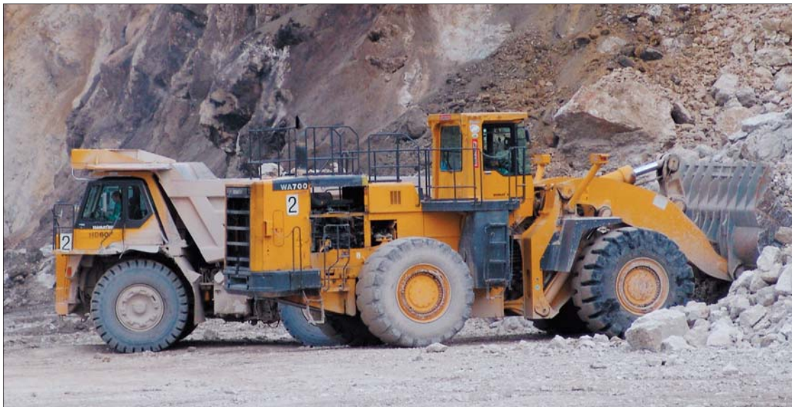
Maszyny i pojazdy pracujące w kopalniach surowców skalnych muszą rozwijać dobre sily przyspieszania i hamowania. Z tego powodu wyposażane być muszą w ogumienie wysokiej jakości
