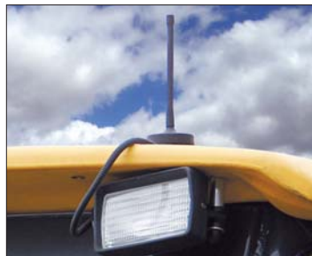
Ta niepozorna antena umożliwia funkcjonowanie systemu Komtrax
