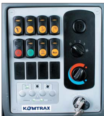
Zmiana trybu pracy układu kierowniczego odbywa się za pomocą umieszczonych na panelu przycisków
