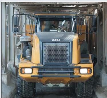
Wozidło Bell B25DN o mniejszej szerokości wykorzystywać można w miejscach o ograniczonej przestrzeni
