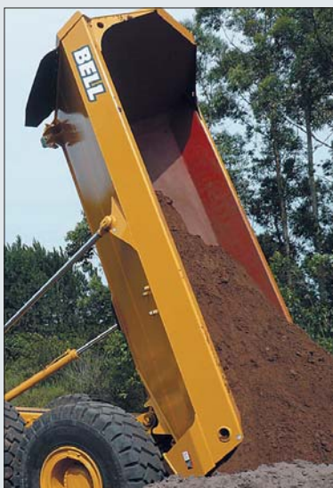
Skrzynię ładunkową wyposażono w nowy układ hydrauliczny usprawniający wysyp materiału
