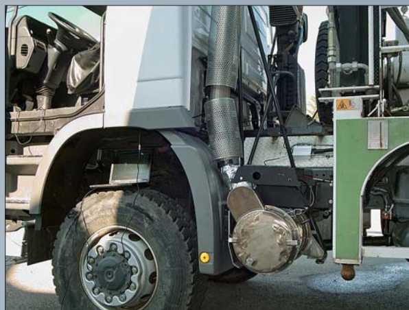
W tej ciężarówce w miejsce standardowego zamontowano nowatorski system samoregenerujących się filtrów firmy PURitech
