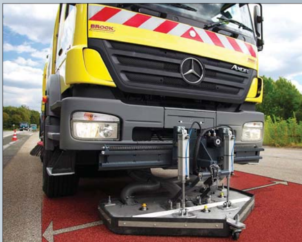
Nowy moduł dzięki możliwości przesuwania na boki pozwala na czyszczenie całej szerokości pasa z prędkością do 7 km/h
