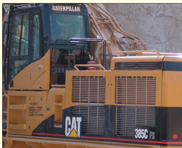
Panele boczne znajdujące się z reguły z obydwu stron maszyny zapewniają dostęp do pozostałych komponentów układu chłodzenia. Ułatwia to w znaczny sposób prowadzenie prac serwisowych i czyszczenie elementów układu
