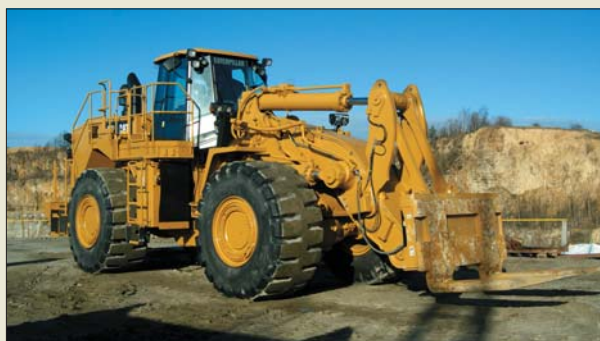
Specjalistyczny sprzęt pozwala poszerzyć zakres zastosowań maszyn. Ta ładowarka pracująca w polskim kamieniołomie pełni rolę nośnika bloków skalnych
