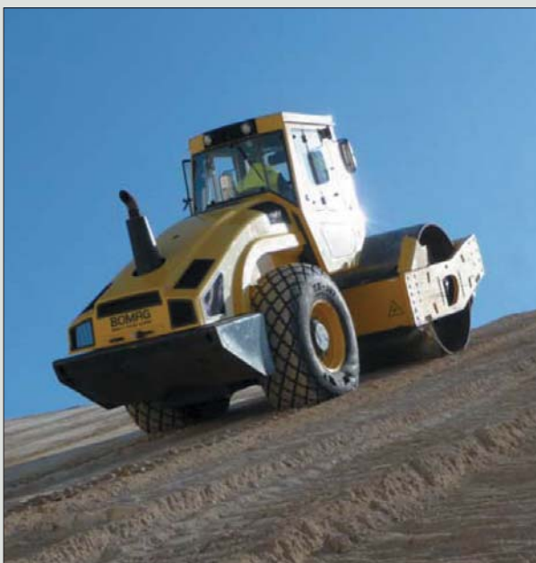
Walec wibracyjny do robót ziemnych BW 213 DH-4 bez najmniejszego trudu pokonywał wzniesienia o nachyleniu dochodzącym do 62 procent
