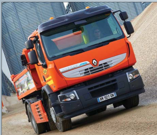
Renault Premium Distribution Hybryd Tech powstało na bazie modelu Premium Distribution 4x2 z nadwoziem samowyładowczym
