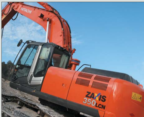
Maszyny Hitachi z serii ZAXIS-3, takie jak prezentowana na zdjęciu koparka ZX350LCN wyposażono standardowo w system kontroli satelitarnej Global e-Service
