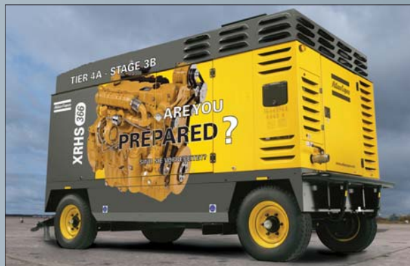
Sprężarka Atlas Copco XRHS 366 wyposażona jest silnikiem CAT C9.3 ACERT spełniającym najnowszą normę TIER 4A/Stage III B
