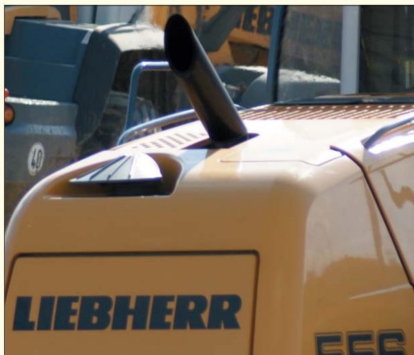
Konstruktorzy stosują rozwiązania pozwalające ograniczyć zanieczyszczenia przedostające się do układu chłodzenia wraz z zasysanym powietrzem. W ładowarkach Liebherra przechodzi ono przez specjalny otwór ze stożkową osłoną
