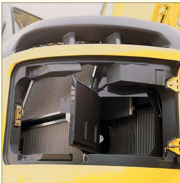
W nowatorskim układzie stosowanym przez New Holland jednostka napędowa i wentylator znajdują się wewnątrz specjalnego kanału. Ogranicza to rozprzestrzenianie się fal dźwiękowych i pozwala przechwycić nieczystości
