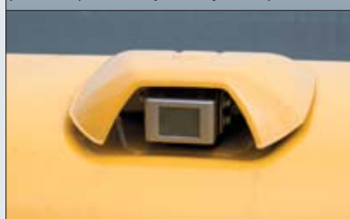
Kamerę wsteczną umieszczono w specjalnej obudowie, co ogranicza ryzyko uszkodzenia
