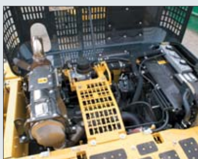
Zamontowane w komorze silnika podezpy ułatwiają dostęp do poszczególnych podzespołów
