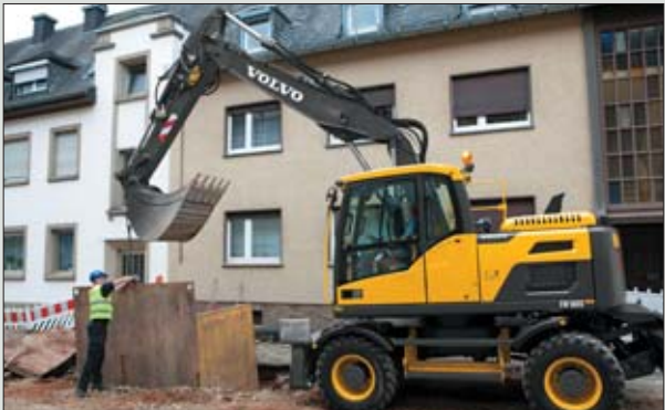
Zmiany konstrukcyjne nowych koparek kołowych Volvo widoczne są praktycznie w każdym elemencie. Począwszy od nowego silnika, kabiny, hydrauliki, systemu sterowania, aż po nowe ramię i wysięgnik
