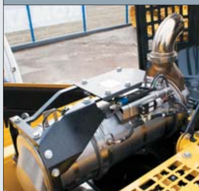
Opracowany przez Komatsu filtr DPF wychwytyuje ponad 90 procent cząstek stałych ze spalin
