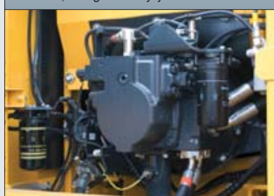
Filtr oleju silnikowego, filtry paliwa i zawór spustowy są dostępne z poziomu podłoża
