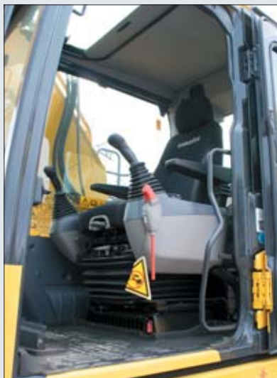
Nowa komfortowa kabina o wzmocnionej rurowej konstrukcji zaprojektowana została specjalnie dla koparek hydraulicznych
