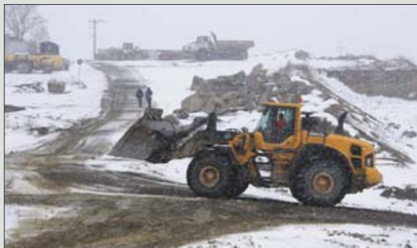
Zakład Górniczy Doboszowice eksploatuje koparki gąsienicowe, ładowarki i wozidła przegubowe Volvo. Wszystkie maszyny wyposażone są w układ telematyczny Caretrack w wersji Advanced
