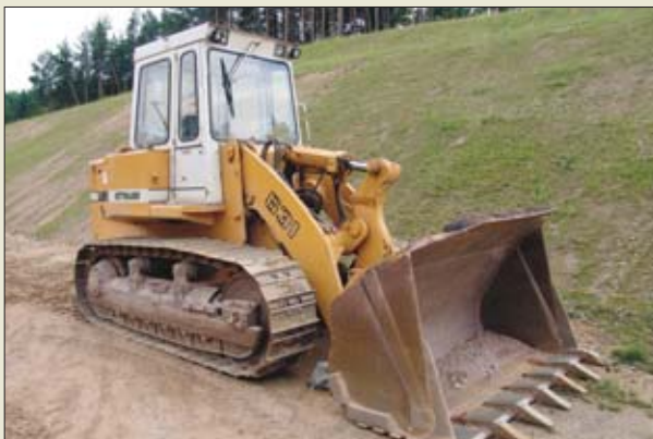
W roku 1978 bazując na własnych wieloletnich doświadczeniach Liebherr uruchomił produkcję ładowarki gąsienicowej o napędzie hydrostatycznym
