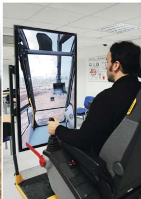
dynamiczny, trójosiowy symulator koparki VOLVO
