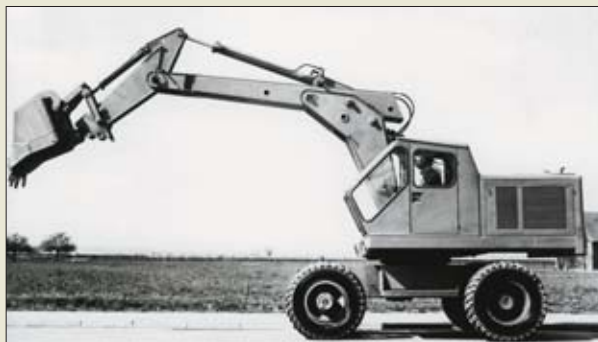
W roku 1960 Liebherr uruchomił produkcję w pełni hydraulicznej koparki kołowej. Model A 650 szybko zyskał sobie powszechne uznanie użytkowników
