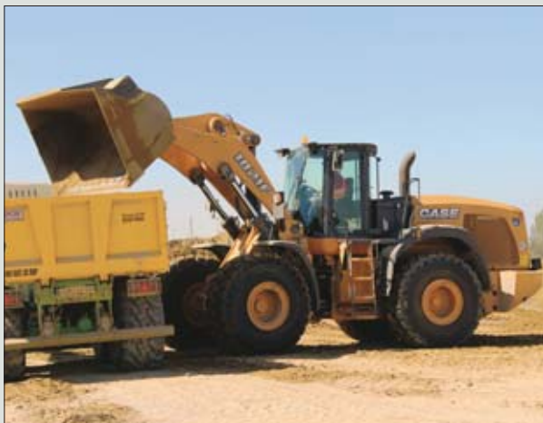
System SiteWatch opcjonalnie zamontować można we wszystkich pozostałych ciężkich maszynach marki Case, takich jak ładowarki kołowe
