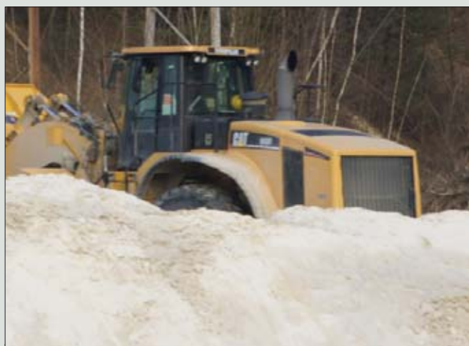
Eksploracja maszyn w kopalni piasku stawia dodatkowe wyzwania przed ich układem chłodzenia. Niskie prędkości przejazdów wiążą się bowiem z wolniejszym obiegiem powietrza
