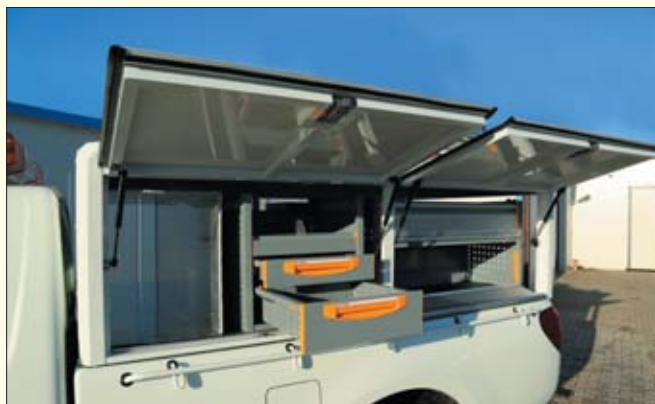
W poprzek zabudowy tuż za kabiną została umieszczona się stalowa wnęka służąca do przechowywania uziemiaczy przenośnych, której ograniczeniem z obu stron są zewnętrzne kłapy zabudowy
