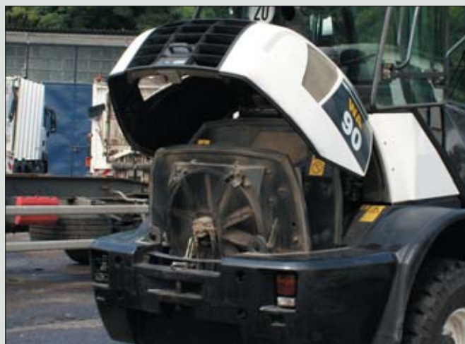
Układ chłodzenia należy regularnie kontrolować pod kątem szczelności. Każdy, nawet najmniejszy przeciek powinien być natychmiast usuwany, a ubytek cieczy chłodzącej uzupełniany
