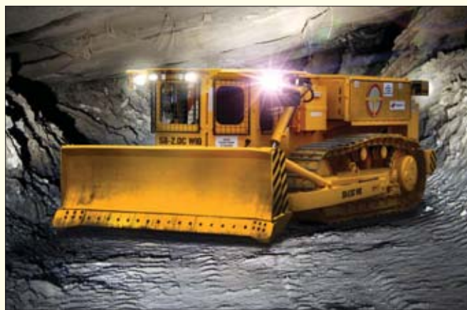
Produkowana przez Wigropol spycharka SG-2.0 C WIG przeznaczona jest do pracy w wyrobiskach eksploatacyjnych i przygotowawczych rud metali nieżelaznych
