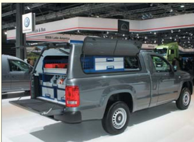
Dla użytkowników, którzy nie potrzebują dużej przestrzeni ładunkowej optymalnym rozwiązaniem mogą być nastawki laminatowe, które idealnie komponują się z resztą nadwozia
