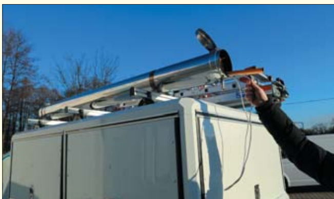
Tuba do przewozu drążków izolacyjnych ma drugie dno zamocowane na sznurku, dzięki czemu łatwo jest wyjąć przedmiot o mniejszej długości. Została ona wykonana ze stali nierdzewnej, ale istnieją też odmiany tworzywowe
