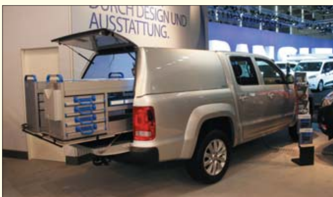
Dzięki regałom zamontowanym na wysuwanej platformie, łatwo się dostać nawet do najgłębiej umieszczonych półek czy kuwet bez wchodzenia „na kolana” do wnętrza przestrzeni ładunkowej
