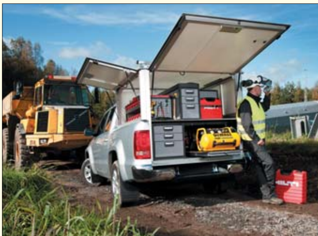
Nadbudowa prostopadłościenna gwarantuje dużą pojemność i najlepsze wykorzystanie dostępnej przestrzeni. Można w niej zastosować szerokie i wysokie klapy lub rolety, a na dachu bagażnik do przewozu drabiny
