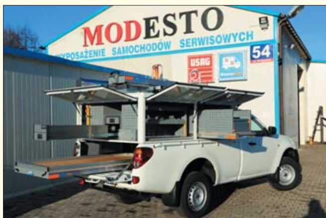
Zasadniczym elementem zabudowy warsztatowej na pick-upie dla PGE jest wysuwana platforma z aluminiowymi listwami do zaczepiania pasów mocujących. Operowanie nią nie wymaga żadnego wysiłku
