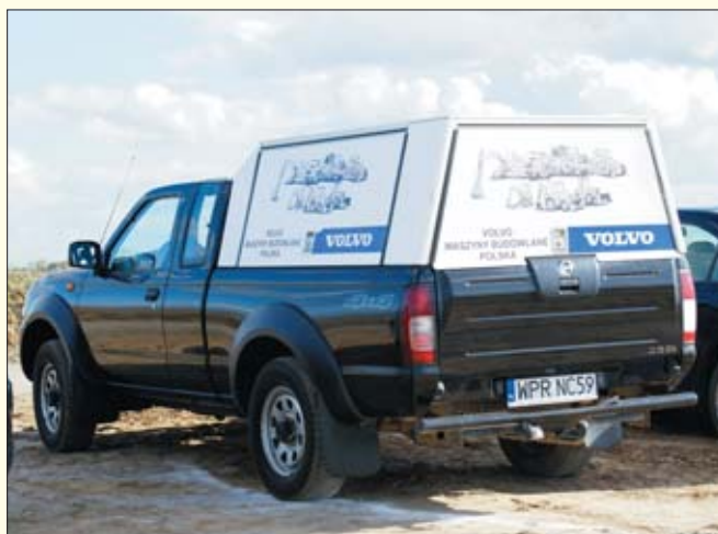
Odwzorowująca kształt kabiny nadbudowa kontenerowa o przekroju trapezu zapewni nie tylko bardziej atrakcyjny wygląd pojazdu, ale także zdecydowanie zmniejszy opory powietrza
