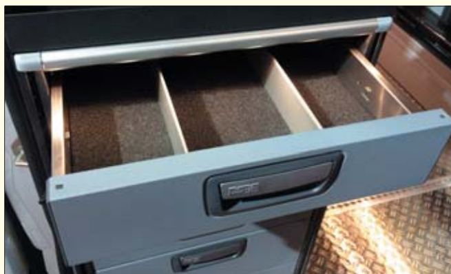
Indywidualne oświetlenie szafek, pótek czy szuflad w istotny sposób ułatwia przegląd ich zawartości. Usprawnia to pracę serwisantów, którzy nie tracą czasu na poszukiwanie elementu niezbędnego do usunięcia usterki
