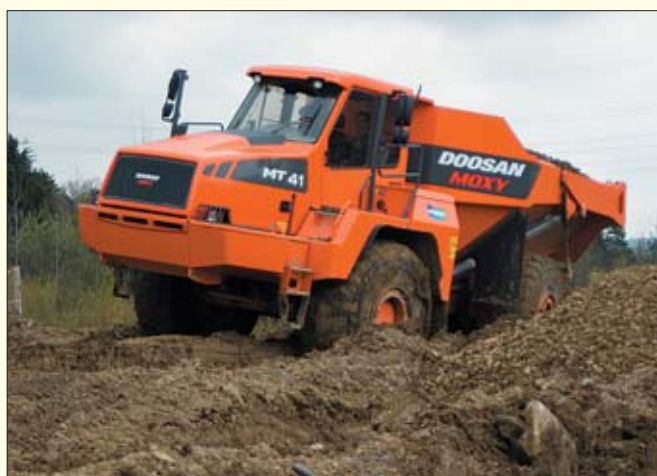
Wozidła przegubowe są w stanie pokonywać tereny, których inne pojazdy nie byłyby w stanie przejechać nawet bez obciążenia
