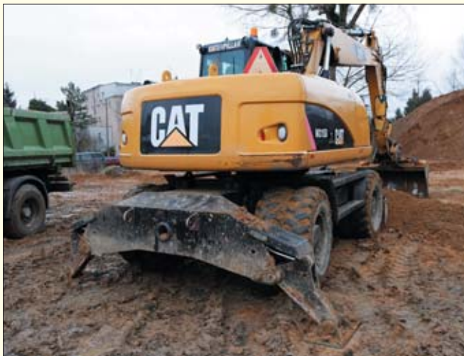
Szeroko rozstawiane podpory z dużymi podstawami zapewniają odpowiednią stabilność maszyny nawet na podłożu o mniejszej nośności. Silowniki są osłonięte specjalnymi kłapami dociskаныmi sprężynami
