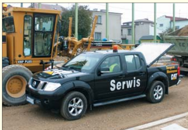
Większość pick-upów pełniących rolę serwisu mobilnego ma napęd obu osi, co wraz ze zwiększonym prześwitem i dużymi kątami najazdu/zjazdów umożliwia łatwe dotarcie w miejsce pracy obsługiwanego sprzętu
