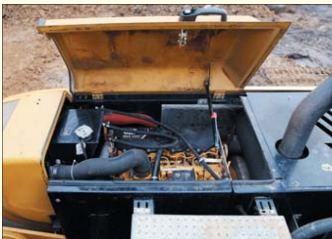
W maszynie Cat M315D mamy dostęp do silnika praktycznie z każdej strony. Bezpieczne poruszanie się po nadwoziu koparki ułatwiają szerokie podesty z zabezpieczeniem przeciwpoślizgowym
