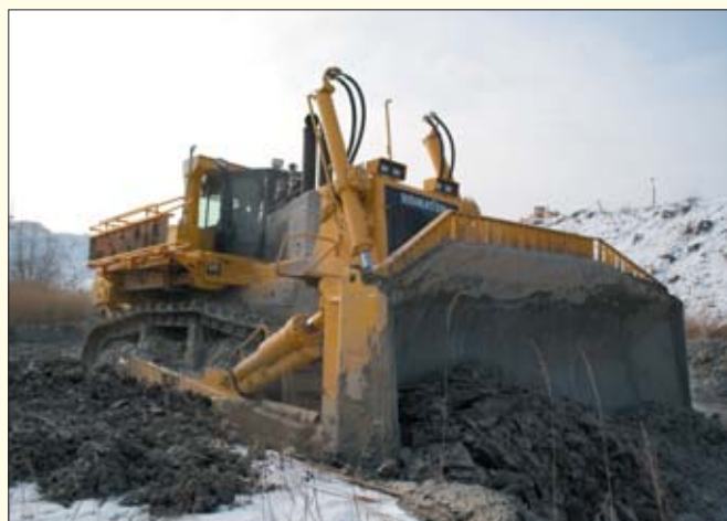
Spycharki gąsienicowe nadają się do przemieszczania urobku na niewielkie odległości, maksymalnie do stu pięćdziesięciu metrów
