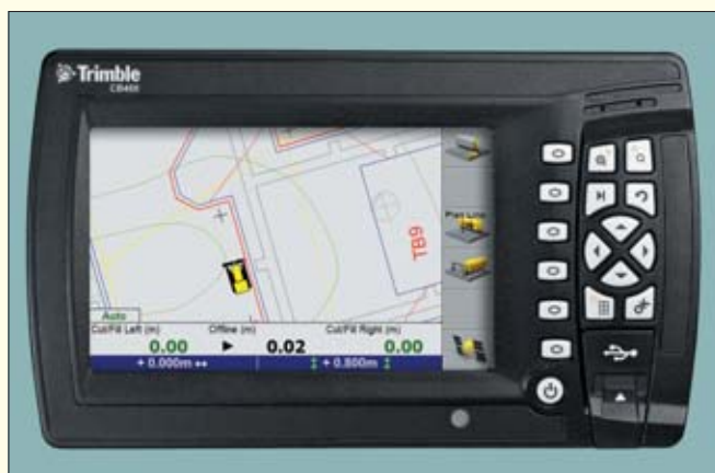
Dane dotyczące wysokości krawędzi tnącej i wysokości projektowej są wyświetlane jako wartości „TNIJ/WYPEŁNIJ” na ekranie komputera
