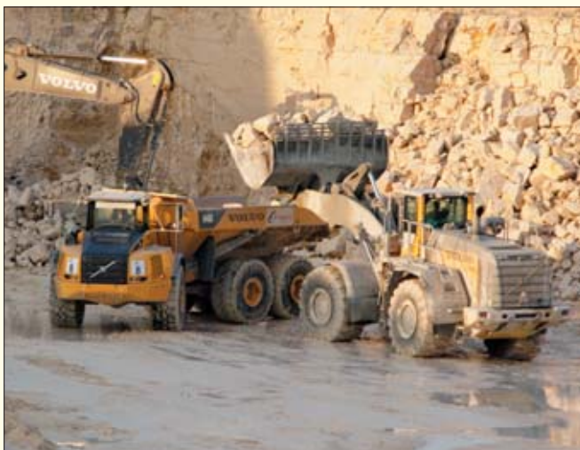
Ładowarka powinna całkowicie załadować wozidło 3-5 łyżkami, przy czym nie powinno ono czekać na połowę zwartości łyżki
