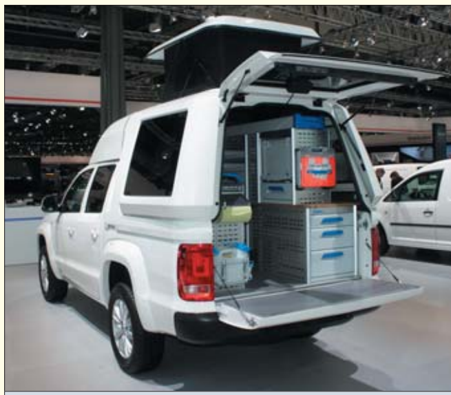
Serwisowe pick-upy służą głównie do transportu niezbędnego ekwipunku, ale na ostatniej edycji targów IAA można było zobaczyć zabudowę z unoszonym dachem, pozwalającą na pracę wewnątrz samochodu
