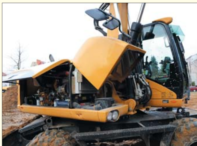
Każdy operator chętniej wykonuje codzienną obsługę, gdy nie jest ona uciążliwa, a po otwarciu bocznych pokryw koparki Cat M315D uzyskuje się wygodny dostęp do silnika, filtra powietrza, chłodnicy klimatyzacji i intercoolera
