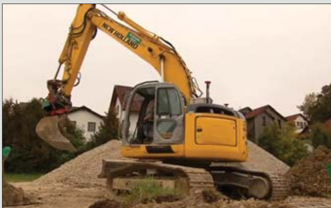
Wybrana do testów koparka New Holland E235 SR-LC wyposażona w szybkozłączę pracowała niemal nieprzerwanie z różnego typu narzędziami roboczymi
