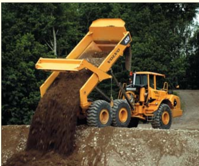
Dwuosiowy wózek jezdny pozwala na podjazd wozidłem do samej krawędzi wyrobiska i wyładunek w odpowiednim miejscu
