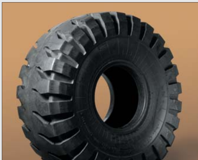
Diagonalna opona do maszyn górniczych i do prac ziemnych 26,5-25 L-4 cieszy się uznaniem użytkowników pracujących w ekstremalnych warunkach
