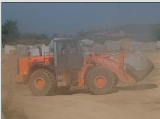
Szczególną uwagę na poprawność działania układu chłodzenia zwracać należy w okresie letnim, gdy wzrasta zapylenie środowiska pracy maszyn ze względu na mniejszą ilość opadów, wiatry i upały
