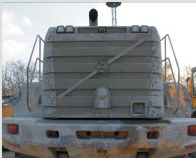
Kraty wlotowe układu chłodzenia często pokryte są grubą warstwą brudu. Maszyny poruszają się zbyt wolno, by wlatujące powietrze łatwo pokonało dodatkowe opory spowodowane kożuchem zabrudzeń
