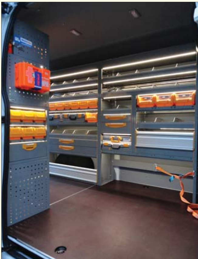
W modułach odwracalnych szuflady i „kuwety” wysuwają się wzdłuż samochodu, co zapewnia dostęp z zewnątrz pojazdu do przewożonego w nich ekwipunku
