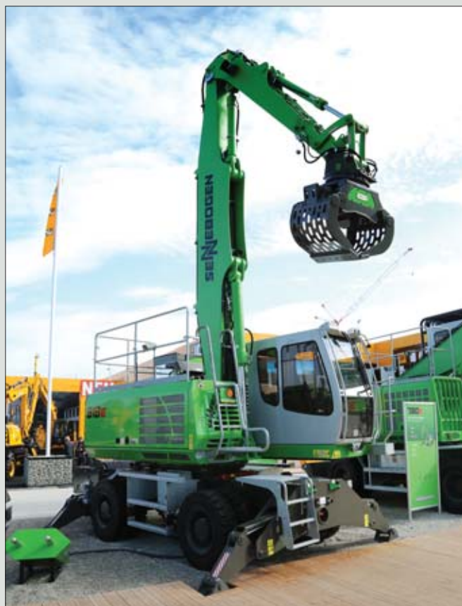
Koparka Sennebogen 818E to najmniejsza maszyna przeładunkowa spośród wytwarzanych aktualnie przez bawarskiego producenta. Podczas Baumi była prezentowana w wersji z napędem elektrycznym
