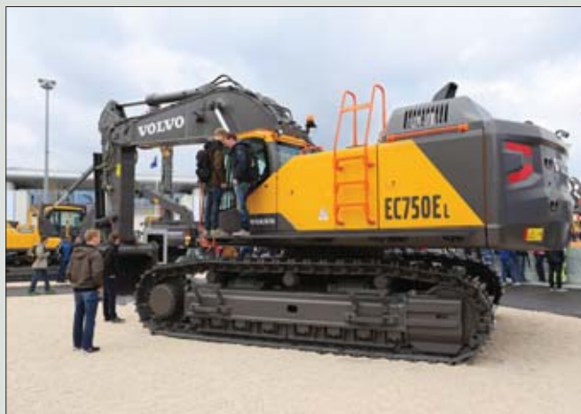
Nowa koparka gąsienicowa Volvo EC750E ma masę eksploatacyjną około 75 ton i jest napędzana 500-konnym silnikiem. Przewidziano do niej trzy podstawowe rodzaje łyżek, z szeroką gamą zębów i elementów zabezpieczających
