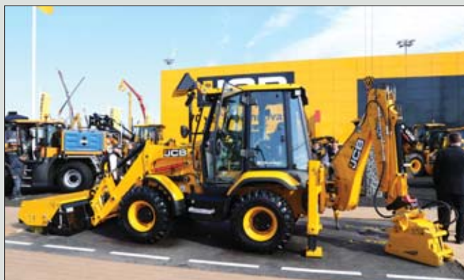
Koparko-ładowarka 3CX Compact ma osiągi porównywalne z klasycznymi maszynami tego typu, ale jej gabaryty są zdecydowanie mniejsze
