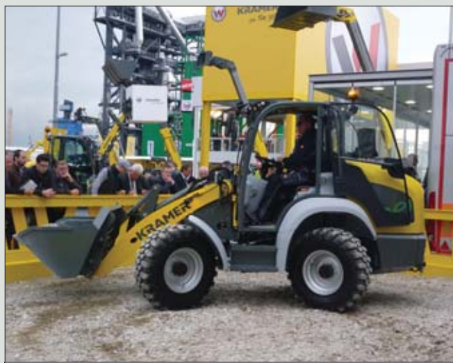
Kramer 5055e to pierwsza w pełni elektryczna ładowarka kołowa tego producenta. Wydajność, możliwość poruszania się na każdym terenie i wygoda obsługi są takie same, jak w tradycyjnym modelu z silnikiem wysokoprężnym
