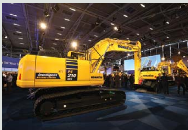
Dzięki systemowi iMC operator koparki PC210LCi-10 osiąga wysoką wydajność pracy bez ryzyka zbyt głębokiego odspajania podłoża
