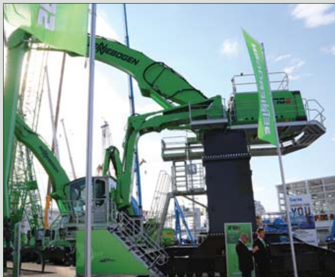
Maszyna do prac przeładunkowych Sennebogen 870 serii E wyposażona została w system akumulacji energii gromadzonej przy opuszczaniu wysięgnika, wykorzystywanej następnie do jego podnoszenia
