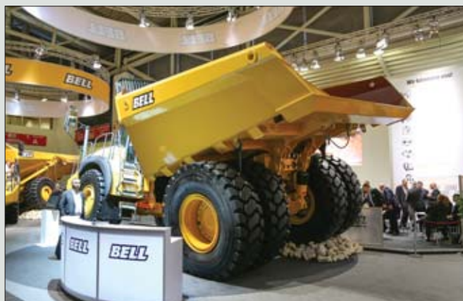
Model Bell B60E to udana mieszanka konstrukcji wozidla sztywnoramowego z przegubowym. Efektem jest pojazd o wysokiej ładowności mogący pracować nawet w najtrudniejszych warunkach terenowych
