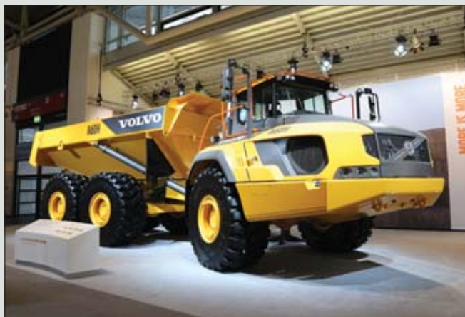
Najnowsze wozidło przegubowe Volvo A60H ma typową budowę, ale ze względu na ładowność wynoszącą aż 60 ton musi być większe. Masa własna pojazdu wynosi 43,75 tony, zaś pojemność skrzyni ładunkowej 33,6 m 3
