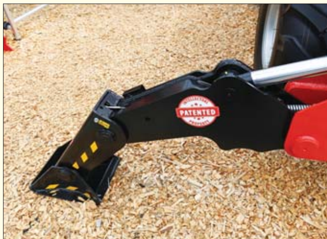
W ładowarce MRT 2145 Easy zastosowano nowe, opatentowane stabilizatory typu „pająk”, wyróżniające się lekką i zwartą konstrukcją
