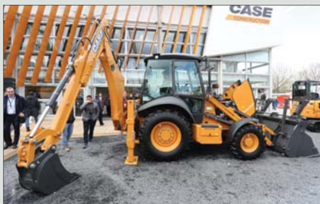
Koparko-ładowarka Case 580ST dostępna jest w dwóch wersjach sekcji koparkowej. Pozwala to na jej łatwiejsze dostosowanie do konkretnych potrzeb
