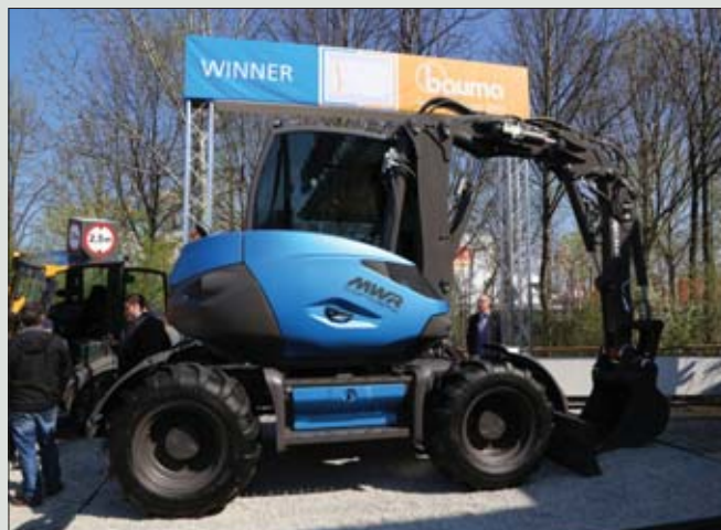
Nadwozie koparki Mecalac MWR jest osadzone poniżej płaszczyzny stykowej do górnej części kół. Takie rozwiązanie umożliwiło niższe położenie środka ciężkości, a tym samym poprawienie stabilności maszyny
