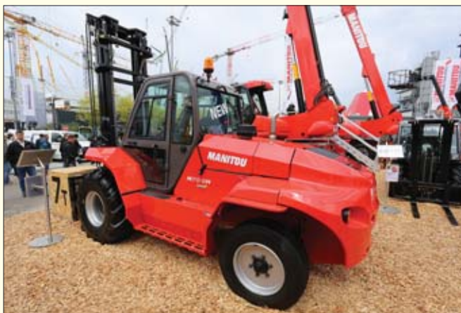
Wózek M70-2H posiada udźwig wynoszący 7 ton przy środku ciężkości ładunku 600 milimetrów. Do jego napędu zastosowano silnik Deutz o mocy 55 kW (75 KM)
