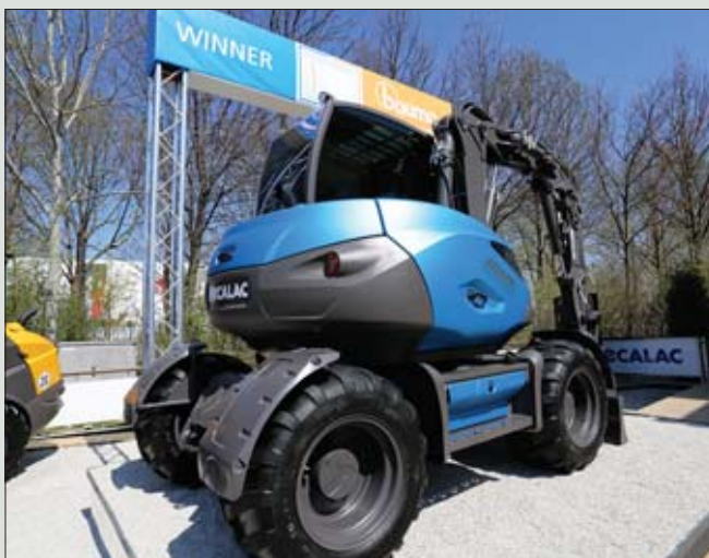
Koparka kołowa Mecalac MWR zdobyła nagrodę za wyjątkowe wzornictwo. Konstruktorzy maszyny wykorzystali koncepcję ładowarek teleskopowych, w których do maksimum wykorzystana zostaje przestrzeń między osiami
