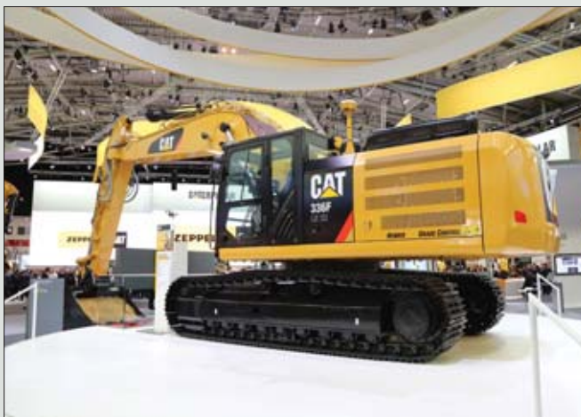
Nowa koparka gąsienicowa Cat 336F XE Hybrid może być wyposażona w podwozie o dużej wytrzymałości w wersji długiej (L) lub długiej-wąskiej (LN)
