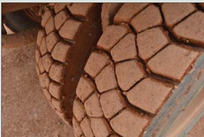
Specjalny dobór opon nie jest fanaberią. Koncerny oponiarskie stale monitorują eksploatację ogumienia, by w efekcie ustalić, jaki karkas, mieszanka, a nawet wzór bieżnika sprawdzi się najlepiej w konkretnych warunkach
