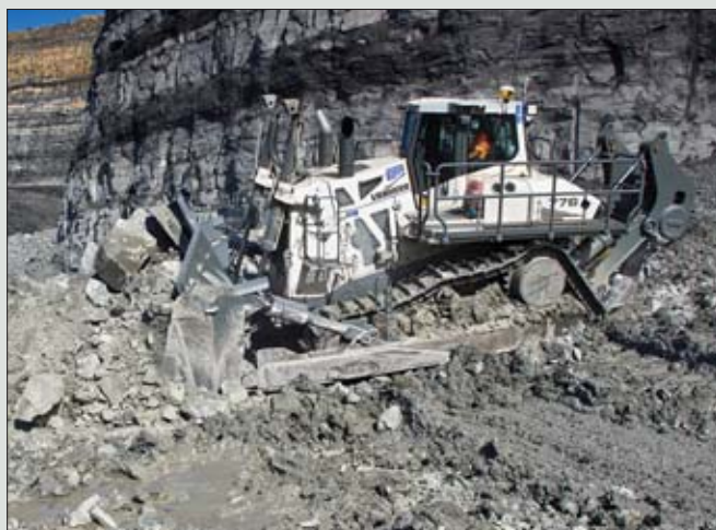
Spycharka Liebherr PR 776 o masie eksploatacyjnej 70 ton to największa seryjnie produkowana maszyna tego typu z napędem hydrostatycznym
