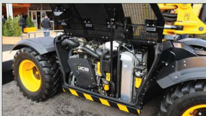
W koparce Hydradig silnik, pompę hydrauliczną oraz zbiornik paliwa umieszczono w podwoziu, dzięki czemu dostęp do nich jest stał się zdecydowanie łatwiejszy
