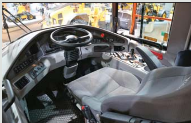
Operator wozidla A60H ma idealny dostęp do wszystkich przyrządów. Nowa maszyna jest wyposażona m.in. w system wspomagający jazdę na wzniesieniach oraz hamulec załadunku i rozładunku, pomagające w utrzymaniu pełnej kontroli nad pojazdem
