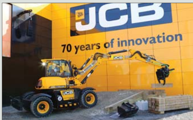
W koparce kołowej JCB Hydradig silnik i pompa hydrauliczna znajdują się między osiami, co pozwoliło na ograniczenie do minimum wielkości nadwozia
