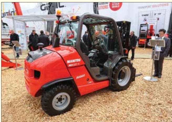
Maszty wózek widłowy Manitou MH25 ma nisko umieszczoną kabinę, co ułatwia operatorowi wchodzenie i wychodzenie z jej wnętrza
