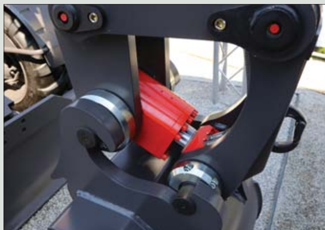
Zaprezentowana podczas monachijskich targów Bauma koncepcyjna koparka MWR była wyposażona w nowe szybkozłaczę Mecalac Connect, co w istotny sposób podnosiło produktywność i efektywność jej wykorzystania
