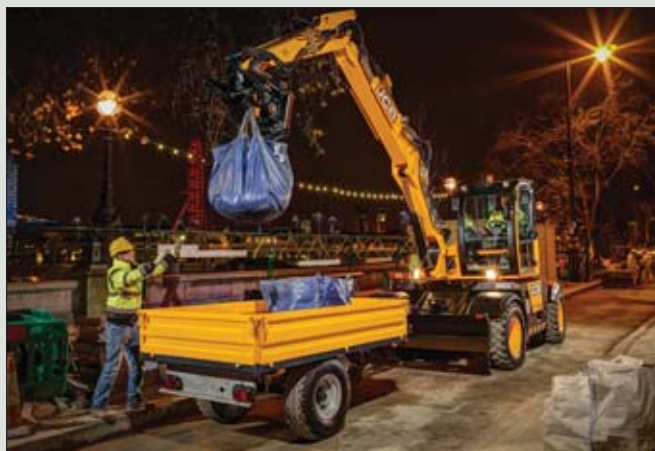
Hydradig ciągnąć może specjalną przyczepę, co ułatwia transport narzędzi roboczych lub niewielkich ładunków, na przykład materiałów eksploatacyjnych
