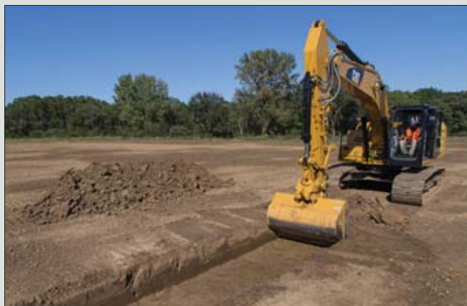
Funkcja Assist jest aktywowana, gdy krawędź tnąca łyżki osiąga zadany wcześniej przez operatora poziom
