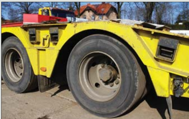
Gdy naczepa częściej przemieszcza się po asfalcie, a na placu budowy bywa tylko na chwilę, użytkownikowi oplaca się zainwestować w nowe ogumienie drogowe. Choć drogie na starcie, to przynosi oszczędności paliwa
