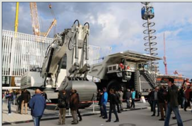
Ustawiona obok wozidła T 264 koparka Liebherr R 9200 była wyposażona w osprzęt podsiębierny z łyżką o pojemności 12,5 m 3 . Taka maszyna najlepiej sprawdza się we współpracy z pojazdami transportowymi o ładowności około 140 ton
