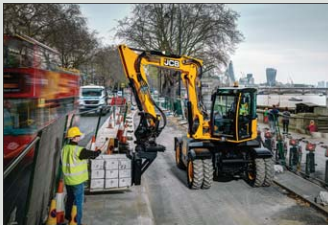
Koparka Hydradig jest dostępna z wysięgnikiem monolitycznym lub łamanym. Druga wersja umożliwia wygodne operowanie narzędziem roboczym tuż przy maszynie
