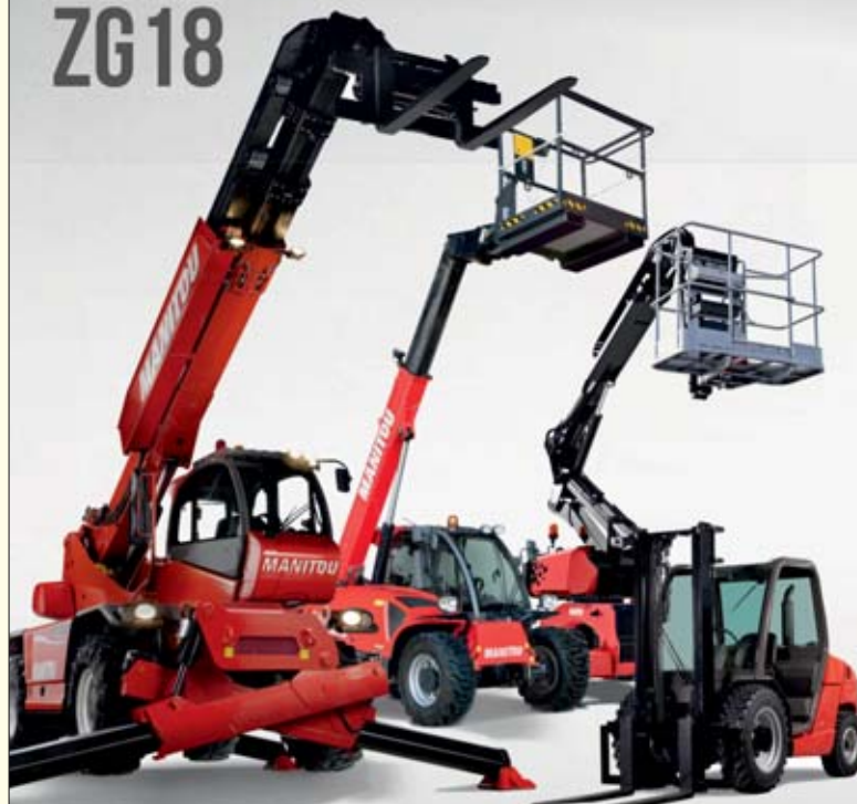
Maszty wózek widłowy Manitou MH25 ma nisko umieszczoną kabinę, co ułatwia operatorowi wchodzenie i wychodzenie z jej wnętrza
