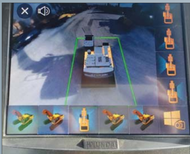
System AAVM wyposażony jest w ośmiocalowy ekran dotykowy. Zastosowany sterownik haptyczny wiąże ze sobą układ wykonawczy z interfejsem dotykowym
