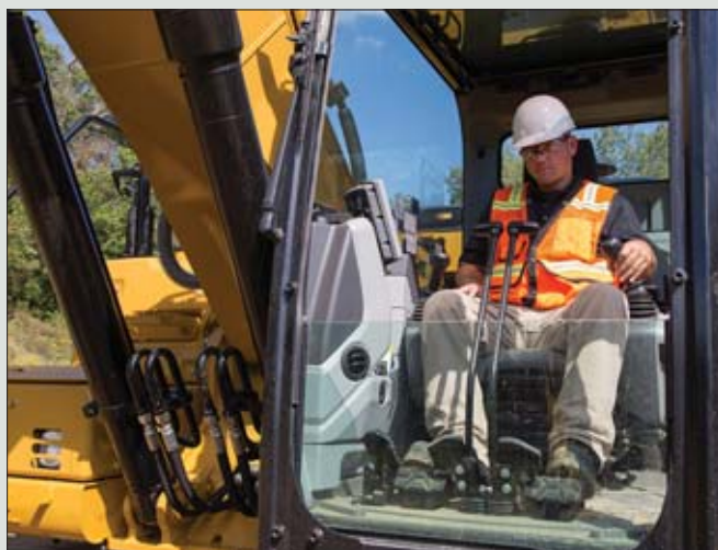
Operator steruje jedynie prędkością ruchu ramienia używając pojedynczej dźwigni, co ogranicza liczbę wykonywanych samodzielnie czynności
