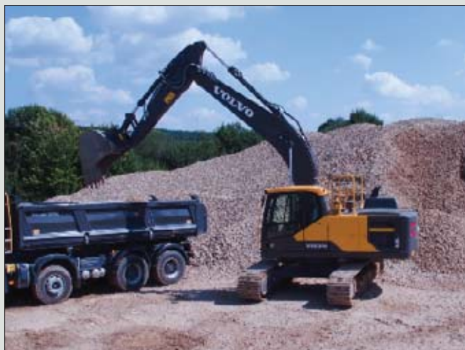
Testowane maszyny dokonywały załadunku ciężarówek. Mierzono masę ładunku, czas trwania pojedynczego cyklu roboczego oraz zużycie paliwa
