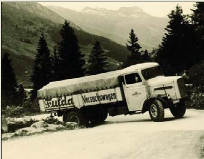
Opony Fulda ze specjalnym bieżnikiem pochłaniającym wstrząsy sprawiły, że pojazdy ciężarowe mogły przemieszczać się z większą prędkością
