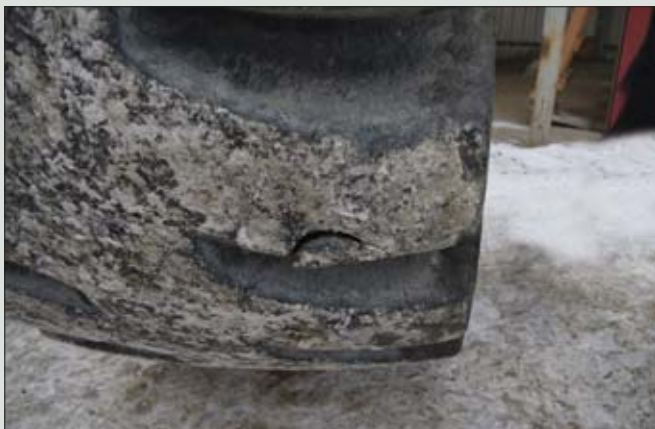
Pierwsze objawy nadchodzącej awarii – naderwana kostka bieżnika w oponie ładowarki kołowej. W tym kamieniolomie jeszcze nie przekonali się do „kolczugi” chroniącej opony uznając, że jest ona zbyt droga
