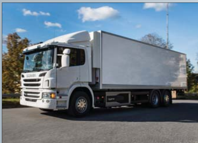
Hybrydowa Scania jest o 800 kilogramów cięższa od modelu spalinowego, ale jej użytkownik ograniczyć może aż o osiemnaście procent wydatki na paliwo
