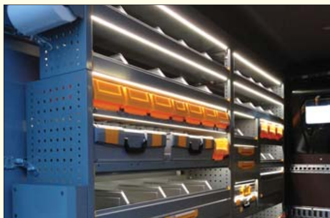
Diody LED stanowiące oświetlenie półek w zabudowach StoreVan zapewniają niski pobór prądu, są trwałe i znakomicie doświetlają wszelkie zakamarki
