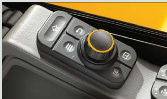
Wiele funkcji nowej maszyny obsługuje się za pomocą ergonomicznego kontrolera obrotowego zamontowanego z prawej strony fotela
