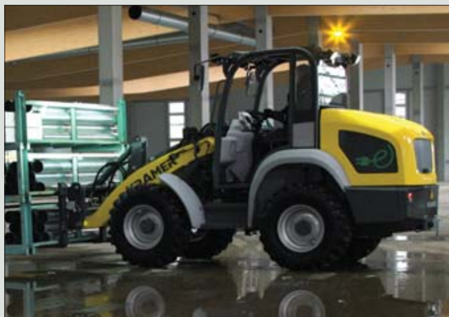
Zwycięzca nagrody za innowacyjność na targach Bauma, elektryczna ładowarka kołowa 5055e firmy Kramer nie wymaga nadzwyczajnych nakładów na konserwację. Napędzający ją silnik jest praktycznie bezobsługowy
