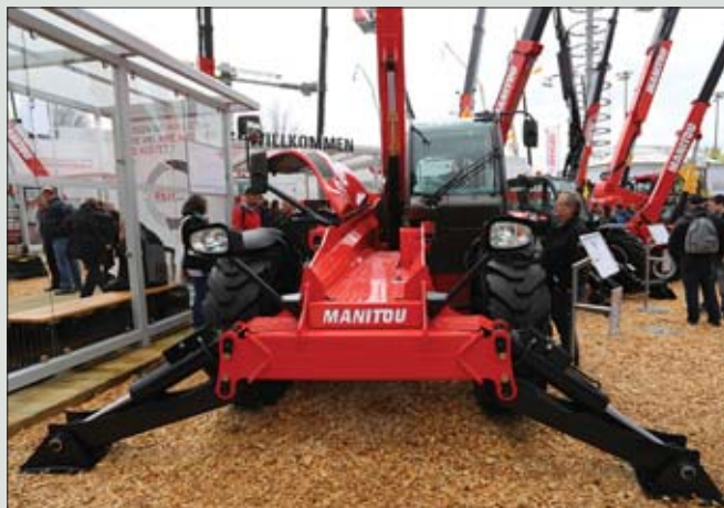
Dzięki szeroko rozstawianym przednim podporom ładowarka teleskopowa Manitou MT 1840 Easy wyróżnia się parametrami roboczymi – wysięgiem wynoszącym 17,55 metra i maksymalnym udźwigiem czterech ton
