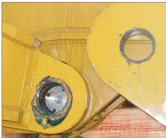
W celu przyspieszenia konfiguracji wysięgnika konstruktorzy Komatsu zastosowali specjalne hydrauliczne złącze
