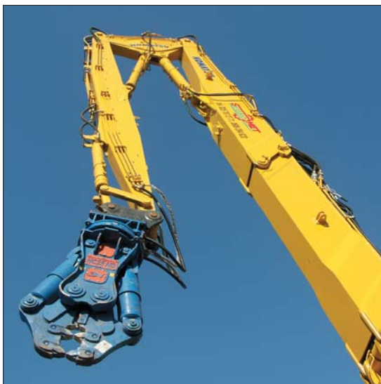
Koparka PC450LC może być eksploatowana z zestawionym na trzy sposoby wysięgnikiem o specjalnej wzmocnionej konstrukcji
