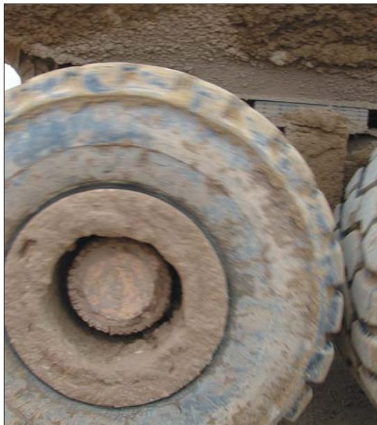
W przypadku maszyn kołowych, szczególnie wozideł i ładowarek istnieje ryzyko przegrzewania się opon z powodu ich niewłaściwego doboru oraz na skutek zbyt niskiego ciśnienia
