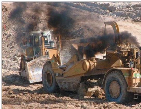
Spaliny mające kolor czarny stanowią oznakę nadmiaru paliwa, czego przyczyną może być na przykład zanieczyszczony filtr powietrza lub kapiące dysze wtryskiwaczy
