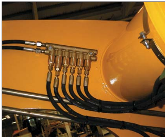
Zamontowanie systemu centralnego smarowania to opłacalna inwestycja pozwalająca wydłużyć bezawaryjny czas eksploatacji sprzętu
