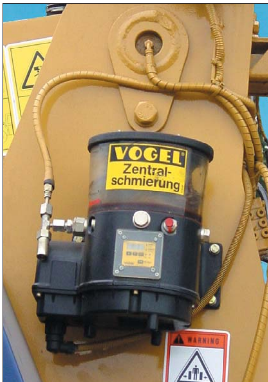
Progresywne układy centralnego smarowania zyskują sobie coraz większą liczbę zwolenników wśród użytkowników maszyn budowlanych
