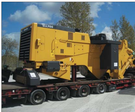
Ze względu na swe gabaryty i wagę ładowarka dotarła na miejsce montażu na przyczepach niskopodwoziowych. Największym z transportowanych elementów był główny korpus maszyny
