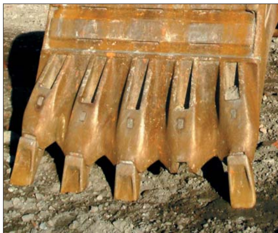
Zużyte zęby, zły stan techniczny łyżek lub szufli koparek i ładowarek powodują za sobą nadmierne zużycie się maszyny oraz zwiększenie apetytu na paliwo
