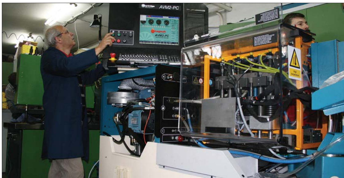
Mechanicy firmy Pezal używają do naprawy aparatury wtryskowej w silnikach wysokoprężnych najnowocześniejszych urządzeń BOSCH
