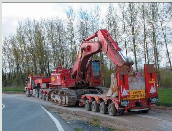
Maszyny nie będące w stanie poruszać się samodzielnie są transportowane na specjalnej naczepie samochodowej, zwykle niskopodwoziowej
