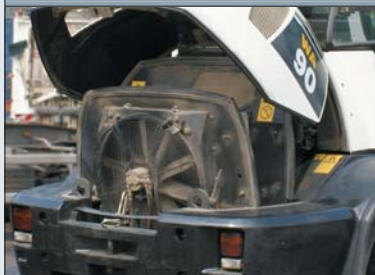
Szeroko otwierana pokrywa silnika ułatwia wykonanie przeglądu codziennego
