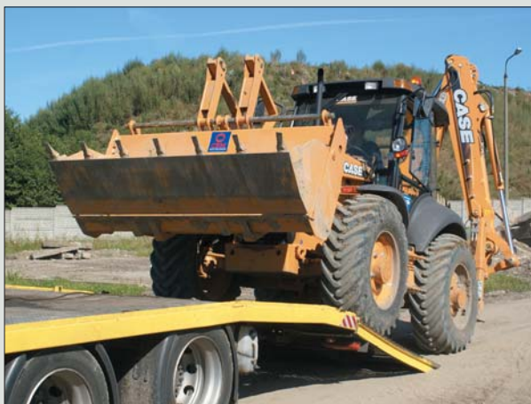
Ładunek maszyn na środki transportu jezdniowego może odbywać się za pomocą zintegrowanych z naczepą najazdów
