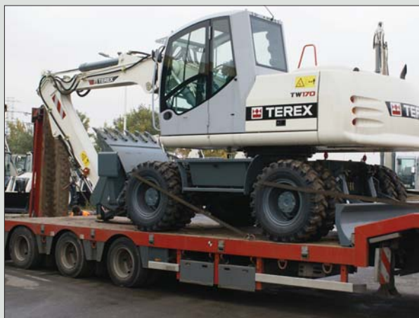
Transport maszyn nie może powodować zagrożenia dla uczestników ruchu drogowego. Ważne jest odpowiednie mocowanie maszyny
