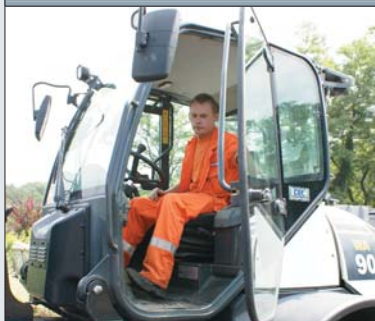
Duże powierzchnie przeszkłone i ogrzewana tylna szyba zapewniają doskonałą widoczność
