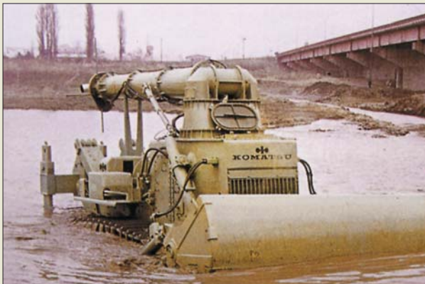
Widoczna na zdjęciu zdalnie sterowana spycharka do robót podwodnych to jedna z najbardziej niezwykłych konstrukcji w historii Komatsu
