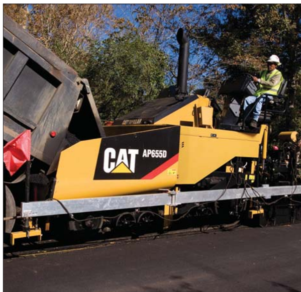
Najważniejszym rozwiązaniem zastosowanym w rozścielaczu AP655D jest gąsienicowy układ jezdny MTS (Mobil-trac System) zapewniający dużą siłę uciążu, a jednocześnie błyskawiczne przemieszczanie się maszyny
