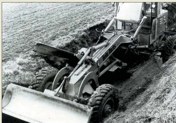
Hanomag wytwarzał wyłącznie dwuosiove równiarki. Maszyny wyróżniały się dobrymi parametrami roboczymi, mogły poruszać się po drogach z prędkością do 40,5 km/h
