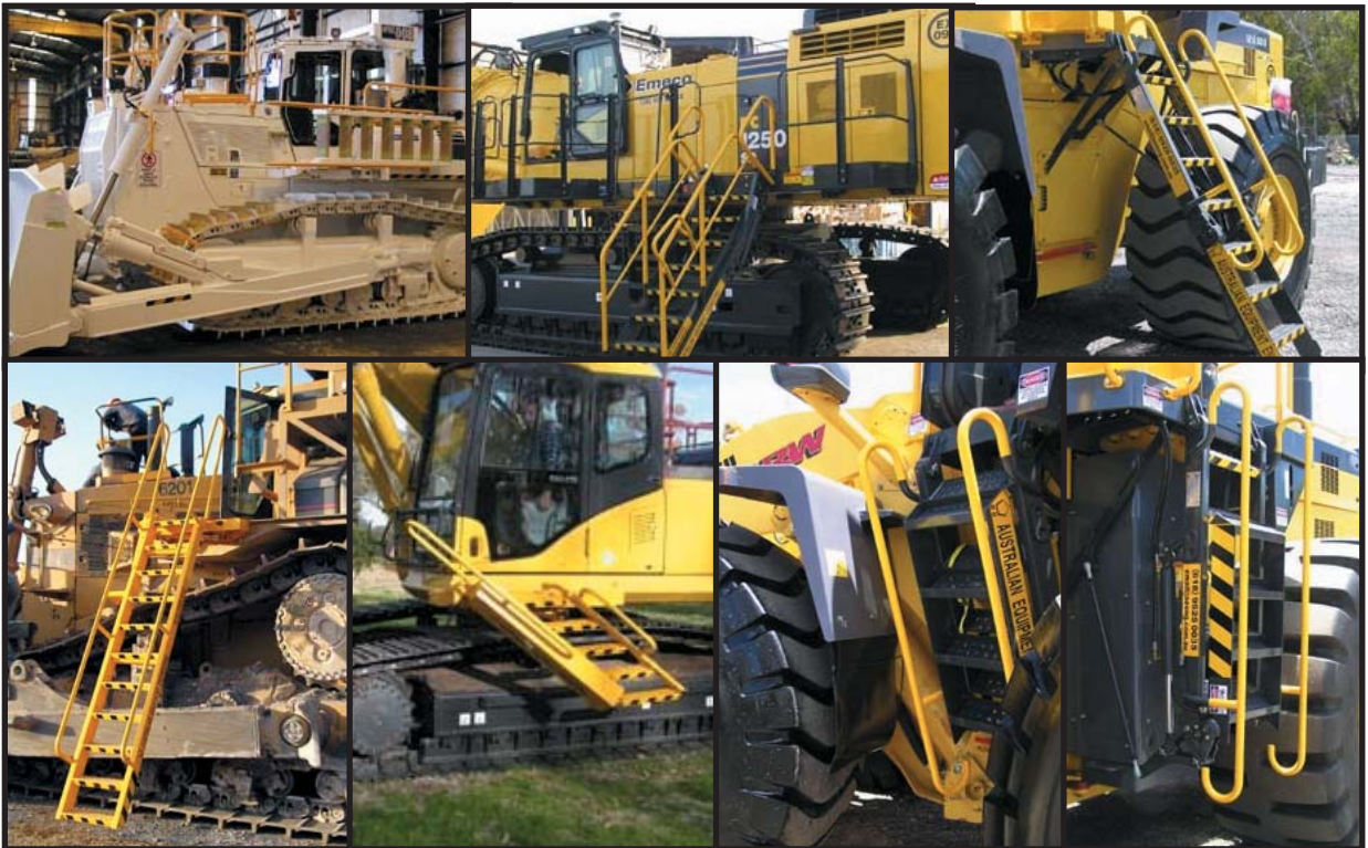
Uruchomione przyciskiem blokującym układ jezdny, schody łagodnie odchylają się od maszyny, umożliwiając dostęp do kabiny operatora w bezpieczny sposób. Jest to rozwiązanie dużo wygodniejsze od typowych fabrycznych systemów wejściowych
