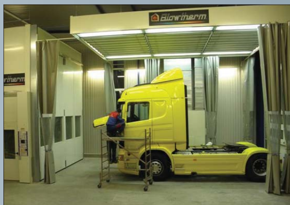
W serwisie Scania w Rzgowie koło Łodzi zamontowano należącą do najnowocześniejszych tego typu urządzeń kabinę lakierniczą Blowtherm TI 5030
