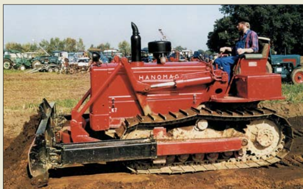
Spycharka gąsienicowa K 7 stanowiła jedną z najbardziej udanych konstrukcji Hanomaga. Cechowała ją solidna budowa, niezawodność i łatwość obsługi
