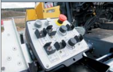
Ze zmodernizowanych bocznych stanowisk płynnie regulować można przepływ materiału
