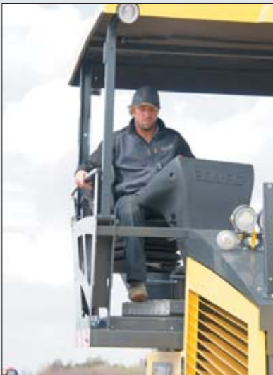
System SideView pozwala wysunąć fotel i pulpit sterowniczy aż do pięćdziesięciu centymetrów na każdą ze stron poza obręb maszyny
