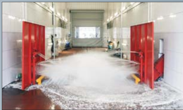
Wykorzystywana przez kopalnię Syncrude myjnia MobyDick OS firmy Frutiger pracuje skutecznie z użyciem wyłącznie zimnej wody...
