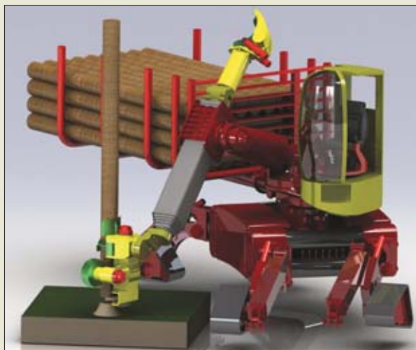
Nośnik o konstrukcji w wersji do prac leśnych wykorzystującej zalety dwunarzędziowego wysięgnika. Dzięki takiemu rozwiązaniu maszyna w czasie jednego przejazdu jest w stanie dokonać wyróbki sortymentów za pomocą głowicy harwerserowej, by następnie za pomocą chwytako-karczownika wykonać karczowanie pozostałych po ścinie pni. Maszyna jest również w stanie ułożyć gotowy ścięty surowiec na zabezpieczonej klonicami platformie i przetransportować do najbliższej składnicy przyrębowej. Maksymalna siła na zębach karczownika generowana przez wysięgnik w tej wersji maszyny wynosi około 120 kN
