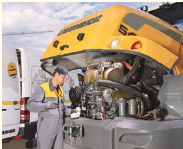
Stosowanie ultranowoczesnych środków smarnych i płynów eksploatacyjnych nie zwalnia użytkownika maszyny z ich regularnej kontroli i uzupełniania ich stanu
