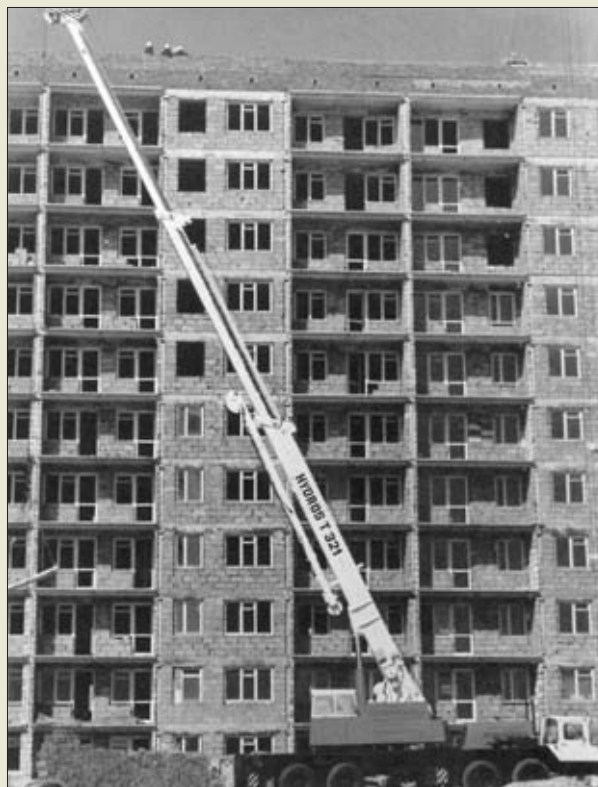
Hydros T321 – hydrauliczny żuraw na podwoziu samochodowym z wysięgnikiem teleskopowym produkowany na licencji Coles Cranes
