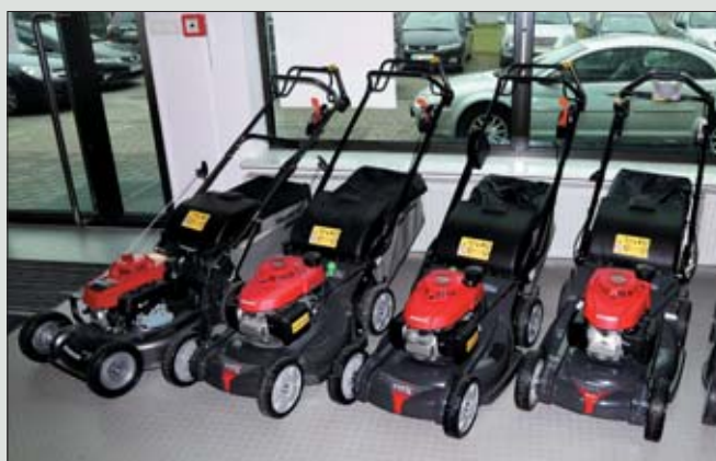
Silniki Honda GCV są stosowane m.in. w kosiarkach ogrodowych. Mają pionowo umieszczony wał korbowy, ograniczając złożoność konstrukcji
