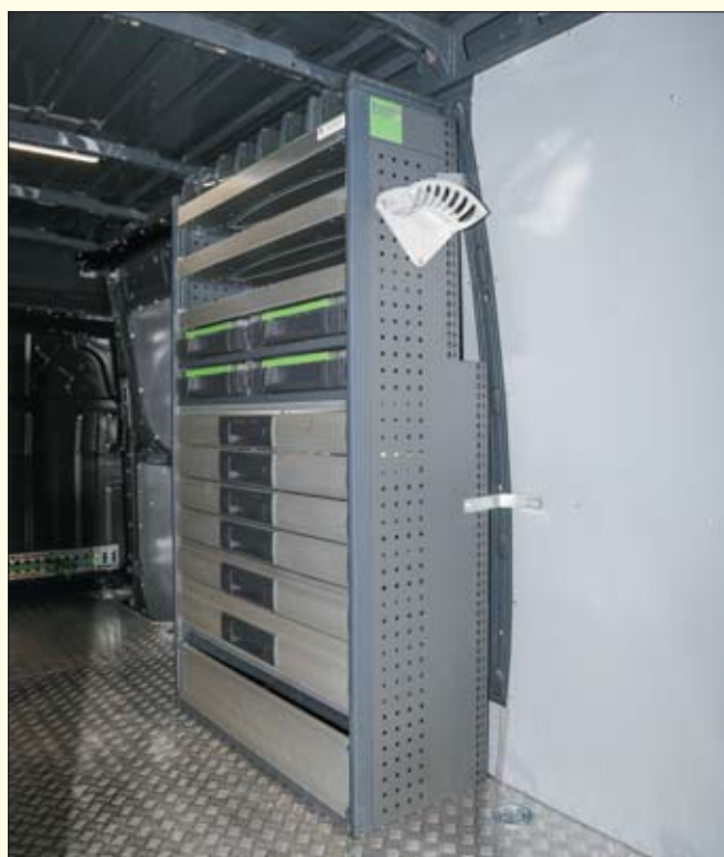
Zestopniowany moduł (o dwóch głębokościach) pozwala na lepsze odwzorowanie kształtu nadwozia, a tym samym pełniejsze wykorzystanie dostępnej przestrzeni i możliwość przewozu dwóch europalet
