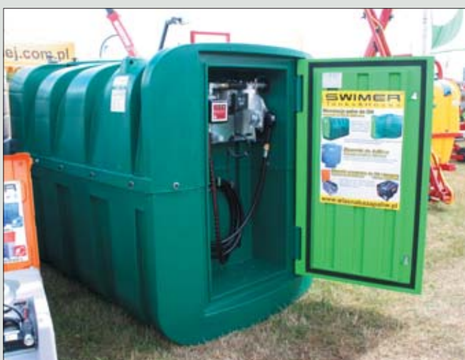
Szczelnie zamykana szafa dystrybucyjna chroni osprzęt zbiornika przed wpływem warunków atmosferycznych i ogranicza dostęp do paliwa niepowołanych osób
