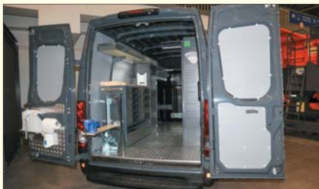
Do wersji z pojedynczymi kołami na osi napędzanej w najnowszej, trzeciej generacji Daily zaprojektowano nowe tylne zawieszenie, które pozwoliło obniżyć wysokość podłogi o około 55 mm, zapewniając łatwiejszy dostęp do wnętrza
