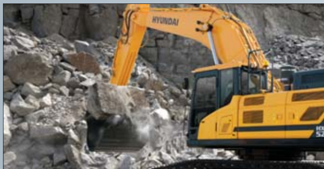
Pierwszą maszyną Hyundai, w jakiej będzie pracować silnik Scania, jest koparka HX520. Do jej napędu posłuży 13-litrowy silnik o mocy 331 kW zgodny z Tier 4f
