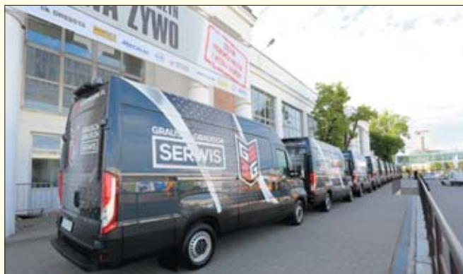
Iveco Daily zakupione przez firmę Grausch i Grausch mają rozstaw osi 3.520 mm, ale tylny zwis jest wydłużony o 400 mm, tj. do 1.520 mm. W ten sposób osiągnięto pojemność ładunkową 12 m 3 przy zachowaniu niewielkiego promienia skrętu
