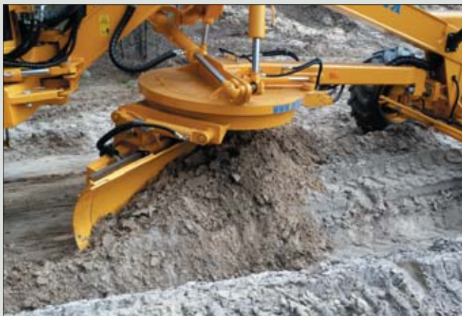
Zastosowanie napędu hydrostatycznego pozwala operatorowi na płynną zmianę prędkości jazdy, co wyraźnie zwiększa precyzję pracy
