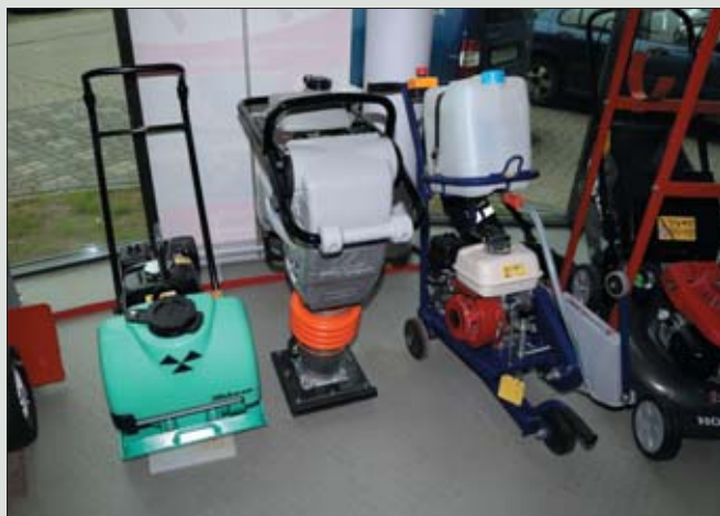
Do maszyn pracujących w najtrudniejszych warunkach Honda oferuje silniki serii GX. Są one odporne m.in. na drgania, duże zapylenie, zmienne obciążenia i paliwo kiepskiej jakości
