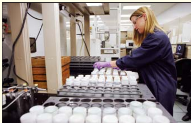
Badanie pobranych próbek płynów eksploatacyjnych odbywające się w centrum laboratoryjnym Caterpillar w Maladze pozwala określić zawartość pierwiastków metalicznych, których obecność wskazywać może na zużycie bądź uszkodzenie konkretnego elementu maszyny
