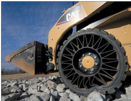
Konstrukcja Tweela podlega deformacjom, co sprawia, że doskonale absorbuje wstrząsy i nierówności
