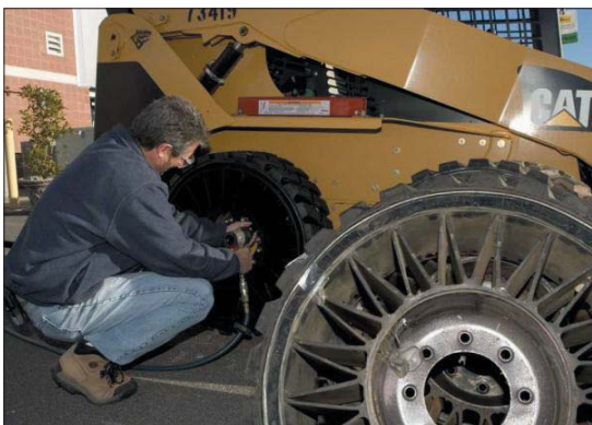
Czas na zmianę. Tradycyjne koło ładowarki kompaktowej zostanie zastąpione nowatorskim Tweelem
