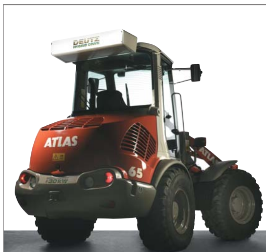
Na pierwszy rzut oka ładowarka Atlas wyposażona w napęd hybrydowy Deutz nie różni się wiele od zwykłej maszyny. Uwagę zwracają jedynie akumulatory litowo-jonowy przytwierdzone z tyłu dachu kabiny
