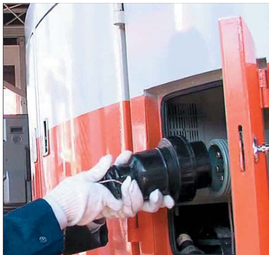
Wprzećniętych warunkach pracy akumulatory koparki BEX należy ładować co dwie-cztery godziny. Ładowanie trwa nieco dłużej w porównaniu z tradycyjnym tankowaniem
