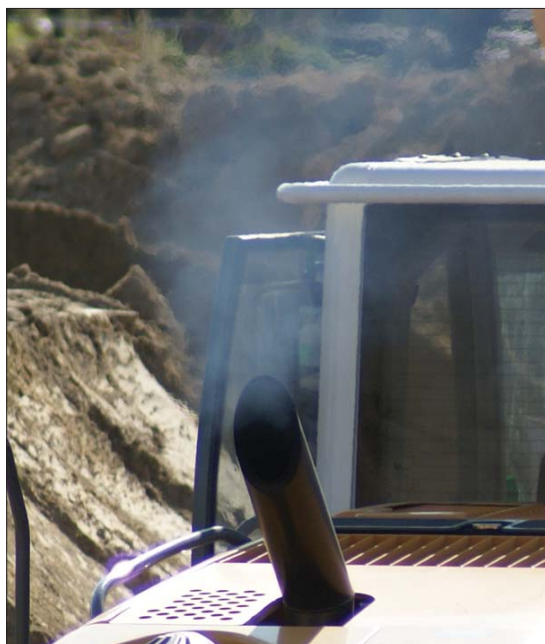
Filtr cząsteczek stałych wychwytuje do 99 procent szkodliwych substancji zawartych w spalinach. Warto zainwestować w system filtracji, nawet gdy nasza maszyna pracuje na codzień na terenie otwartym
