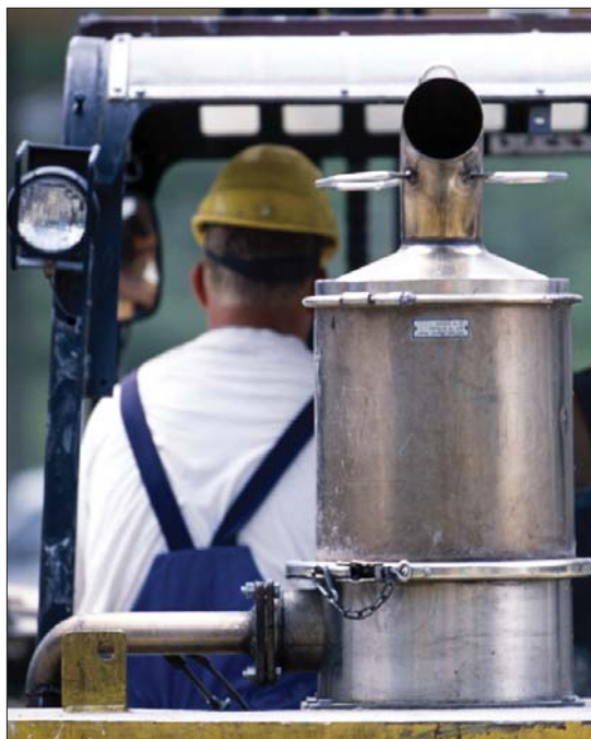
Najbardziej popularne wśród użytkowników maszyn budowlanych są systemy z filtrami wymiennymi. W celu poddania regeneracji trzeba je zdemontować i oczyścić w zewnętrznym podgrzewaczu elektrycznym
