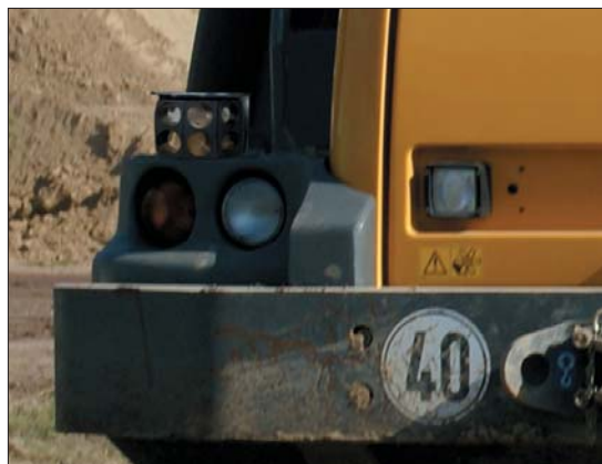
Zaletami systemu Greensight jest ograniczenie liczby wypadków z udziałem ludzi oraz kolizji powodujących uszkodzenia maszyny
