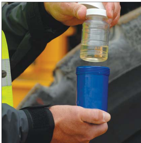
Korzyści wynikające z badań oleju polegają na ograniczeniu ryzyka zaskakujących przestojów i wydłużeniu żywotności maszyny
