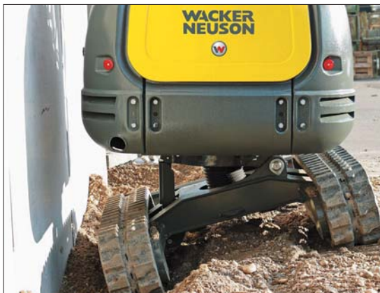
Vertical Digging System pozwala bezstopniowo pochylać podwozie koparki, dzięki czemu operator pracować może w prostej pozycji siedzącej
