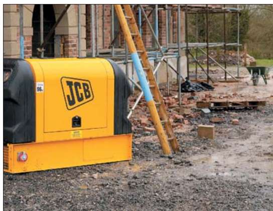
Typoszereg urządzeń oferowanych przez JCB obejmuje modele o mocy w zakresie od 15 do 500 kVA, dlatego też łatwo dobrać agregat spełniające konkretne potrzeby placu budowy
