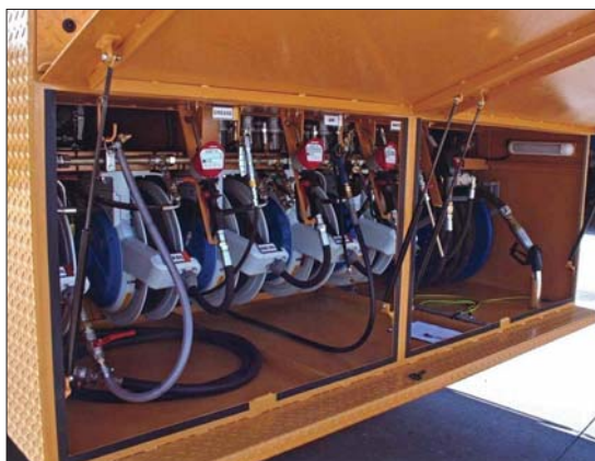
Zamontowane na wozidle zbiorniki pozwalają uzupełnić płyny eksploatacyjne każdej maszyny budowlanej. Urządzenie do szybkiego tankowania ma wydajność do 800 litrów na minutę
