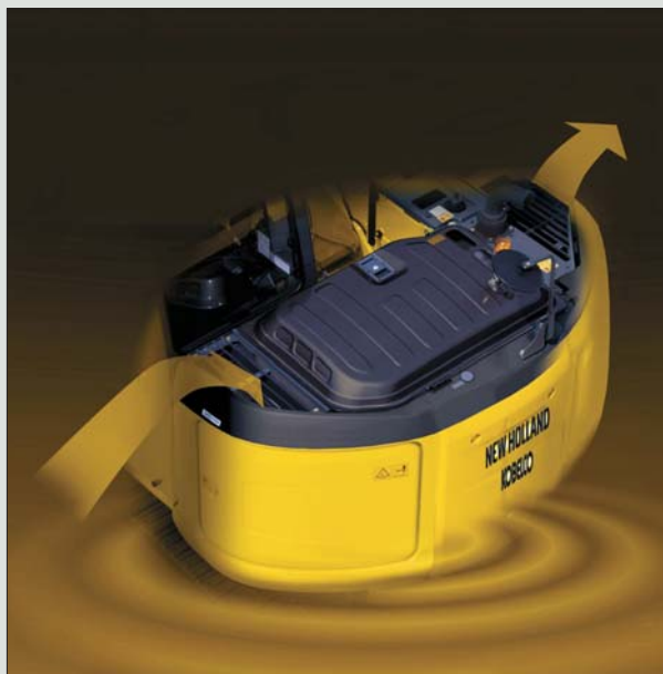
Główne źródła hałasu, jakimi są jednostka napędowa i wentylator znajdują się wewnątrz specjalnego kanału. W ten sposób udaje się nie tylko zapobiec rozprzestrzenianiu się fal dźwiękowych, ale również przechwycić nieczystości
