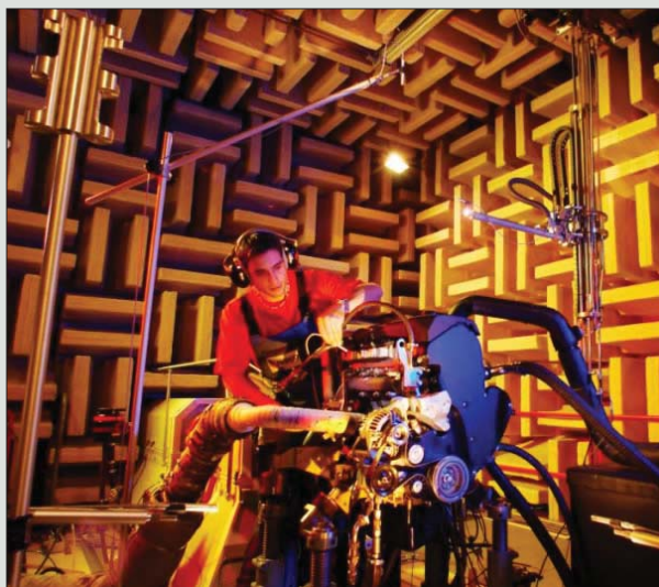
Testy przeprowadzane w komorze dźwiękowej pomagają budować silniki cechujące się wysoką kulturą pracy. Są one nie tylko ciche, ale i oszczędne w eksploatacji
