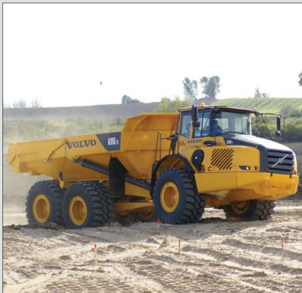
Volvo Maszyny Budowlane Polska przeprowadza testy praktyczne maszyn na budowie drugiego odcinka autostrady A1. Od dwóch miesięcy regularnym próbom poddawane jest tam nowej generacji wozidło przegubowe z zawieszeniem typu FS
