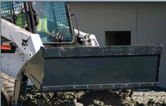
Oferowane przez Bobcat nową generacji łyżki otwierane typu 4w1 przeznaczone są do prac ziemnych, rozbiórkowych i recyklingowych
