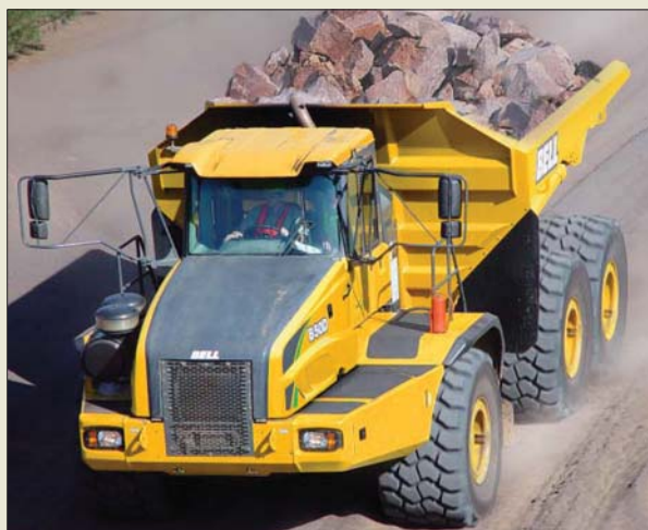
Bell szczytł się rekordem ładowności wozidła przegubowego. Pojazd oznaczony symbolem B50D może przewieźć ładunek o wadze 45,4 ton metrycznych
