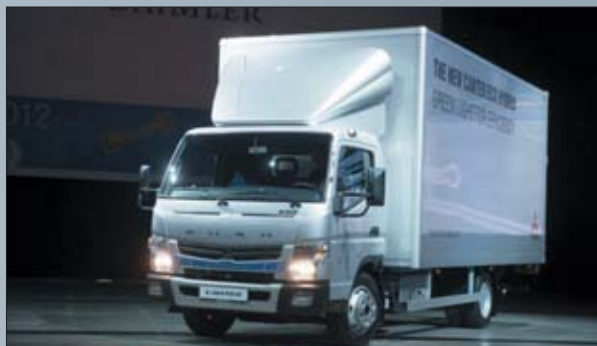
Podstawą koncepcji jazdy nowego Canter Eco Hybrid jest napędzane wyłącznie silnikiem elektrycznym i tym samym bezgłośnie ruszanie. Dopiero po osiągnięciu prędkości 10 km/h dołączany jest silnik dieslowy
