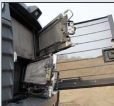
Nowej generacji chłodnica nie zatyka się nawet podczas pracy w dużym zapyleniu
