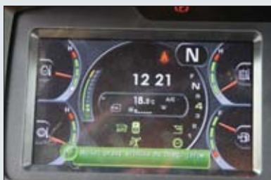
Wskaźnik Eco na monitorze w kabinie „podpowiada” operatorowi właściwe rozwiązania
