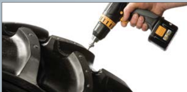
Oferowane przez Solideal Polska kolce do opon dają się łatwo montować i demontować. Wystarczy do tego zwykła wkrętarka
