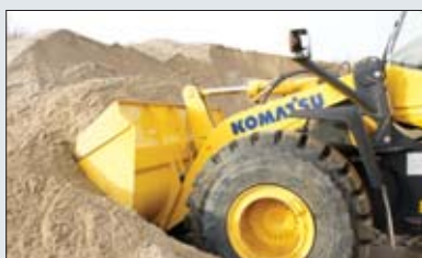
Układ Smart Loader Logic pozwala optymalnie dostosować moment obrotowy do potrzeb
