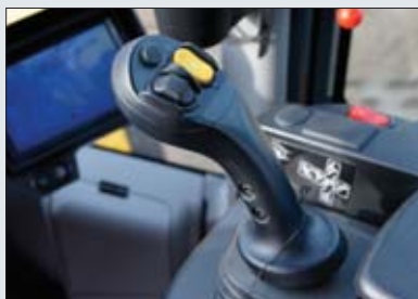
Ergonomiczne dźwostki umożliwiają operatorowi precyzyjne sterowanie maszyną
