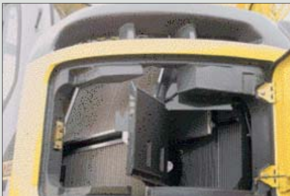
W nowatorskim układzie stosowanym przez New Holland jednostka napędowa i wentylator znajdują się wewnątrz specjalnego kanału
