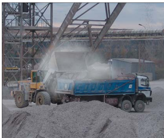
Podczas pracy w środowisku o dużym zapyleniu lub skażonym drzwi i okna kabin muszą pozostawać szczelnie zamknięte
