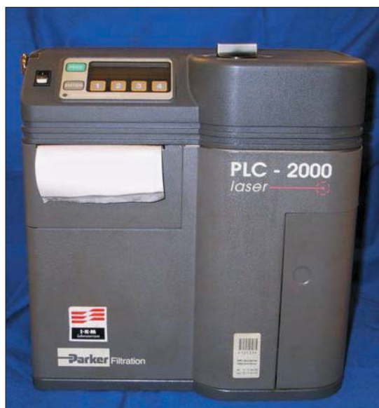
Analizator zanieczyszczeń cieczy hydraulicznych PLC-200 firmy Parker Hannifin oparty jest na technologii laserowej, co gwarantuje precyzyjną i powtarzalność wyników pomiarów
