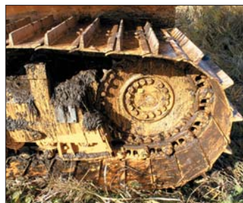
Możliwość doboru odpowiednich gąsienic umożliwia pracę spycharki w trudnym terenie
