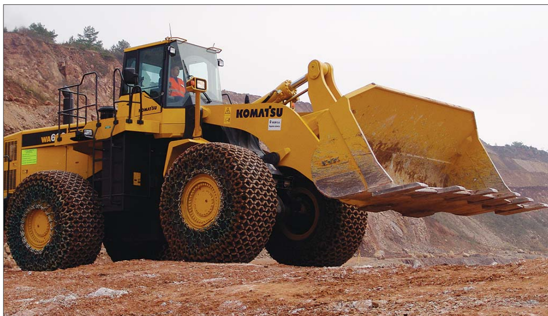
Ładowarka Komatsu WA600-6 należy do największych tego typu maszyn eksploatowanych w naszym kraju. System zębów K VX znacznie podnosi efektywność jej wykorzystania w trudnych warunkach panujących w Kieleckich Kopalniach Surowców Mineralnych
