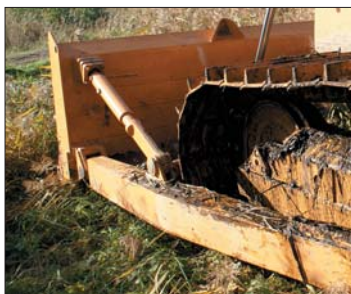
Istotnym parametrem spycharki jest możliwość wielopłaszczyznowej regulacji lemieszka
