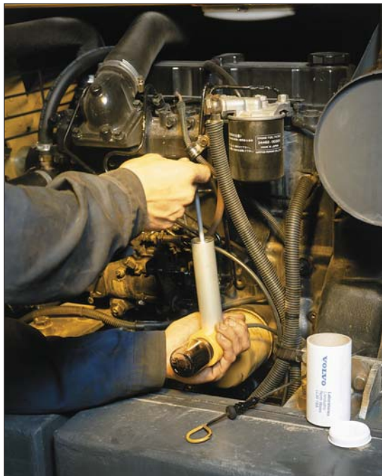
Oferowany przez Volvo proces analiz oleju rozpoczyna się od pobrania próbki z danego układu maszyny. Do tego celu służy specjalny zestaw
