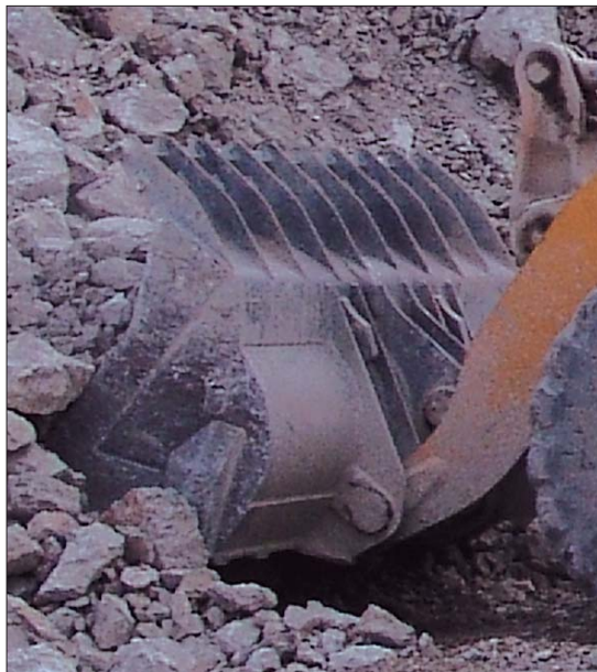
Zęby KVX sprawdzają się w najtrudniejszych warunkach, na przykład w maszynach pracujących w kopalniach surowców skalnych
