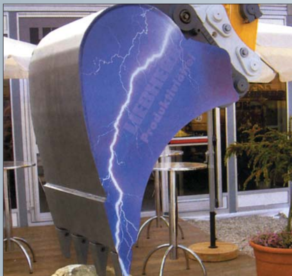
Odpowiednio wyprofilowane boczne krawędzie łyżki nowej generacji pozwalają na znacznie sprawniejsze kopanie rowów oraz nabieranie urobku
