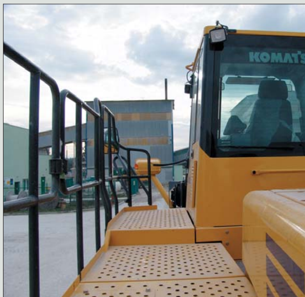
Uchwyt w dachu oraz dodatkowy reflektor oświetlający stopnie ułatwiają operatorowi zajęcie miejsca w kabinie także po zmroku i w warunkach ograniczonej widoczności, na przykład przy złej pogodzie
