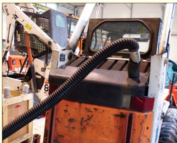
Przy wykonywaniu czynności obsługowych i naprawczych w pomieszczeniach zamkniętych istotne znaczenie ma sprawne i dokładne odprowadzanie spalin
