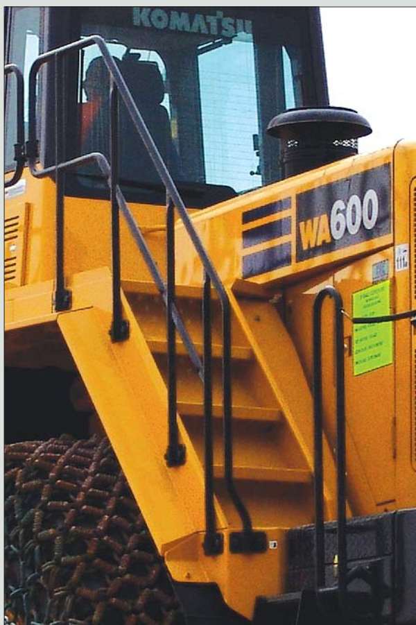
Wejście do kabiny, szczególnie dużych maszyn, jest potencjalnym miejscem wypadków. By ograniczyć ryzyko ich wystąpienia konstruktorzy Komatsu stosują szereg zabezpieczeń ułatwiających operatorowi dotarcie do miejsca pracy
