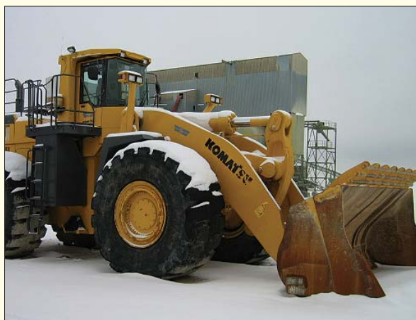
Przy uruchamianiu maszyny w czasie mrozu zabrania się podgrzewać silnik z zewnątrz przy użyciu otwartego ognia, na przykład pochodni
