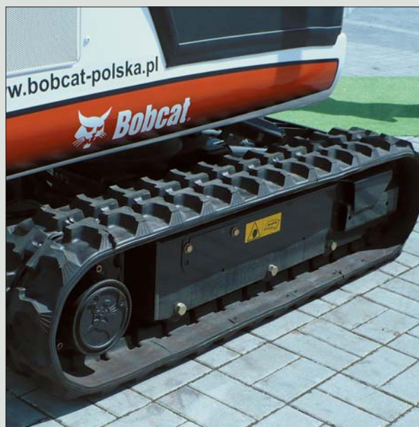
Imponującą wytrzymałością gąsienice Solideal produkowane są w wielu wzorach bieżnika oraz w szerokiej gamie rozmiarowej z myślą o zamontowaniu na maszynach wykorzystywanych do robót wymagających małych nacisków jednostkowych na podłoże
