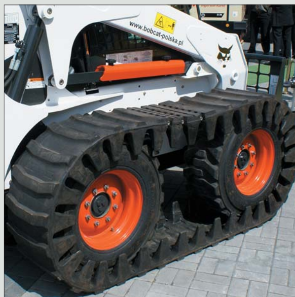
Gąsienice Solideal OTT zaprojektowane zostały z przeznaczeniem do montażu na miniladowarkach kołowych w celu zwiększenia ich mobilności w grząskim, terenie przy jednoczesnym zwiększeniu ładunku lub ciężaru osprzętu
