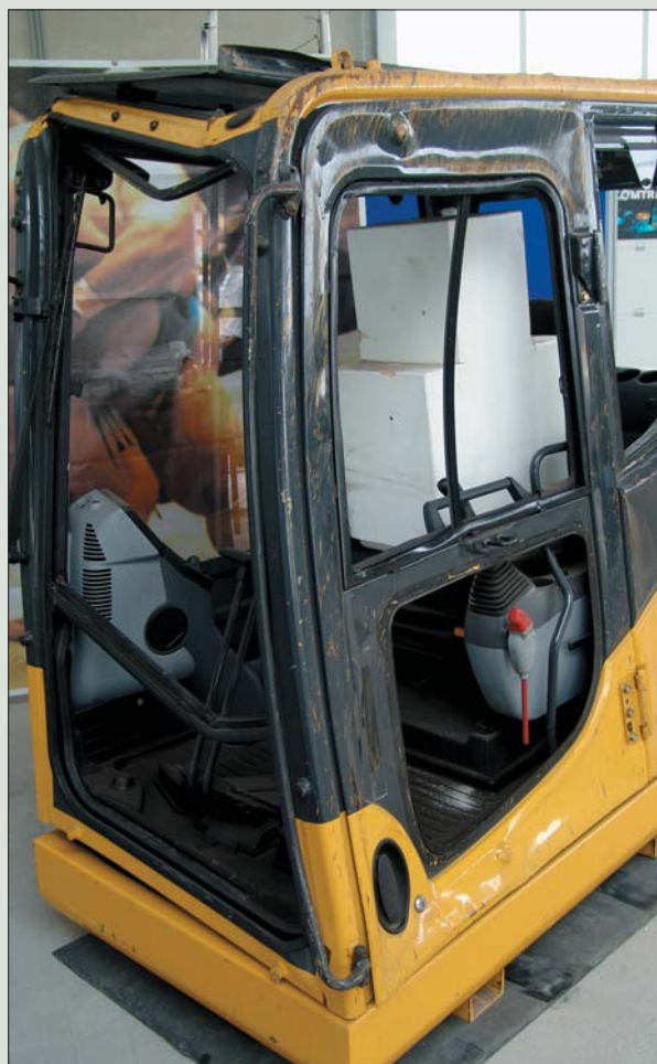
Kabiny stosowane przez Komatsu doskonale chronią operatora. Tak było w tym przypadku. Mimo, że maszyna przewróciła się, konstrukcja kabiny pozostała nienaruszona, a operator wyszedł z opresji bez szwanku
