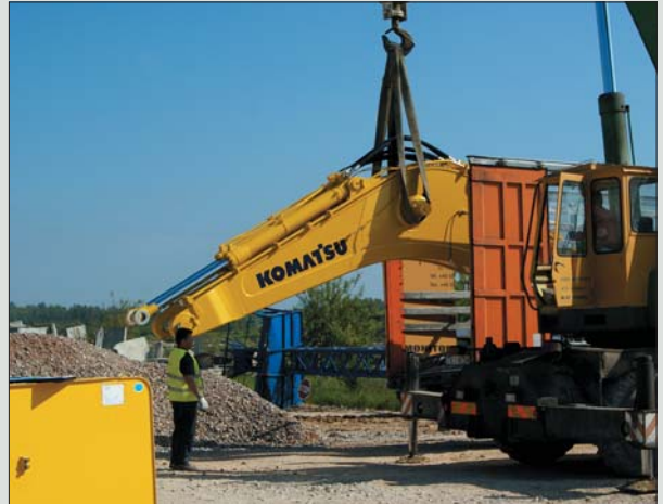
Komatsu PC 800 to naprawdę gigantyczna maszyna. Jej ramię wraz z silownikami waży blisko 5 ton, zaś sam wysięgnik 7,3 tony
