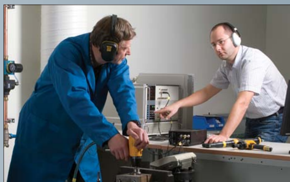
Firma Atlas Copco posiada doskonale wyposażone laboratorium do mierzenia emisji hałasu i drgań narzędzi
