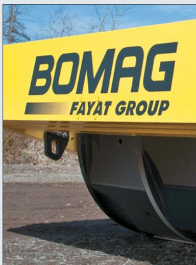
Dzięki odpowiednio dobranemu kształtowi płyt i krawędzi bębna, siły zagęszczania wnikają do podłoża pionowo
