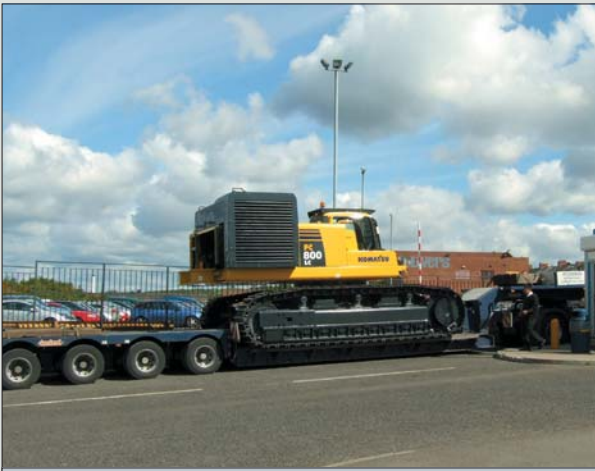
Po pomyślnym przejściu fabrycznych testów koparka została rozmontowana i na trzech zestawach drogowych przetransportowana do Polski
