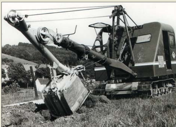
L 051 to najbardziej znana spośród koparek linowych O&K. Maszyna napędzana była silnikiem wysokoprężnym o mocy 28 KM produkowanym we własnych zakładach
