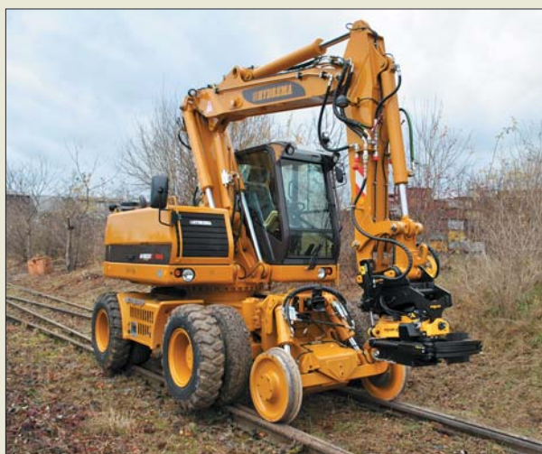
Dzięki kilku technicznym zabiegom maszyny Hydrema mogą zostać wyposażone w wózki kolejowe, co umożliwiła przemieszczanie się po szynach
