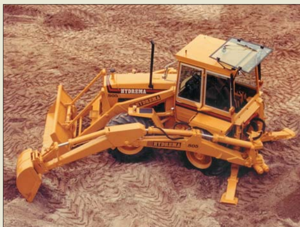
Produkowana od roku 1980 przegubowa koparko-ladowarka Hydrema 805 znacznie przewyższała swym zaawansowaniem technicznym maszyny konkurencji
