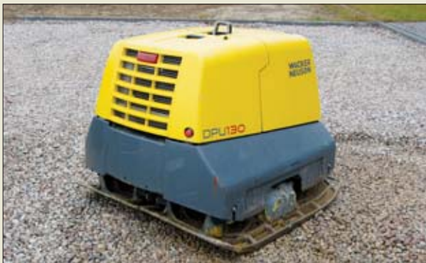
Zagęszczarka Wacker Neuson DPU 130 to jeden z najbardziej innowacyjnych produktów firmy. Może wykonywać zadania typowe dla małego walca
