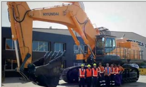
Silnikiem Cummins QSK23-C o mocy 567 kW napędzana jest największa koparka hydrauliczna koreańskiego koncernu – Hyundai R1200-9
