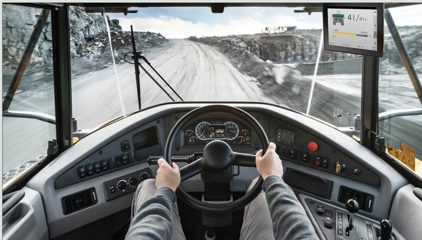
Haul Assist to pierwszy program Volvo CE, który umożliwia bezpośrednią komunikację między maszynami łącząc w sobie aplikacje do ważenia pokładowego, wskazywania pozycji na mapie i kontrolowania prędkości. Optymalizuje w ten sposób ładowność umożliwiając dokładne pozycjonowanie innych maszyn na placu budowy
