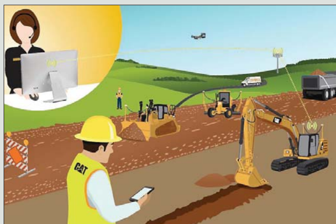
Pakiet Cat Connect umożliwia zdalną diagnostykę sprzętu oraz aktualizację oprogramowania, co ma odczuwalny wpływ na podniesienie efektywności pracy
