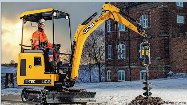
Opcja szybkiego ładowania pozwala także na doładowanie mini-koparki w ciągu 2,5 godziny. Maszyna nie musi być podłączona kablem w czasie pracy.
