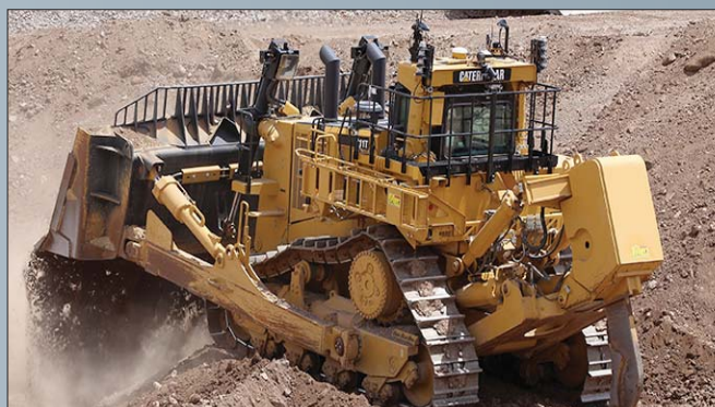
Podniesione koła napędowe zwiększają wydajność i upraszczają konserwację, powodują, że elementy układu napędowego znajdują się poza środowiskiem pracy
