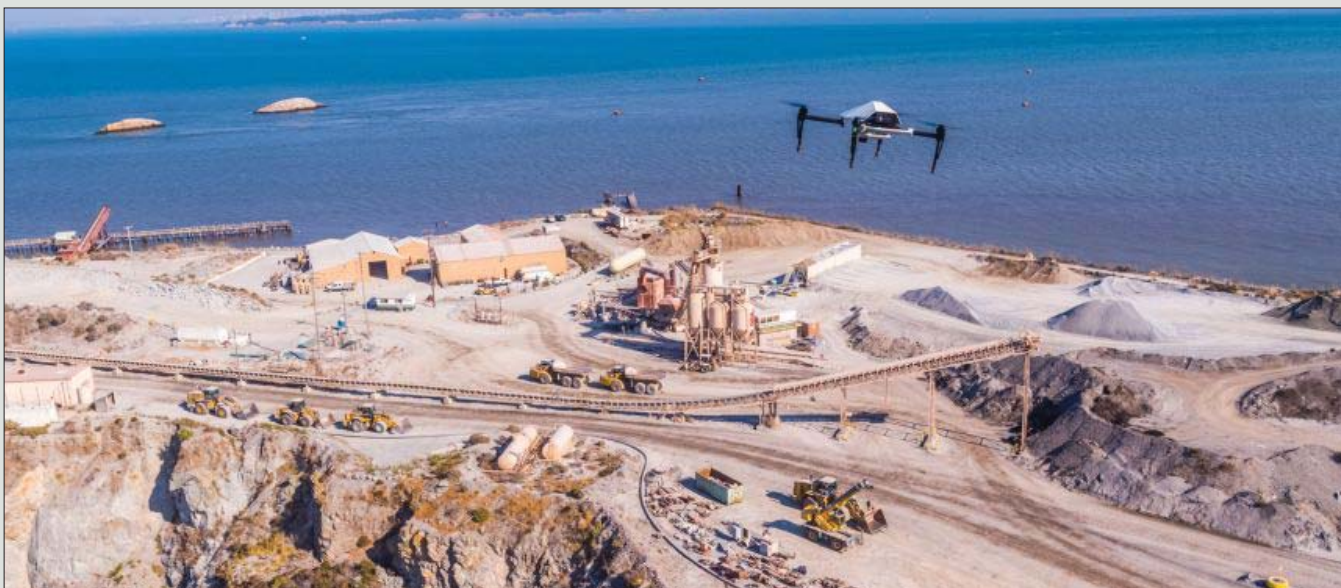
Stosowanie bezałogowych statków powietrznych w porównaniu z tradycyjnymi metodami zbierania danych daje ogromną przewagę. Podczas gdy zespół inżynierów-geodetów pracujący bezpośrednio w terenie był w stanie zgromadzić dane z kilkudziesięciu miejsc, dron podczas piętnastominutowego lotu zebrał miliony informacji
