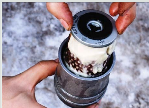
Zwykły olej napędowy może sprawić w zimie kłopoty, szczególnie podczas silnych mrozów. Dzieje się tak na skutek wytrącania się kryształów parafiny
