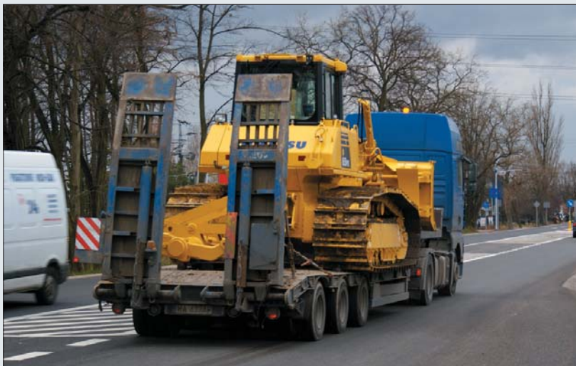
W nowej spycharce Komatsu D65PX-16 zastosowano składany lemiesz prowadzony wewnątrz gąsienic. Rozwiązanie to zdecydowanie ułatwia transport maszyny
