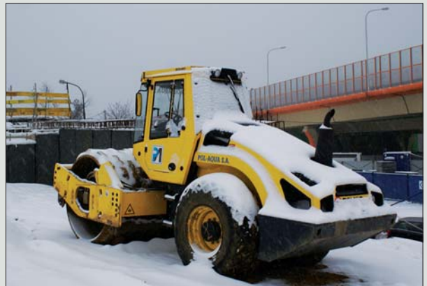
Walce drogowy, których integralne części stanowią zbiorniki z wodą najlepiej przechowywać w ogrzewanych pomieszczeniach
