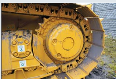
Od początku roku 2009 w spycharkach Komatsu standardowo montowane jest podwozie Plus
