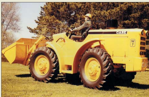
W końcu lat pięćdziesiątych ubiegłego stulecia Case rozpoczął produkcję ładowarek kołowych. Model W 7 wyposażony był w tyżkę o pojemności 0,76 m 3
