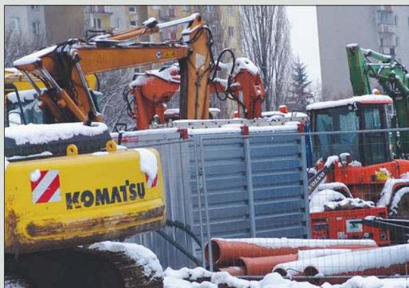
Brak odpowiedniego przygotowania maszyn do eksploatacji w warunkach zimowych utrudni lub wręcz uniemożliwia pracę na placu budowy
