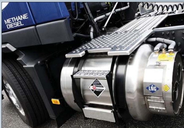
Pojazdy testowe wyposażone zostały w specjalne zbiorniki na skroplony metan. Gaz w stanie ciekłym okazał się być optymalnym paliwem...
