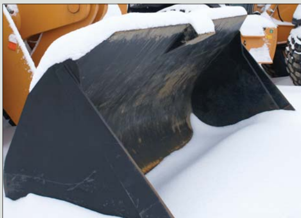
Zimą w maszynach do robót ziemnych szczególnie narażone na zniszczenie bywają zęby i krawędzie tnące tyłek
