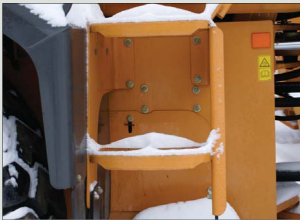
Zimą operatorzy mają utrudniony dostęp do swych maszyn. W trosce własnej bezpieczeństwa winni dbać o usunięcie śniegu ze schodków i poręczy
