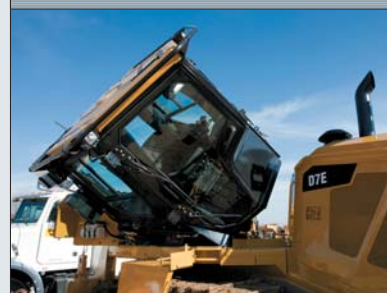
Odchylana kabina ułatwia pracę mechaników dając lepszy dostęp do niewrażliwych podzespołów maszyny
