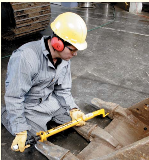
Zestaw narzędzi Slide Sledge składa się z młota oraz szerokiej gamy końcówek służących między innymi do wybicia tulei, wybijania sworzni oraz do demontażu i ponownego montażu zabezpieczeń zębów łyżek
