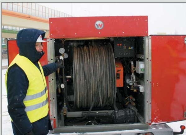
Długość przewodów, w których przez cały czas działania podgrzewacza krąży specjalna mieszanka wody i glikolu, wynosi siedemset metrów. Po skończonej pracy przewody można łatwo nawinąć na bęben przy pomocy elektrycznej nawijarki
