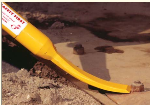
Narzędzia Slide Sledge błyskawicznie zdobywają sobie uznanie polskich użytkowników rewolucjonizując pracę warsztatów serwisowych. Na zdjęciu przecinanie zapieczonej śruby
