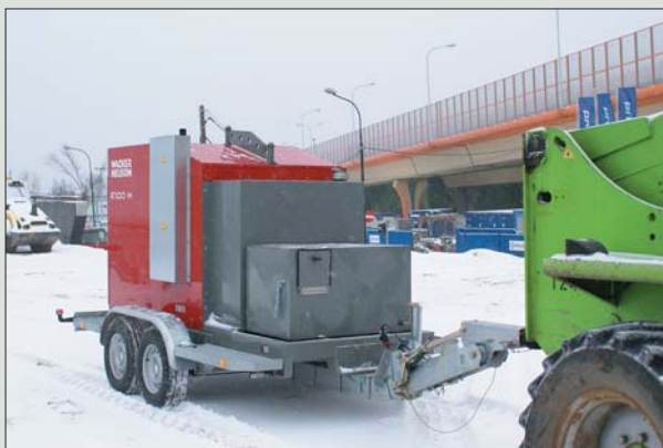
Podgrzewacz nawierzchni Wacker Neuson E700M zabudowano na przyczepie, co znacznie zwiększa jego mobilność ułatwiając przemieszczanie pomiędzy kolejnymi polaciami terenu przeznaczonymi do rozmrożenia
