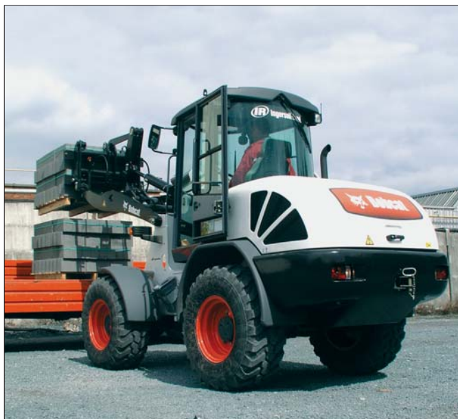
Podstawową różnicą w stosunku do ładowarek konkurencji ma być możliwość montażu szeregu przystawek używanych do tej pory w kompaktowych miniladowarkach
