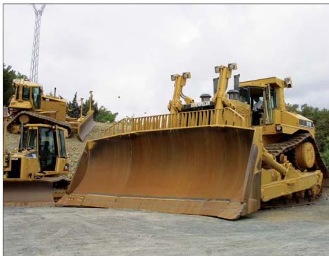
Uznany producent spycharek gąsienicowych pozostaje od lat Caterpillar. Aktualna oferta firmy jest bardzo szeroka – od małych, 3-tonowych maszyn po widniejący na zdjęciu model D11R napędzany silnikiem o mocy 634 kW i ważyący 99 ton
