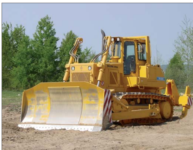
Jedynym producentem spycharek gąsienicowych w Polsce - i jednym z nielicznych w Europie - pozostaje HSW. Rodzina maszyn wytwarzanych w Stalowej Woli obejmuje osiem modeli o mocy silnika od 55 do 388 kW i wadze od 7 do 61 ton
