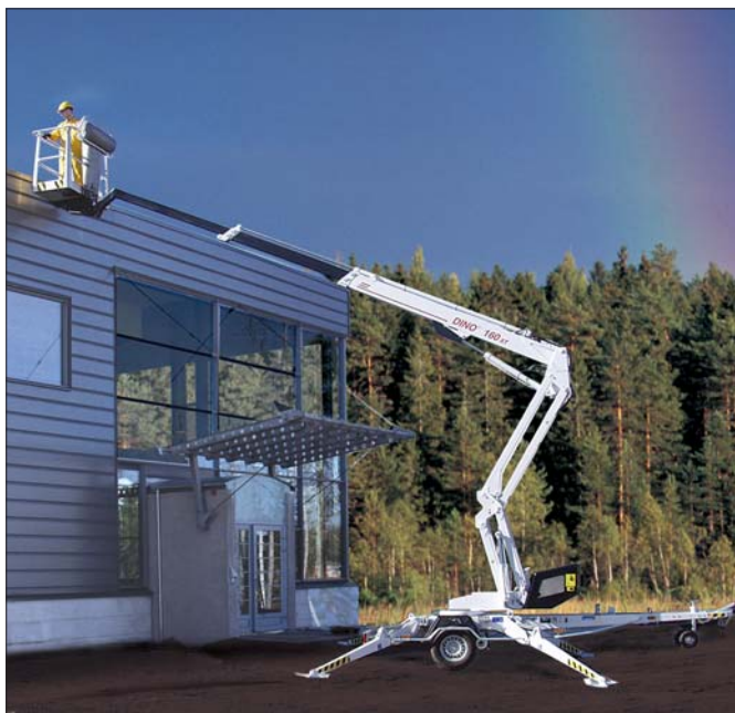
Z kosza dotrzeć można do miejsca pracy z każdego kierunku. Sprawdzona już w platformach Dino XT kombinacja wysięgnika teleskopowego i nożycowego pozwala wykonać pracę ponad przeszkodami
