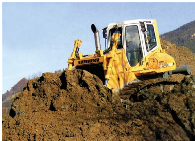
Liebherr produkuje spycharki o masie od 6,5 do 21 ton. Dwie z nich wytwarzane są na zlecenie koncernu John Deere. Wszystkie maszyny posiadają napęd hydrostatyczny
