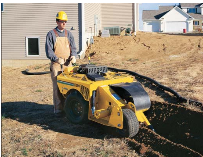
Prowadzone ręcznie koparki łańcuchowe przeznaczone są dla firm budowlanych, melioracyjnych i tworzących infrastrukturę telekomunikacyjną
