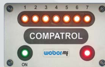
Stop – podłoże zagęszczone
