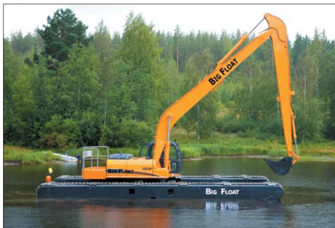
Jednostka robocza typu Big Float jest standardową dwudziestojednotonową koparką gąsienicową wyposażoną w dwa pontony z biegnącymi wokół nich gąsienicami
