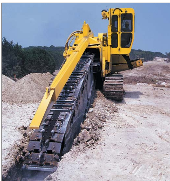
Największe z koparek łańcuchowych Vermeer są posadowione na podwoziu gąsienicowym
