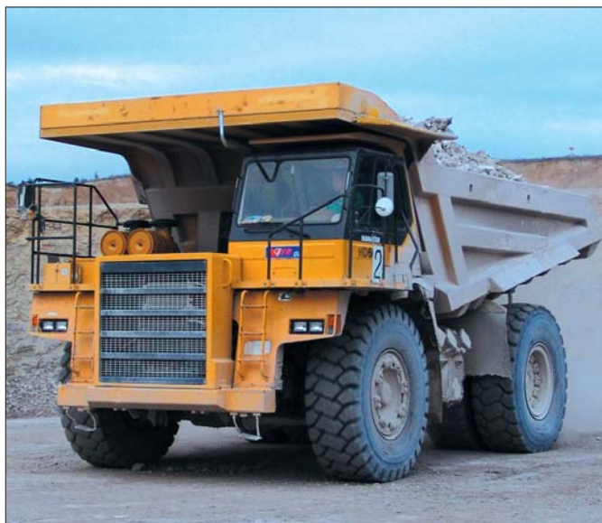
Wozidła sztywnoramowe Komatsu są podstawowym środkiem transportu urobku w kopalni wapienia Barcin-Piechcin-Pakość na Kujawach
