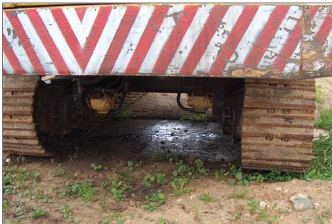
Wycieki płynów eksploatacyjnych także stanowią zagrożenie dla środowiska naturalnego i zdrowia pracowników obsługujących maszyny...
