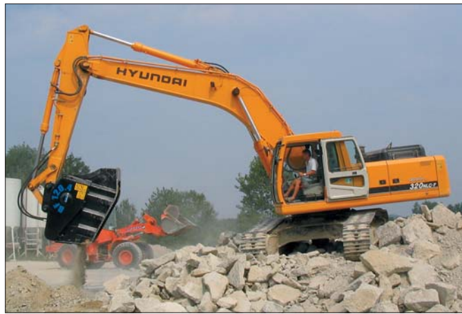
Czerpak BEFRA to w praktyce kruszarka szczękowa zawieszona na ramieniu koparki
