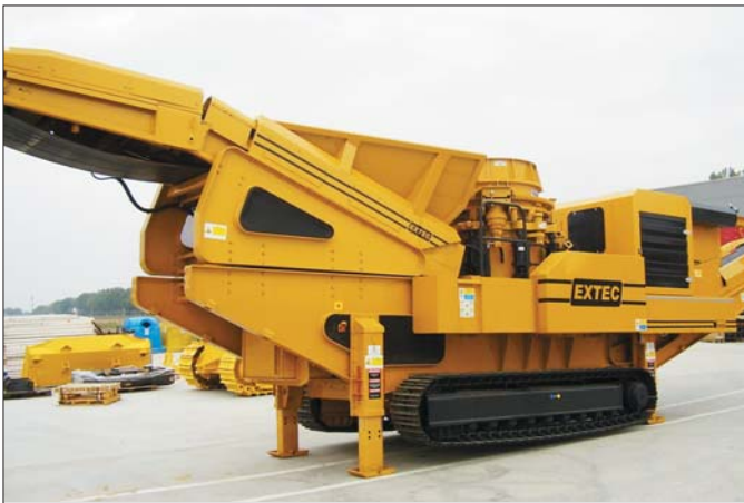
Kruszarnia stożkowa Extec X44SBS znajduje zastosowanie w kopalniach surowców skalnych
