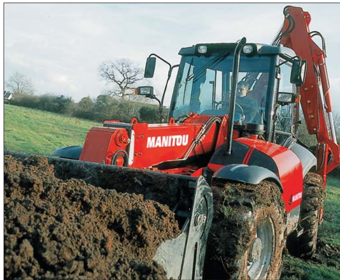
Francuski producent określa maszynę MANIHOE mianem „ładowarki teleskopowej wyposażonej w ramię koparkowe”
