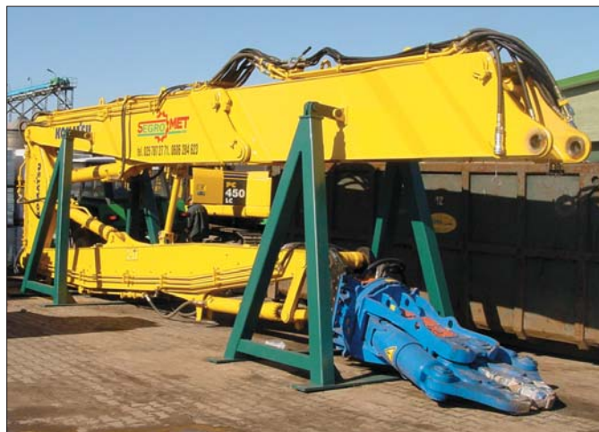
Możliwość szybkiej wymiany wysięgnika ma fundamentalne znaczenie dla podniesienia efektywności koparki. Nie jest prawdą, że zamiana trwać musi wiele godzin i wymagać pracy wielu ludzi
