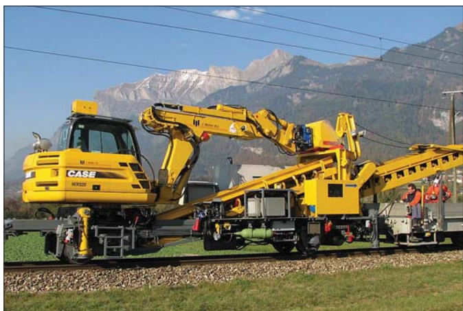
Nadwozie koparki kołowej Case WX125 posadowiono na platformie wagonu
