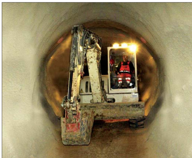
Terex TC75 z zerowym obrotem doskonale radził sobie w niezwykle ciasnej przestrzeni drążonego tunelu
