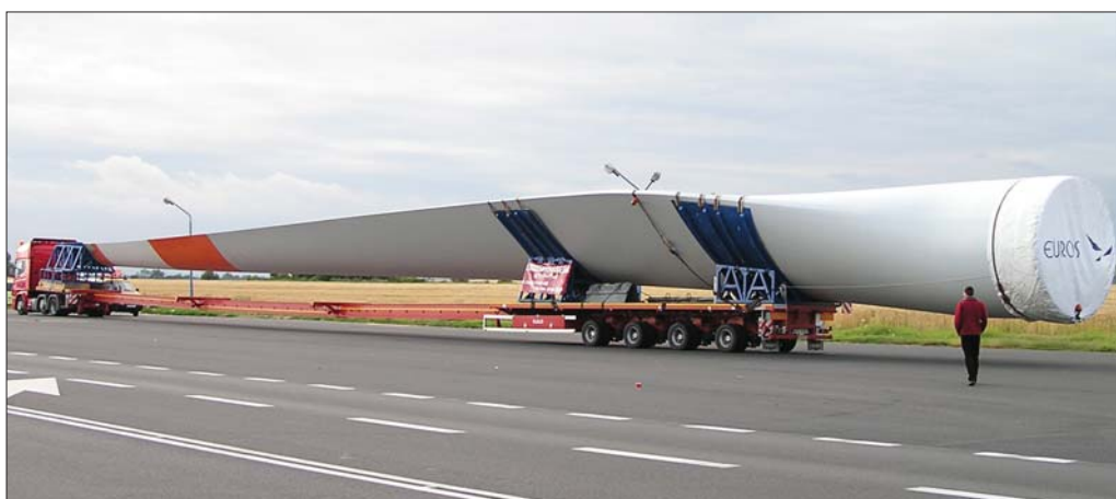
Transport elementów o tak olbrzymich gabarytach, jakimi cechują się łopaty wiatraka odbywa się najczęściej na rozciąganych tele-naczepach lub semi-niskopodłogowych naczepach rozciąganych
