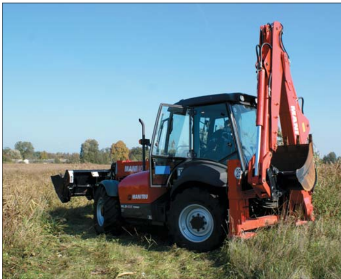
Umieszczone z tyłu ramię koparkowe spełnia jednocześnie rolę przeciwwagi
