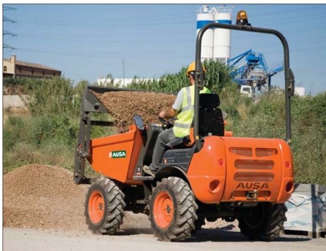
Miniwozidła to bardzo praktyczne pojazdy. Nie tylko przewożą materiał, ale potrafią same się załadować i wysypać materiał do wysokiego kontenera lub na ciężarówkę...
