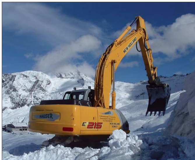
Koparka New Holland E215 pracująca na austriackim lodowcu Hintertux spusuje się doskonale nawet w ekstremalnie niskich temperaturach
