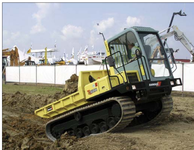
Ammann Yanmar produkuje także wozidła sztywnoramowe z napędem gąsienicowym i w pełni funkcjonalną kabiną. Poszerza to zdecydowanie zakres ich eksploatacji
