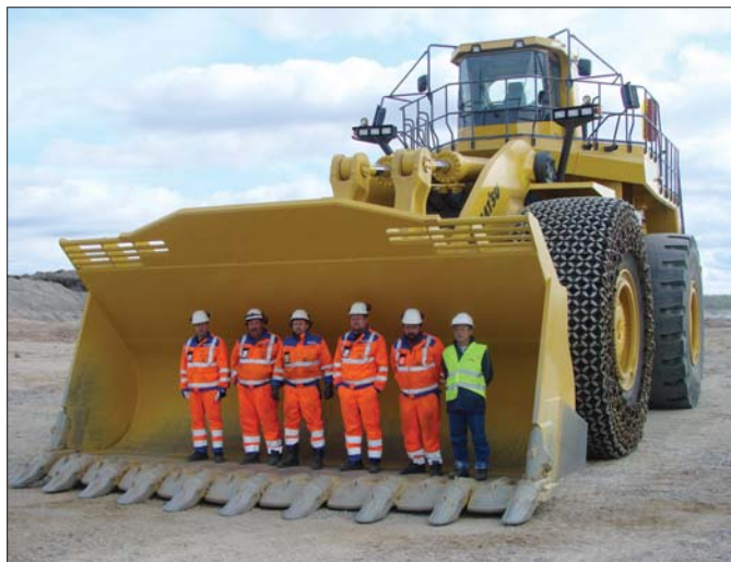
Łyżka ładowarki WA1200-3 może mieć pojemność nawet 35 m 3
