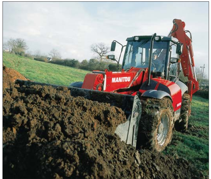
Francuski producent określa maszynę MANIHOE mianem „ładowarki teleskopowej wyposażonej w ramię koparkowe”
