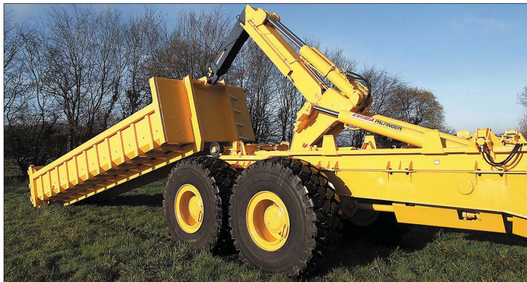
Dzięki regulowanemu na wysokość hakowi pojazd może podejmować również kontenery różnych norm o długości od pięciu do siedmiu metrów
