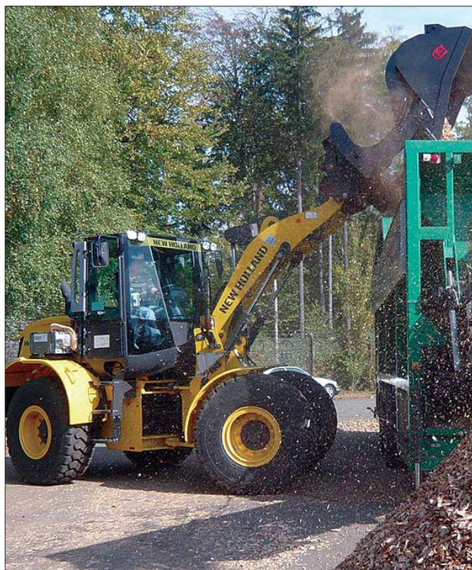
Nowa ładowarka kołowa New Holland W110B dzięki zastosowaniu układu chłodzenia A.C.S. doskonale spisuje się podczas prac w zapyłonym środowisku
