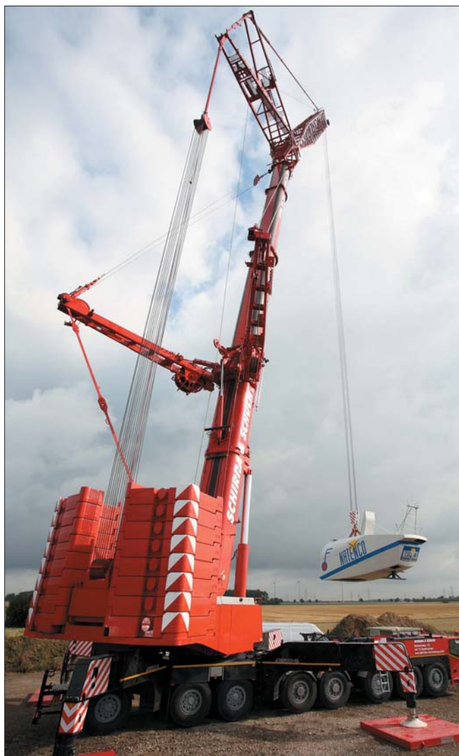
Choć firma Schuch miała w posiadaniu 126 żurawi samojezdnych, do montażu elektrowni wiatrowych musiały zakupić model Terex AC 500-2
