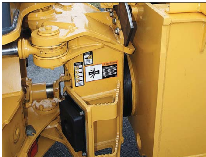
Bezpieczeństwo pracy podnosi możliwość hydraulicznej blokady przegubu wozidla podczas zmiany skrzyni ładunkowej lub opróżniania zawartości kontenera
