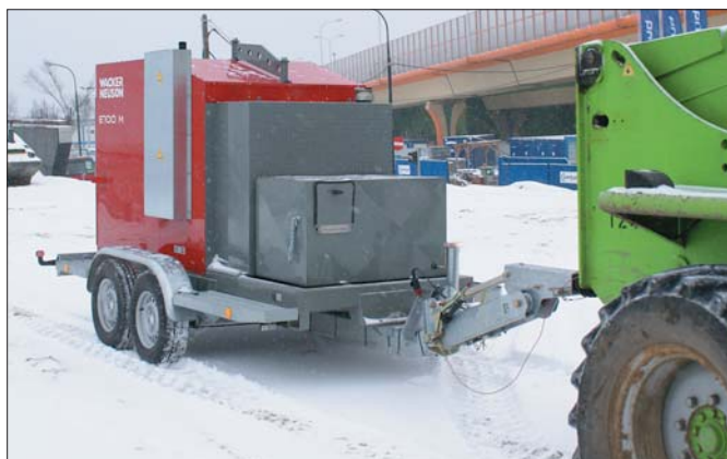
Podgrzewacz Wacker Neuson zabudowano na przyczepie, co znacznie ułatwia jego transport
