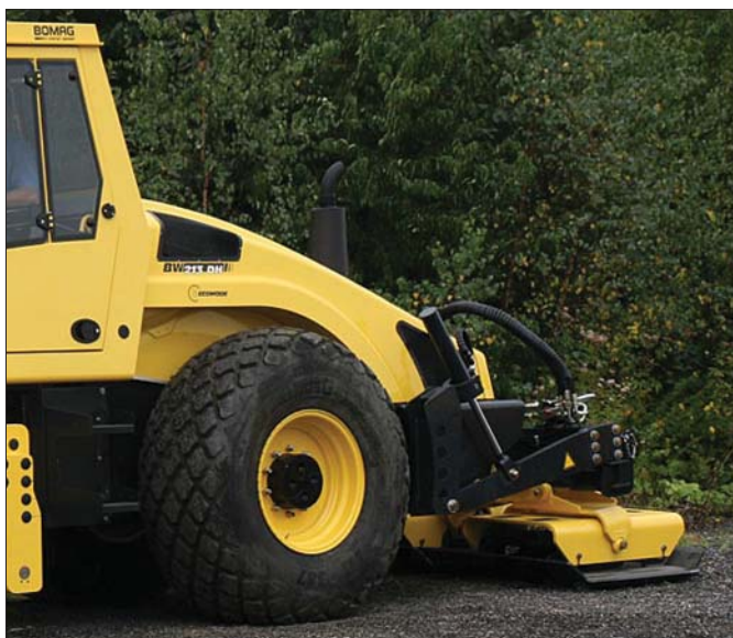
W zależności od rodzaju zagęszczanego podłoża do walca zastosować można dodatkowy osprzęt, na przykład montowane z tyłu płyty zagęszczające
