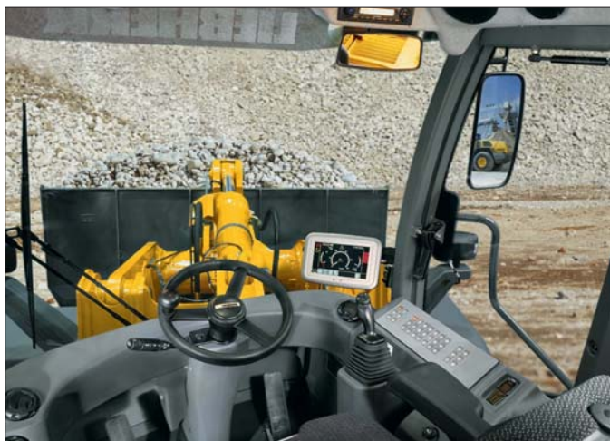
Ładowarki Liebherr „szóstej generacji” wyposażono w komfortową kabinę. W porównaniu z poprzednimi modelami jej przestrzeń użytkowa wzrosła o blisko trzydzieści procent
