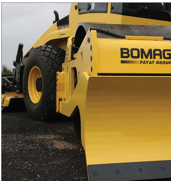
Lemiesz czołowy zamontowany przed bębnem walca pozwala na niwelowanie i profilowanie nawierzchni przeznaczonej do zagęszczania
