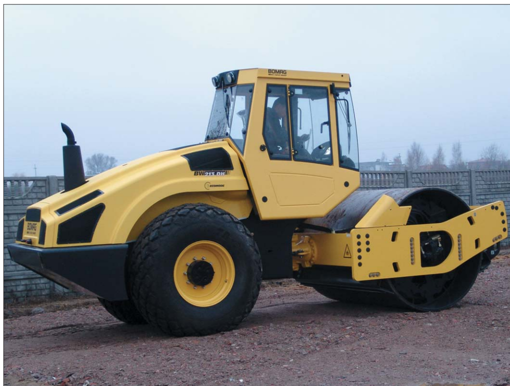
BOMAG walec BW 213 DH-4 BVC doskonale sprawdza się przy zagęszczaniu podczas prac ziemnych i w budownictwie drogowym. Dodatkowy osprzęt, jak na przykład lemiesz czołowy oraz płyty wibracyjne znacznie zwiększają możliwości zastosowań maszyny
