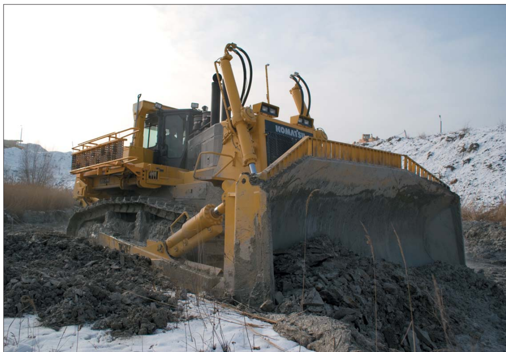
Głównym zadaniem spycharki D475A jest mechaniczne urabianie margla kredowego niezbędnego do produkcji w Cementowni Górażdże.
