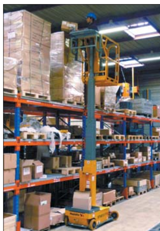
Star 6 Picking przeznaczony jest do prac wewnątrz na wysokości do sześciu metrów
