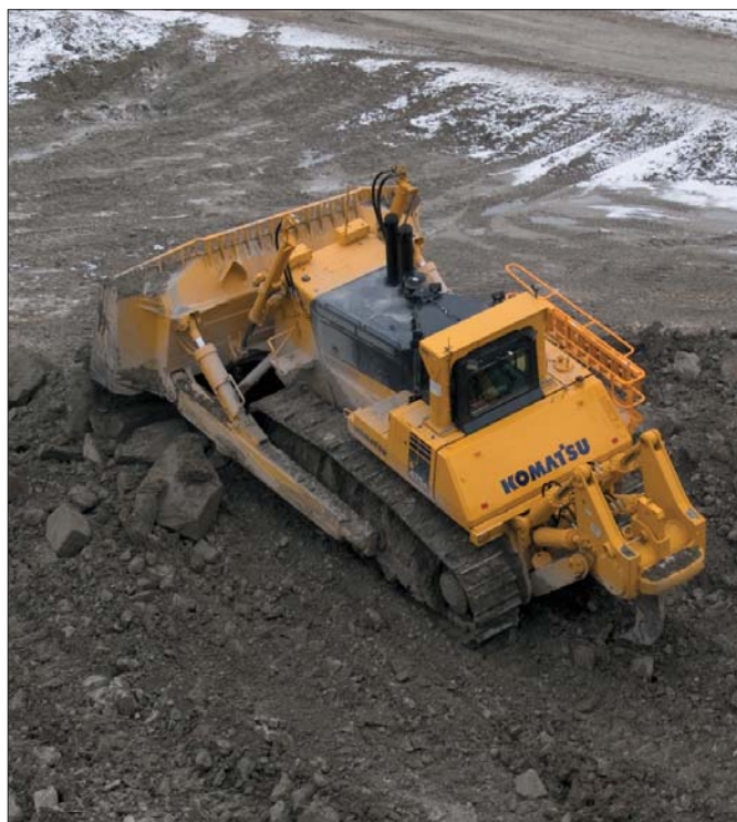
Lemiesz typu „Semi-U” przeznaczony jest do pracy w najcięższych warunkach. Specjalna konstrukcja zrywaka zapewnia dużą siłę urabiania materiału skalnego
