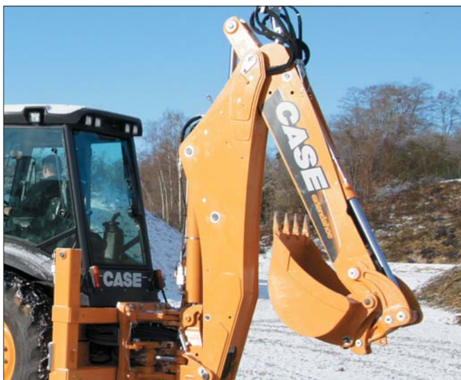
Wysięgnik sekcji koparkowej cechuje się zwartą budową. Dzięki temu po jego całkowitym złożeniu maszyna ma wysokość transportową poniżej 3,60 metra
