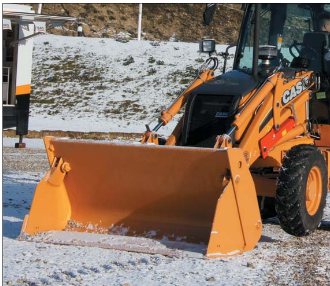
Wszystkie modele Serii T należą do najmocniejszych maszyn w swej klasie. Dlatego można je było wyposażać w łyżkę ładownicową o większej pojemności
