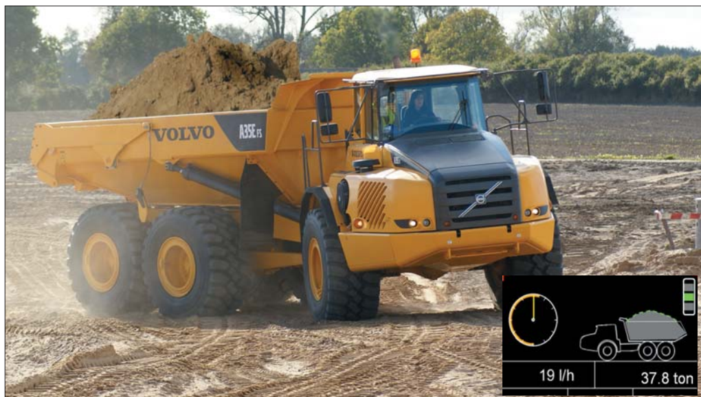
W sposób w pełni automatyczny system OBW (On Board Weighing System) zapisuje wagę załadowanego urobku. Dane są na bieżąco wyświetlane są na ekranie w kabinie wozidła
