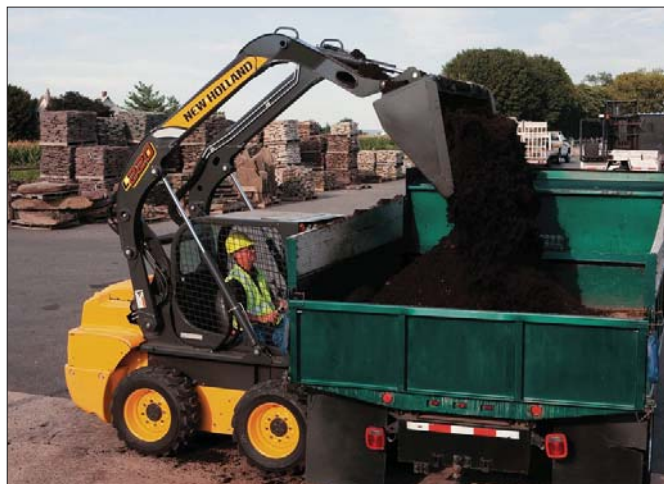
Najlepsze w tej klasie maszyn wysokość i zasięg wysypu sprawiają, że operator może bardzo sprawnie wysypać materiał na środek skrzyni ładunkowej ciężarówki
