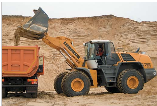
Dzięki bezstopniowej regulacji napędu, w zależności od warunków, w jakich pracuje ładowarka, zużycie opon może być mniejsze nawet o dwadzieścia pięć procent
