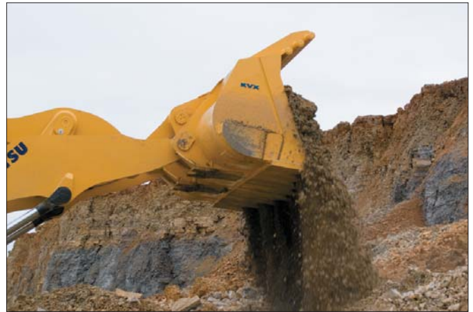
Maszynę wyposażono w specjalną łyżkę K VX o pojemności 6,5 m 3 . W miejsce pojedynczych zębów zastosowano w niej superwąską listwę tnącą
