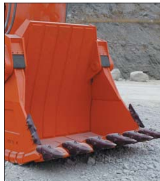
Tona dostarczyła koparkę z 8-tonową łyżką o pojemności 4.8 m 3
