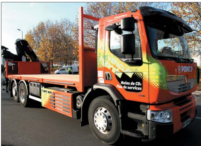
Renault Premium Hybris Tech - największy europejski pojazd skrzyniowy z innowacyjnym napędem hybrydowym
