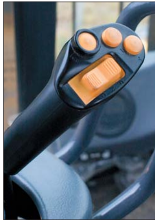
Operator ładowarki Komatsu WA600-6 steruje jazdą przy pomocy dżojsztiki
