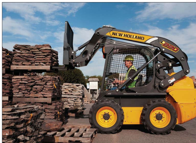
Hydrauliczna funkcja samopoziomowania zapewnia idealnie równoległy ruch wysięgnika, tak nieodzowny na przykład podczas pracy z wykorzystaniem widel.
