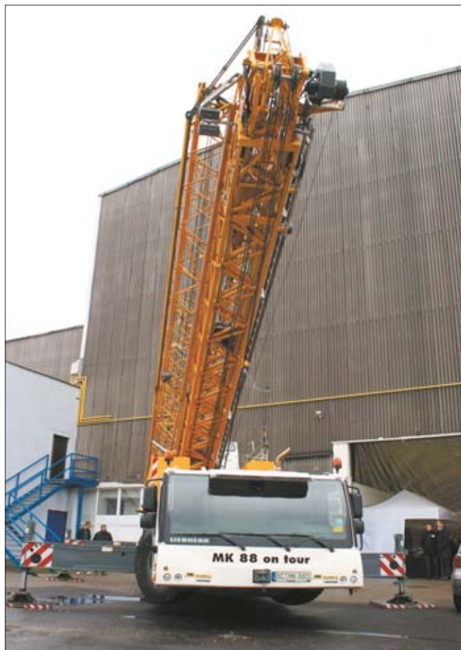
Żuraw Liebherr MK88 łączy mobilność szybkiego żurawia jezdnego oraz różnorodność zastosowań typową dla żurawia wieżowego
