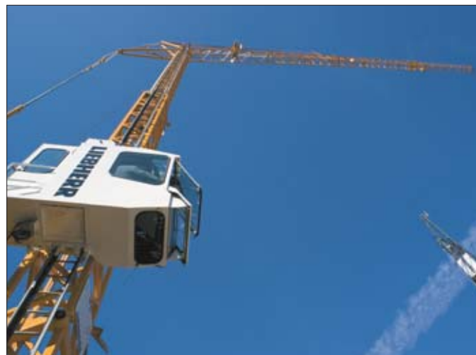
Samojezdny żuraw MK88 jest łatwy w przygotowaniu do pracy. Jednemu pracownikowi czynność ta pochłania zaledwie około jedenastu minut
