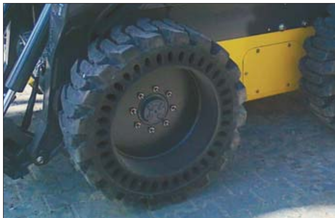
Ładowarkę kołową L223 wyposażono w przemysłowe opony niepneumatyczne
