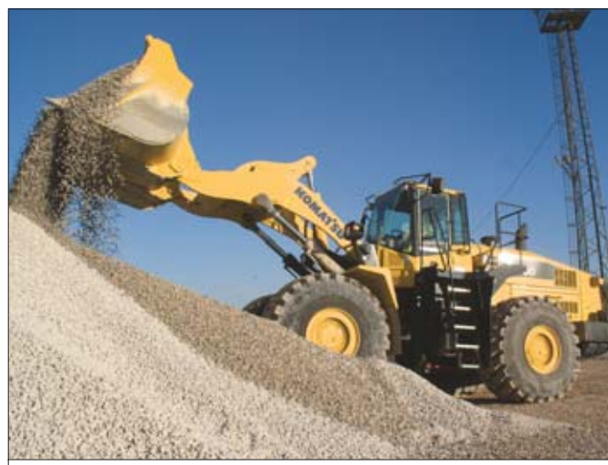
Konstruktorzy WA500-7 pracowali przede wszystkim nad układem napędowym maszyny. Wynikało to z konieczności dostosowania go do obowiązujących norm emisyjnych...
