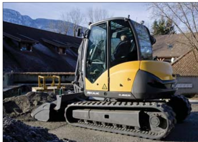
Kabiny koparek MCR posiadające certyfikat FOPS ROPS imponują przestrznością, zapewniają dobre doświetlenie i doskonałą widoczność
