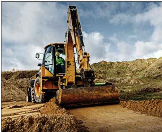
Wysięgnik o kształcie typowym dla koparek doskonale sprawdza się podczas pracy. Maszyna może kopać na głębokość wynoszącą nawet 4.306 mm
