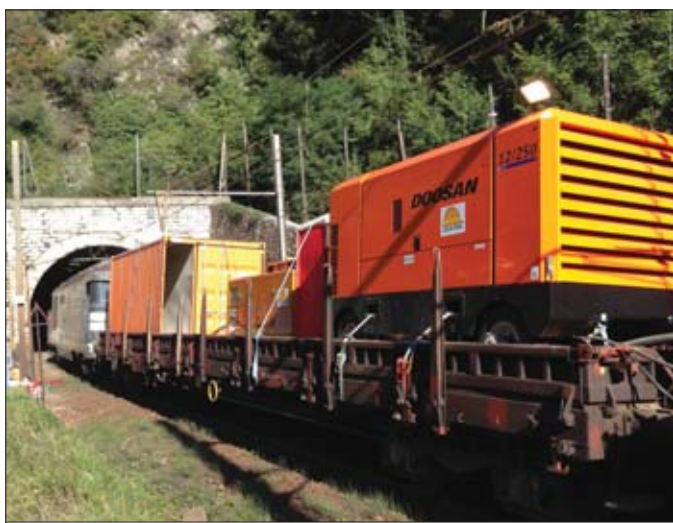
Zaletą sprężarki Doosan 12/250 są kompaktowe gabaryty umożliwiające zamontowanie jej na wąskiej ramie nośnej wagonu i zajęcie tylko jednego toru
