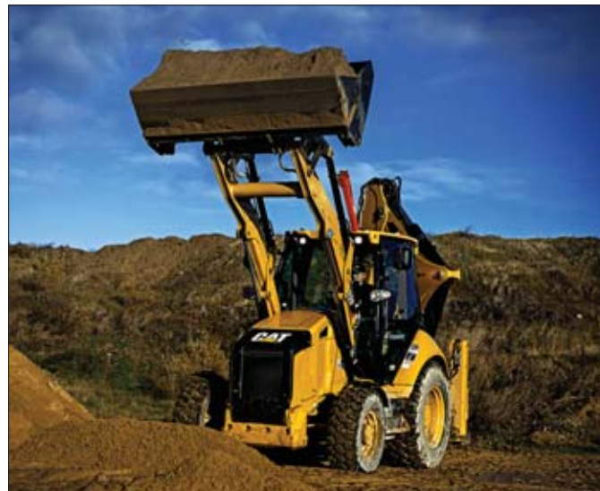
Zmiany konstrukcyjne wysięgnika sekcji ładowarkowej pozwoliły na zwiększenie udźwigu maszyny aż o piętnaście procent
