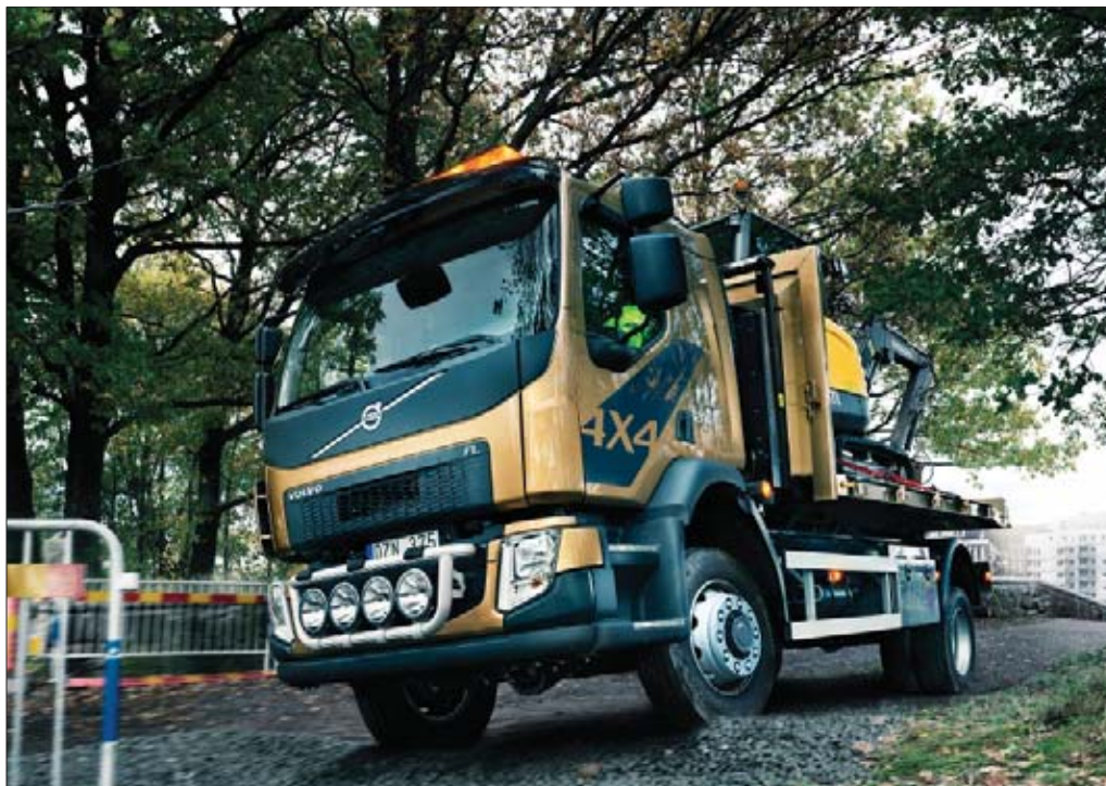
Platforma zamontowana na podwoziu FL 4x4 umożliwia użytkownikowi pojazd wygodne dostarczenie i odbiór maszyn budowlanych bezpośrednio z miejsca ich eksploatacji
