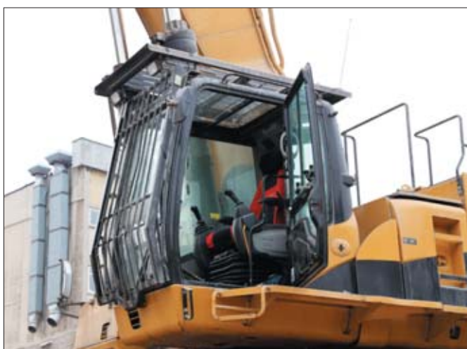
Przeszkolony dach maszyny Cat 385 UHD jest ostonięty solidną kratą, bo odłamki spadające z wysokości ponad 40 m są dużym zagrożeniem dla operatora
