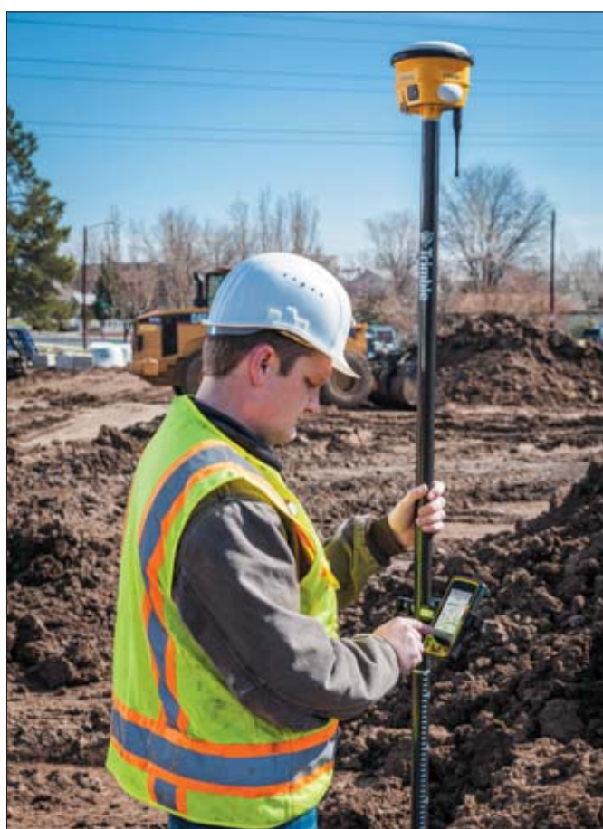
Ultrawtrzymały odbiornik ruchomy SPS985L GNSS Smart Antenna został zaprojektowany tak, aby sprostać ciężkim warunkom panującym na budowie
