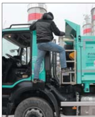
Stopień na błotniku oraz poręcz dachowa umożliwiają przejście na zabudowę bez konieczności rozkładania zamontowanej przy skrzyni drabinki
