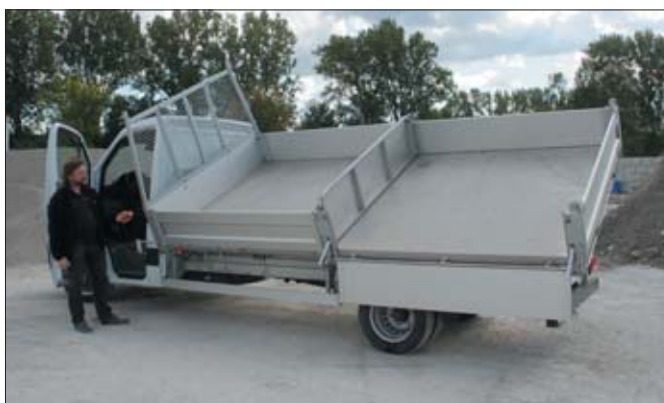
Dodatkowa burta umożliwia łatwe podzielenie przestrzeni ładunkowej, co w istotny sposób zwiększa uniwersalność pojazdu
