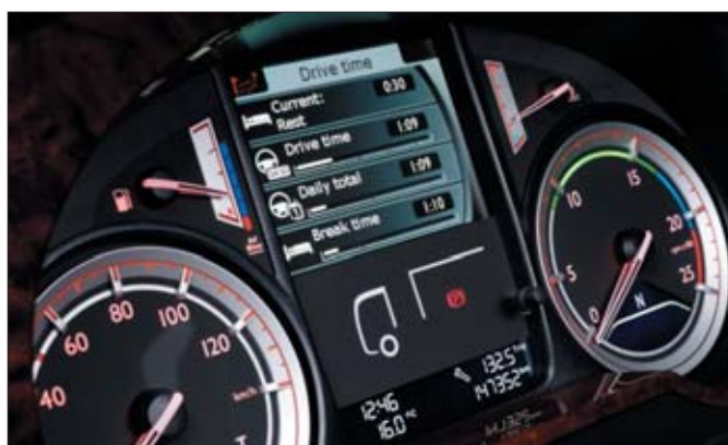
System Driver Performance Assistant wyświetla teraz informacje z tachografu i w przejrzysty sposób informuje kierowcę o czasie pozostałym do końca pracy czy długości koniecznego odpoczynku
