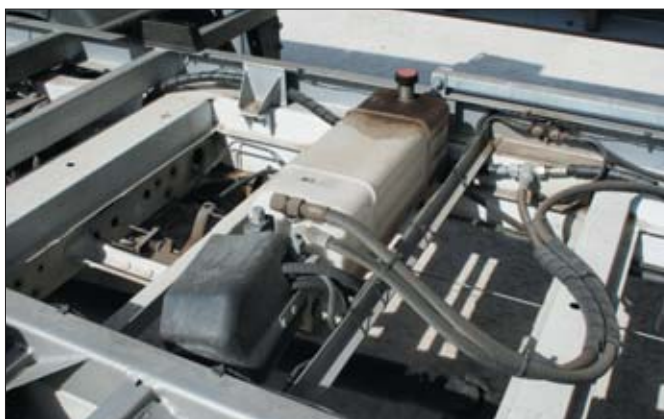
Podnoszenie skrzyni odbywa się za pomocą tzw. power packa, czyli pompy hydraulicznej napędzanej niewielkim silnikiem elektrycznym
