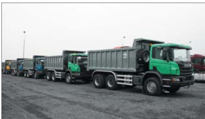
Wszystkie zabudowy mają prostopadłościenny kształt i posiadają pojemność równą szesnastu metrom sześciennym
