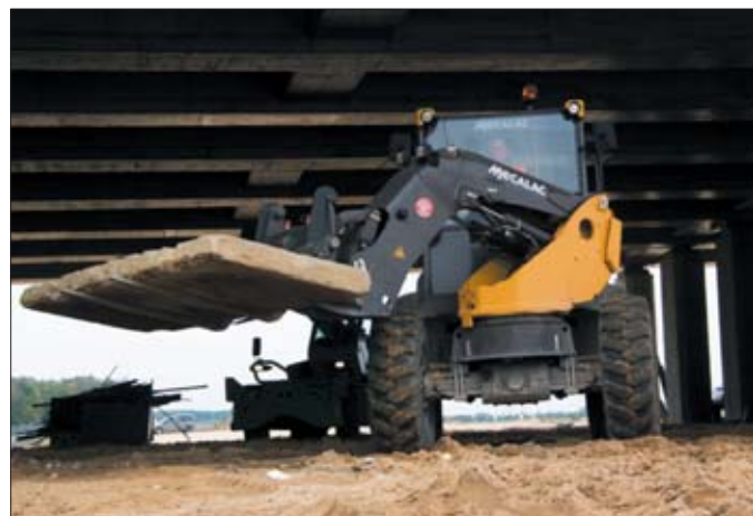
Ładowarki obrotowe Mecalac cechuje wielofunkcyjność. Dzięki niej można nie tylko ograniczyć liczbę maszyn na placu budowy, ale także ilość manewrów maszyny koniecznych do wykonania konkretnego zadania
