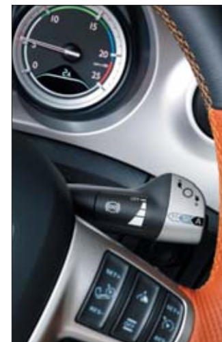
Nowy hamulec MX Engine Brake zapewnia większą skuteczność i ma trzy zakresy działania uruchamiane dźwignią przy kierownicy
