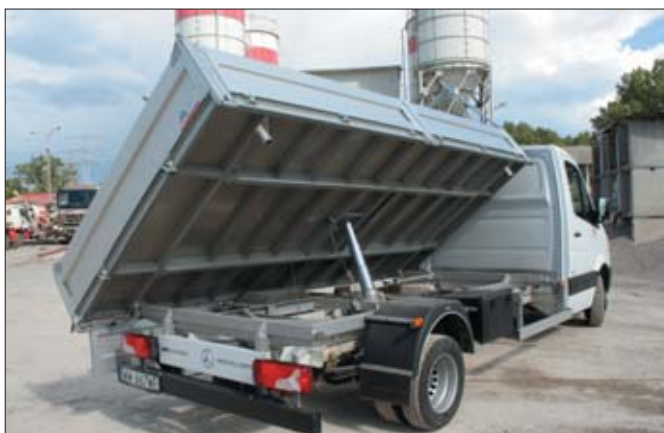
Gęsto rozmieszczone wzmocnienia podłogi zapewniają wysoką sztywność i trwałość zabudowy w różnych zastosowaniach
