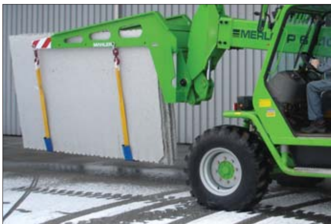
Merlo wprowadza coraz szerszą gamę osprzętu roboczego. Prezentowane narzędzie pozwala na wygodny i bezpieczny załadunek kamiennych płyt przez tylne drzwi naczepy, a tym samym również do kontenera
