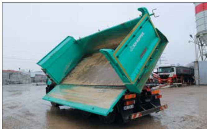
Lewa burta otwierana hydraulicznie powoli staje się standardem. W najnowszym wykonaniu firmy KH-Kipper jest otwierana całkowicie do pionu
