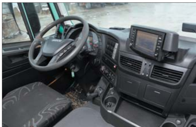
Nowa tablica rozdzielcza Trakera wygląda bardzo estetycznie i zyskała na funkcjonalności. Wyświetlacz systemu Iveconnect można obrócić w stronę kierowcy
