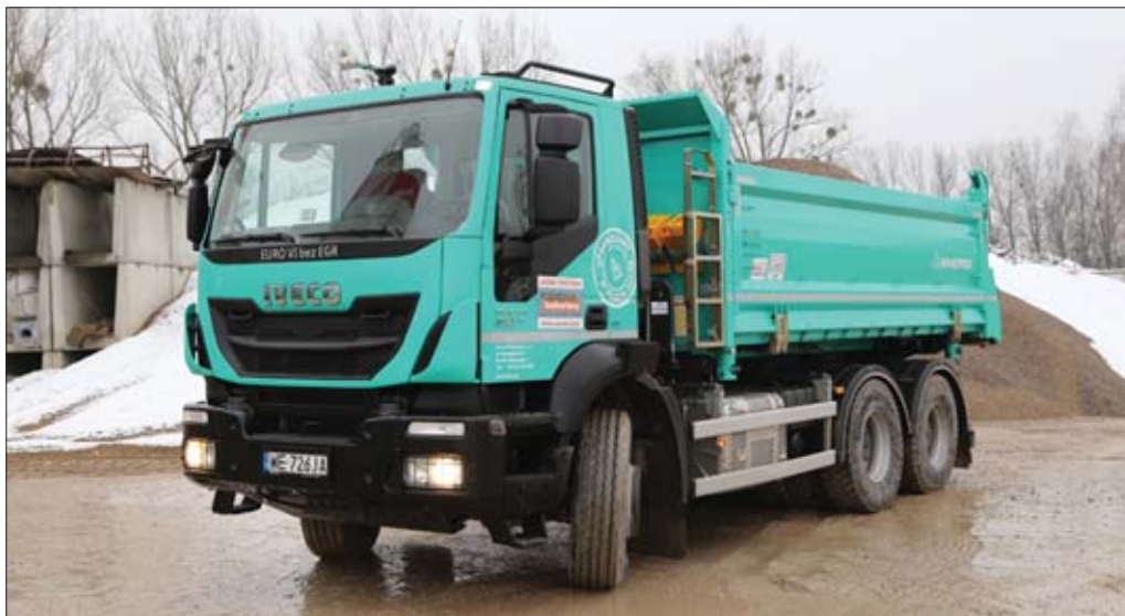
Wysoko zawieszona podwozie Trakкера z odpowiednio zabezpieczonym silnikiem zachęca kierowcę do śmielszego pokonywania wymagających bezdroży
