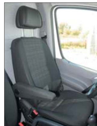
Fotele nowego Sprintera mają teraz sztywniejszą piankę i podszewkę lepiej przepuszczającą powietrze
