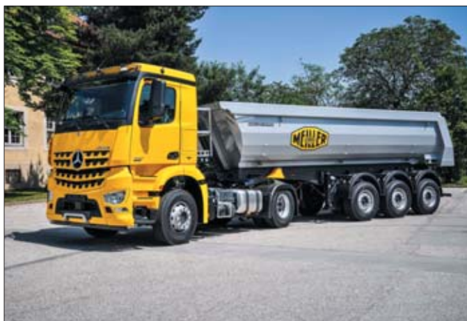
Nowe naczepy-wywrotki mają przeprojektowane muldy. Powoduje to obniżenie środka ciężkości, a tym samym lepsze prowadzenie zestawu i łatwiejszy załadunek
