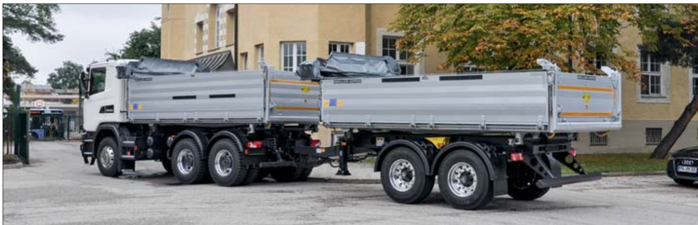
Przyczepy centralnoosiowe najczęściej stosowane są z wywrotkami 3-osiowymi. Do obu pojazdów dostępna jest automatycznie zaciągana plandeka. Rozwiązanie to przyczynia się do istotnego zmniejszenia czasu obsługi pojazdów
