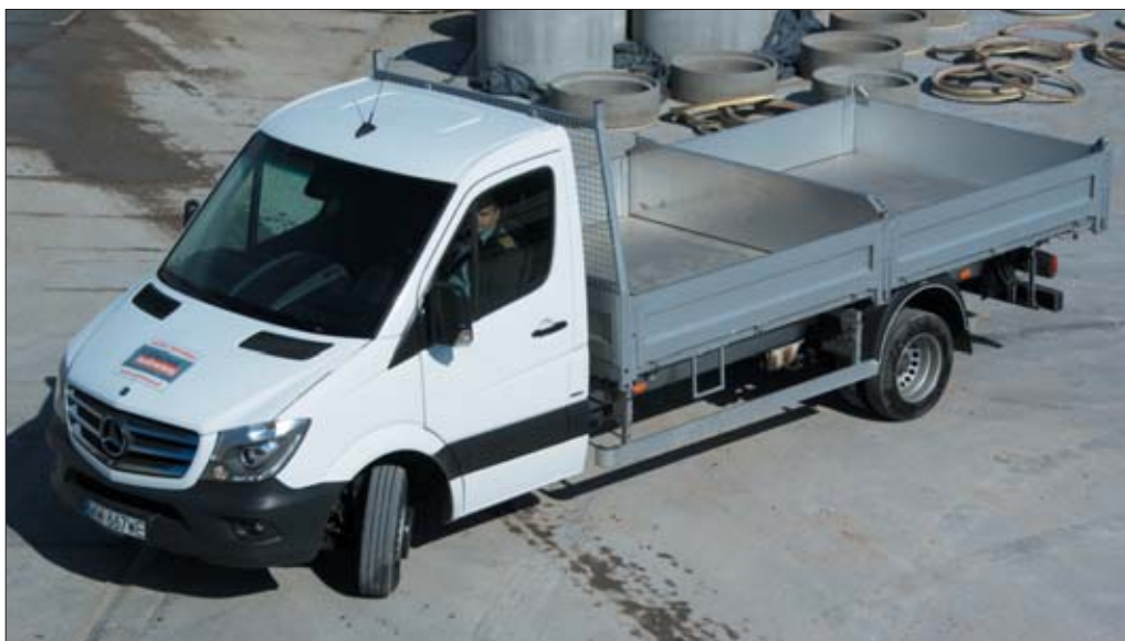
Testowy Sprinter ma masę własną 2.885 kg, co przy dopuszczalnej masie całkowitej równej 3.500 kg oznacza ładowność 615 kg. W ten sposób najlepiej nadaje się do przewożenia lżejszych materiałów, ale mogących zajmować dużo miejsca
