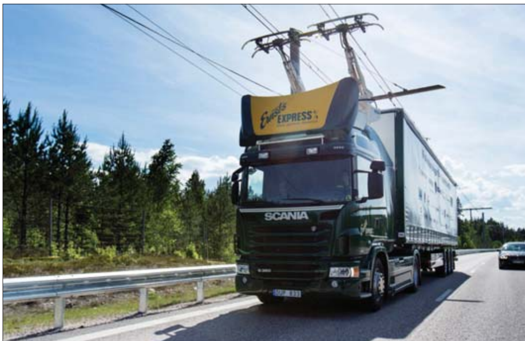
Powstanie dwukilometrowego fragmentu zelektryfikowanej autostrady E16 przebiegającej w pobliżu miejscowości Sandviken i Gävle jest wynikiem wspólnej inicjatywy przedstawicieli sektora prywatnego i publicznego ze Szwecji i Niemiec
