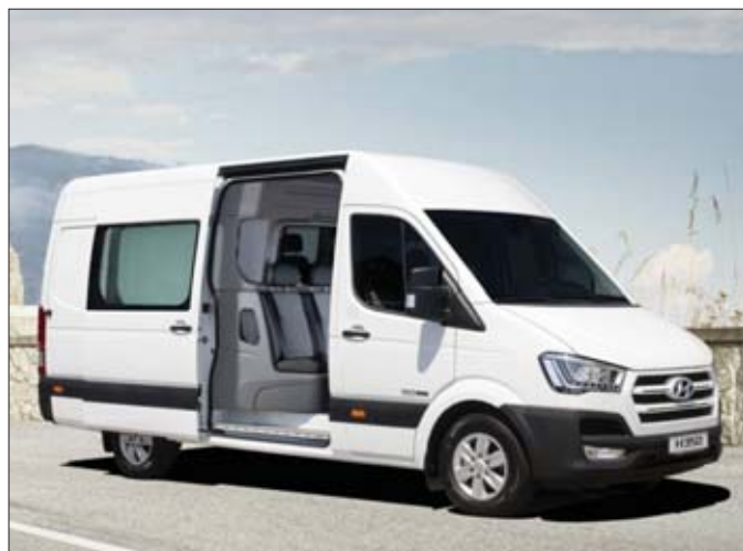
Opracowaną od podstaw konstrukcję nadwozia charakteryzuje wysoka sztywność i mała masa własna. Do jej budowy wykorzystano stal o podwyższonej wytrzymałości
