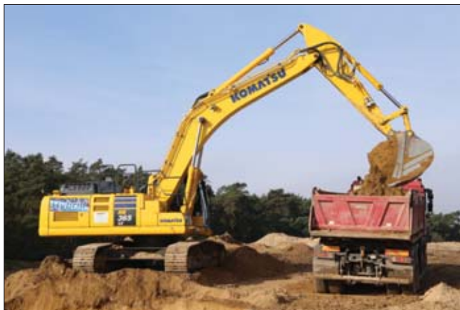
Przy załadunku pojazdów hybryda Komatsu pracuje w idealnych warunkach. Charakter wykonywanego zadania wymaga wykonywania cyklicznych obrotów o kąt 180°
