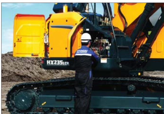
Możliwość wykonywania codziennych czynności obsługowych z poziomu gruntu pozwala ograniczyć czas wyłączania maszyny z normalnej eksploatacji
