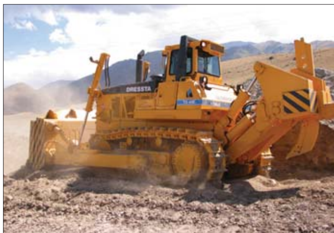
W maszynach zastosowano wzmocnienia układu roboczego w postaci dodatkowych nakładek na lemiesz oraz nakładek na jego belki
