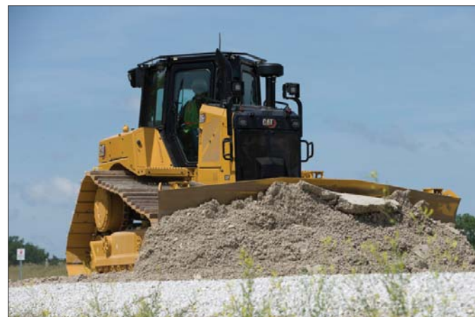
Elektryczny układ napędowy zastosowany w nowej generacji spycharce D6 XE zapewnia najwyższą wydajność przy jednoczesnej redukcji zużycia paliwa
