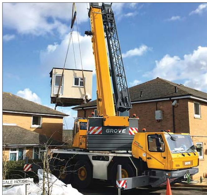
Żuraw GMK3060L został wyposażony w opcję MAXbase dla zmiennych ustawień stabilizacji pozwalającą na zwiększenie wykresów obciążenia w niektórych zakresach
