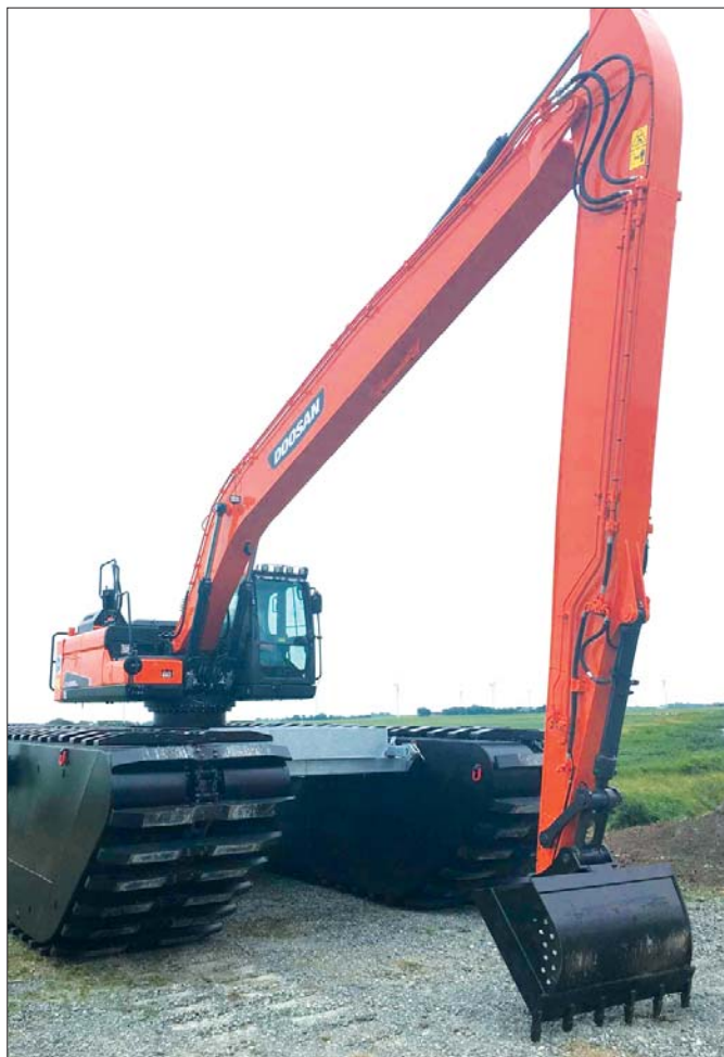
Nośność podwozia umożliwiającego przemieszczanie się koparki-amfibii z prędkością czterech kilometrów na godzinę wynosi osiemnaście ton
