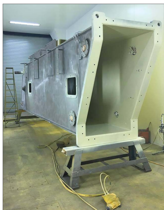
Dla Kocurek Excavators priorytetem jest zachowanie mocnej struktury konstrukcji, dlatego też wysięgniki produkowane są z użyciem stali Strenx 700 firmy SSAB
