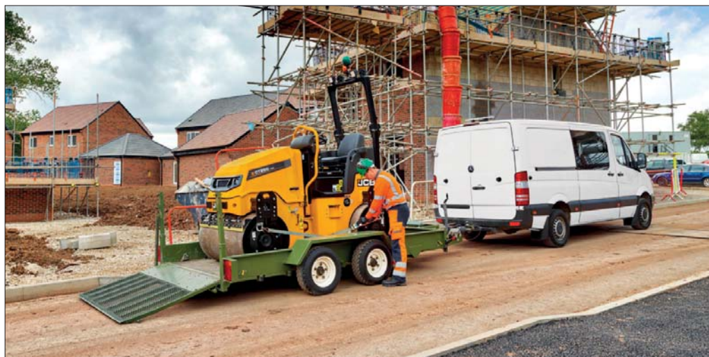
Tandemowe walce wibracyjne JCB można przewozić na niewielkiej przyczepie, co pozwala dodatkowo ograniczać koszty eksploatacyjne i zapewnia większą elastyczność działania użytkownikom maszyn
