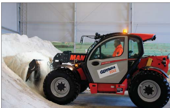
Warunki eksploatacyjne ładowarek nie należą do najłatwiejszych. Pryzmowana sól drogowa jest bowiem minerałem o żrących właściwościach
