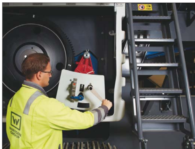
System „Lock & Turn” zapewnia maksymalne bezpieczeństwo podczas częstej wymiany części i komponentów podlegających naturalnemu zużyciu
