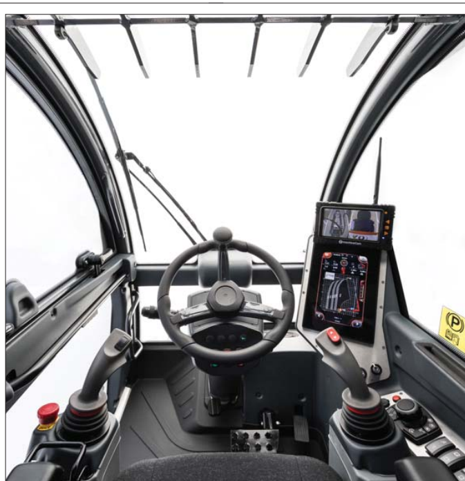
Wszystkie obrotowe ładowarki teleskopowe Bobcat mają w kabinie duży, czytelny ekran dotykowy umożliwiający intuicyjne sterowanie maszyną
