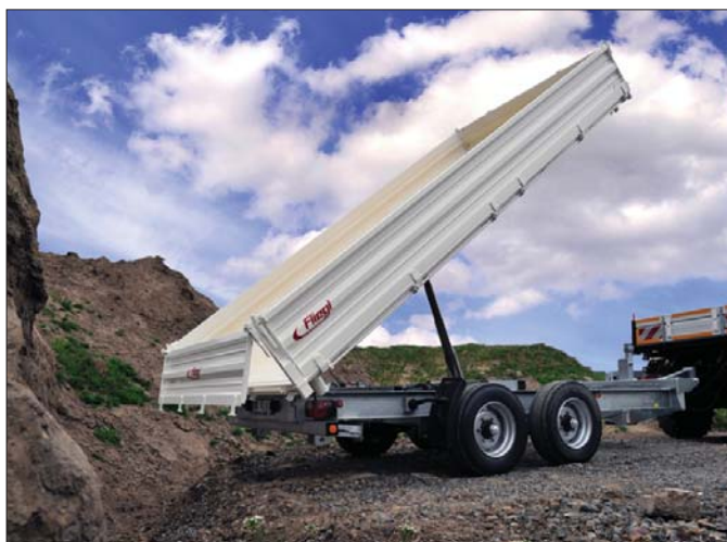
Przyczepa z trójstronnym wywrotem poza przewozem kruszywa bez trudu poradzi sobie także z bezpiecznym transportem kompaktowych maszyn budowlanych
