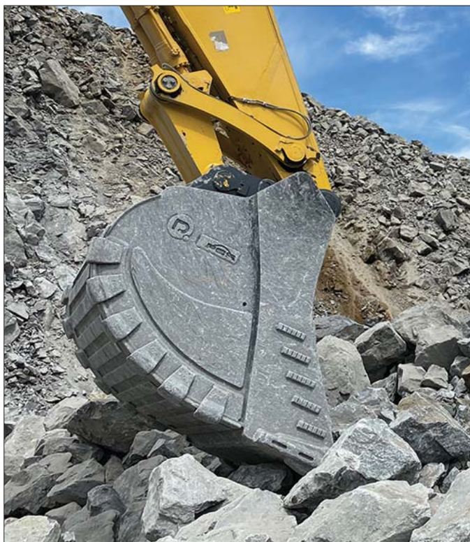
Na koparce Komatsu PC1250 pracującej na wyrobisku bezpośrednio pod ścianą zamontowano łyżkę-gigant mogącą pomieścić aż 7 m 3 ciężkiego urobku
