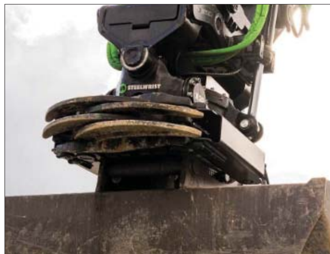
Open-S, otwarty standard dla w pełni automatycznych szybkozłaczy przeznaczonych do koparek, ma na celu ułatwienie warunków pracy użytkowników
