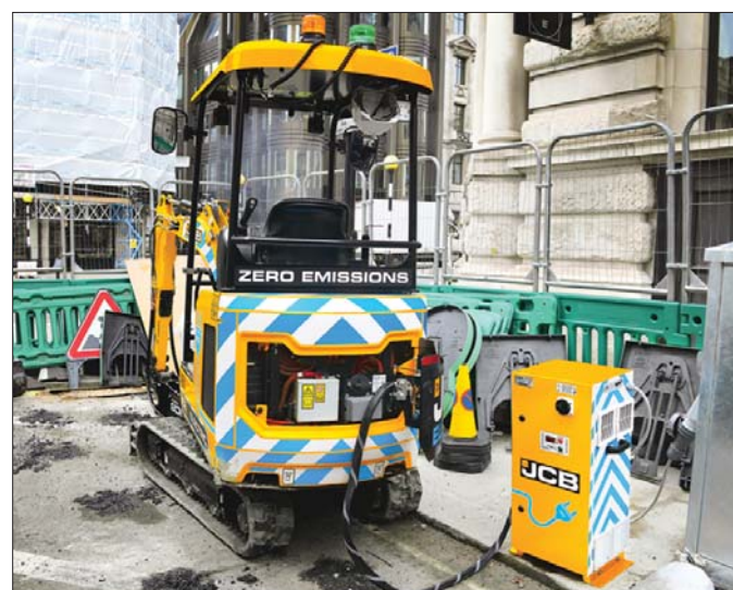
W razie potrzeby użytkownik maszyny E-TECH może skorzystać z ładowarki uniwersalnej JCB i w krótkim czasie uzupełnić stan baterii trakcyjnej
