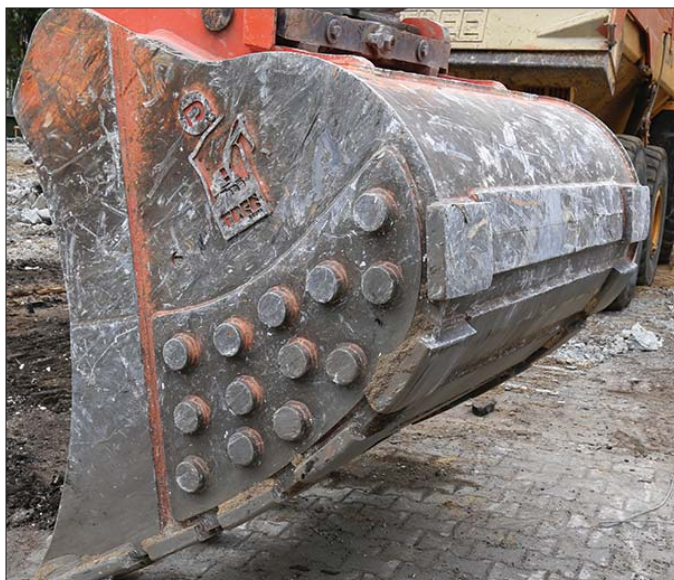
Na bokach łyżki zamocowano osłony w formie krążków ze stali trudnościarnej, co pozwoliło dwukrotnie zwiększyć odporność na uszkodzenia powodowane tarciem
