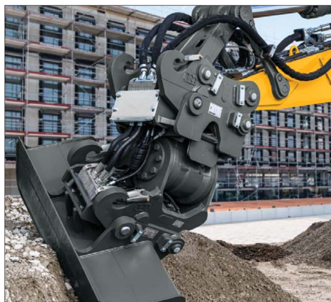
Głowica uchylno-obrotowa Liebherr LiTiU umożliwia poszerzenie zakresu zastosowań koparek kołowych oraz gąsienicowych
