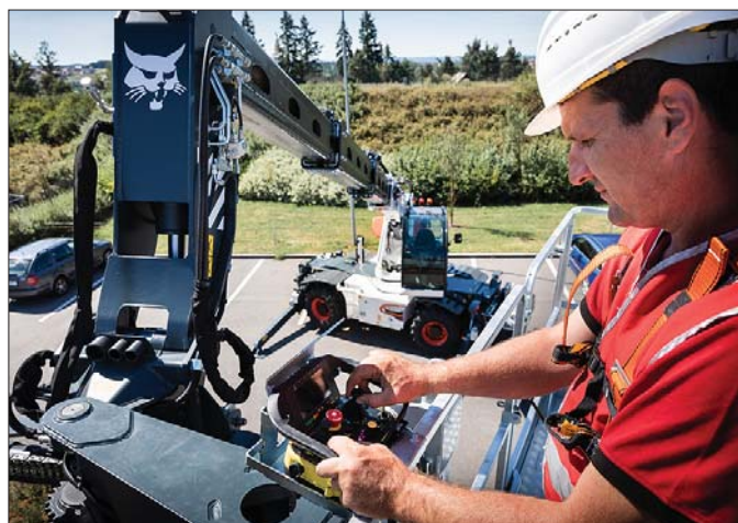
Moduł sterowania radiowego z ekranem pozwala na zdalną jazdę maszyną i obsługę podpór stabilizacyjnych bezpośrednio z kosza
