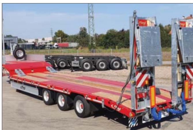
Naczepa niskopodwoziowa Fliegl SDS 470 z hydraulicznie opuszczanymi najazdami nadaje się idealnie do transportu cięższych maszyn budowlanych
