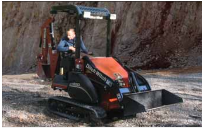
XT850 składa się ze stałej części koparkowej i płyty montażowej, do której przy pomocy szybkozłączek dołączyć można siedemdziesiąt różnych narzędzi roboczych
