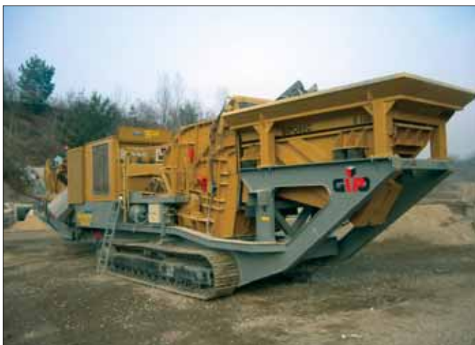
Przykładem udanego zastosowania systemu BIODRIVE w fabrycznie nowej maszynie jest napędzana silnikiem Caterpillar kruszarka GIPOREC 100C szwajcarskiego producenta GIPO AG
