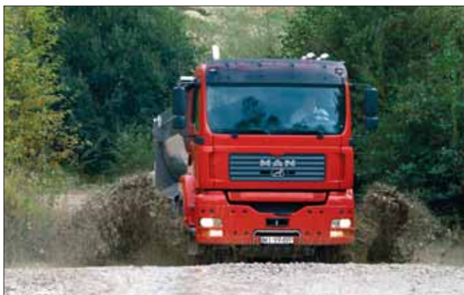
Zalety napędu MAN HydroDrive docenić można szczególnie podczas jazdy bez ładunku, po drogach nieutwardzonych, śliskich nawierzchniach i wzniesieniach, kiedy to łatwo może dojść do utraty przyczepności kół napędowych
