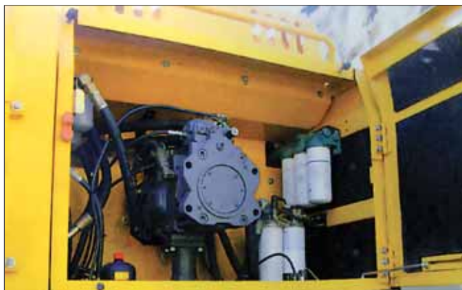
Konstruktorzy Volvo pomyśleli o ułatwieniu prac serwisowych, co jest niezwykle ważne w przypadku tak dużej maszyny. Filtry oleju silnikowego, paliwa i powietrza są łatwo dostępne
