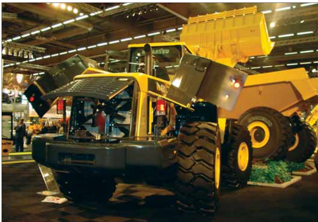
Nowoczesne maszyny wykorzystywane w budownictwie, takie jak prezentowana na zdjęciu ładowarka kołowa Komatsu WA 480 w związku z nagromadzeniem w ich konstrukcji mechanizmów roboczych o różnorodnych zadaniach są skomplikowane w obsłudze smarowniczej
