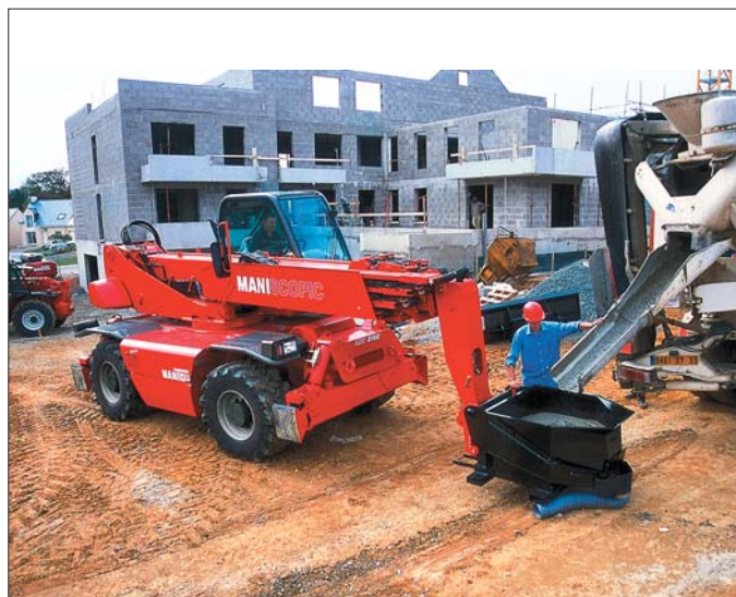
Ładowarka teleskopowa z obrotem MANITOU MRT 2150 M Series wyposażona w kosz do betonu
