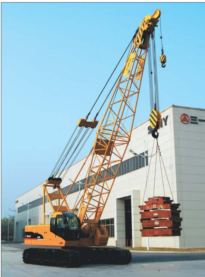
Nowością w ofercie koncernu SANY jest dźwig linowy na podwoziu gąsienicowym. Maszyna z łatwością podnosi ciężar dochodzący do 155 ton
