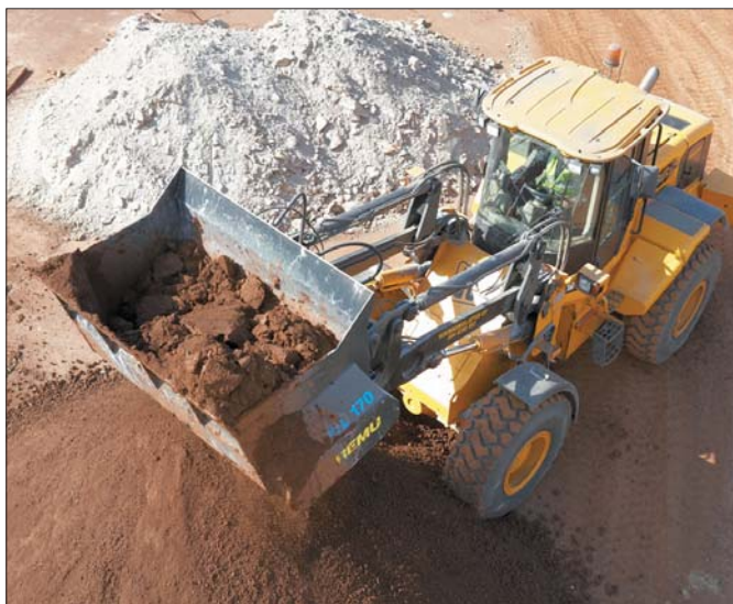
REMU oferuje łyżki przesiewające do ładowarek kołowych o ładowności od 3 do 20 ton. Tak wyposażona maszyna doskonale nadaje się do pracy z twardym materiałem, takim jak żwir, beton lub asfalt
