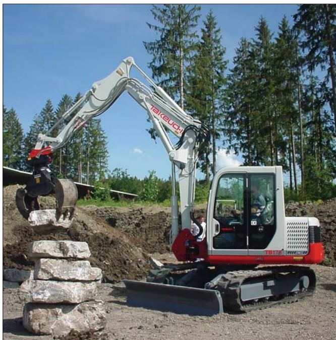
Minikoparka TB 175 ma wiele zalet. W seryjnym wyposażeniu posiada między innymi: zabezpieczenie przed pęknięciem rury, zawory podtrzymywania obciążenia oraz alarm przeciążenia ostrzegający operatora, że transportowany ciężar przekracza dopuszczalną wartość
