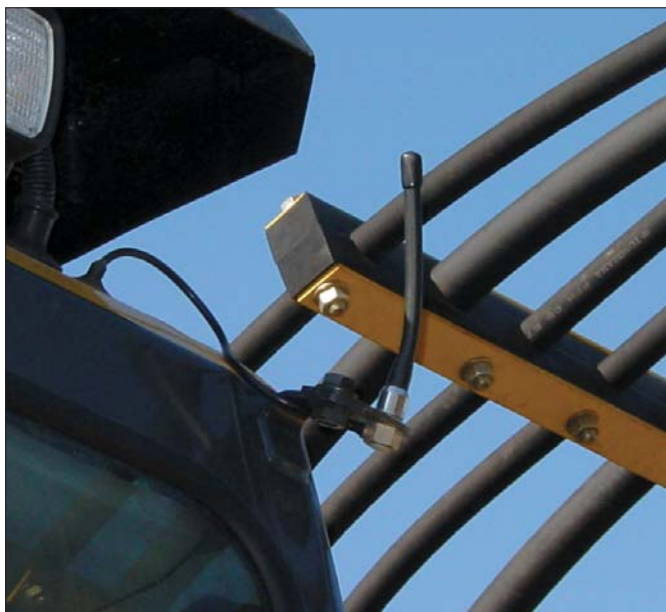
Na zewnątrz widać tylko niepozorną antenę. Serce systemu Komtrax optymalizującego pracę maszyn Komatsu mieści się w niewielkiej skrzyneczce zintegrowanej z komputerem pokładowym...
