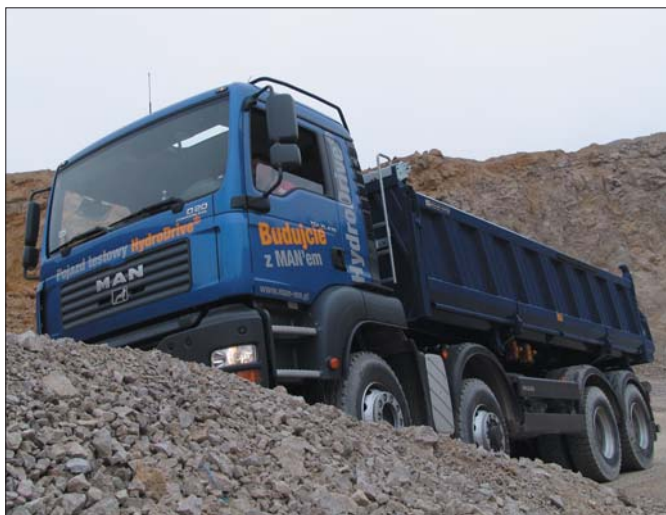
System HydroDrive dzięki wykorzystaniu hydrostatycznych silników w piastach kół zapewnia pojazdom MAN TGA doskonałą trakcję osi przedniej
