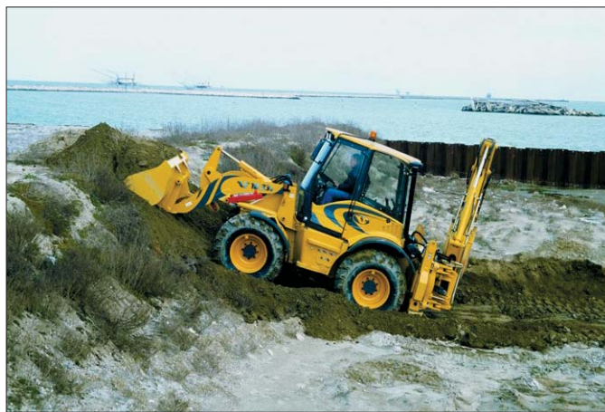
Legitymująca się 62-letnią historią włoska firma VF Venieri to jeden z najstarszych europejskich producentów ładowarek i koparko-ładowarek. Te ostatnie konstruowane są na bazie klasycznej ładowarki z czterema równymi i sterowanymi kołami
