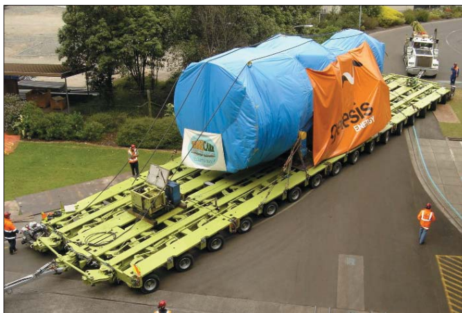
Ważąca 377 ton turbina umieszczona została na 2x16-osiowej kombinacji połączonych równolegle wózków Goldhofera
