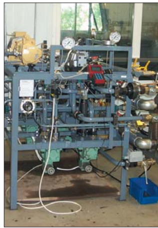
Stanowisko do weryfikacji pomp i silników z zakresu NG 16-250 ccm/obr
