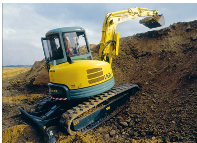
Ammann-Yanmar zaprezentował dwa nowe modele koparek z zerowym obrotem wieżyczki. Jedną z nich jest ważąca 4.625 kg Universal ViO50...
