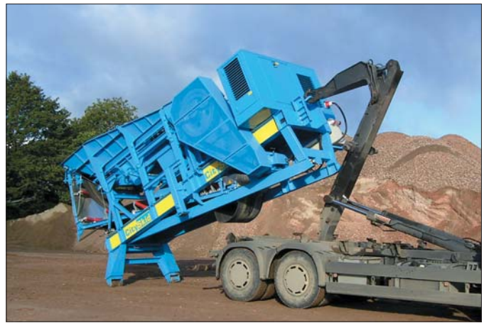
Kruszarnie City Skid 9V3/9V4 można transportować na podwoziu hakowca
