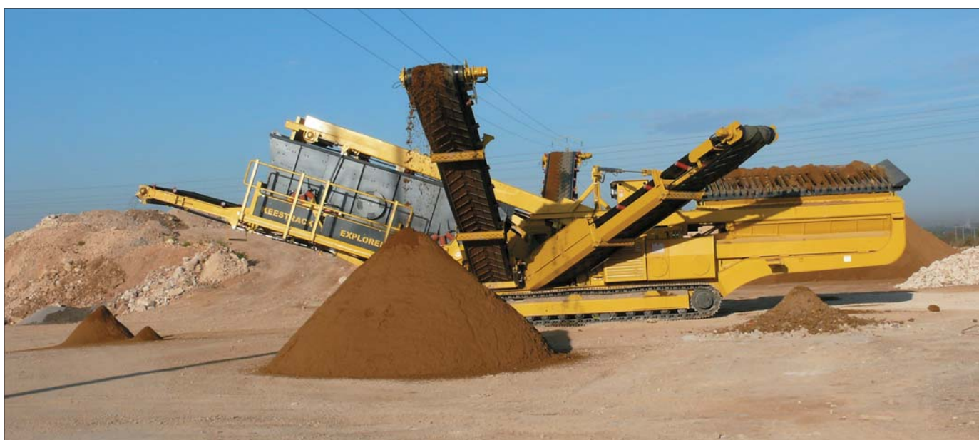
Keestrack produkuje siedem modeli przesiewaczy mobilnych o najwyższych standardach jakości. Wśród nich znajduje się trójpokładowy EXPLORER 1800 3D przeznaczony między innymi do przesiewania wtórnego
