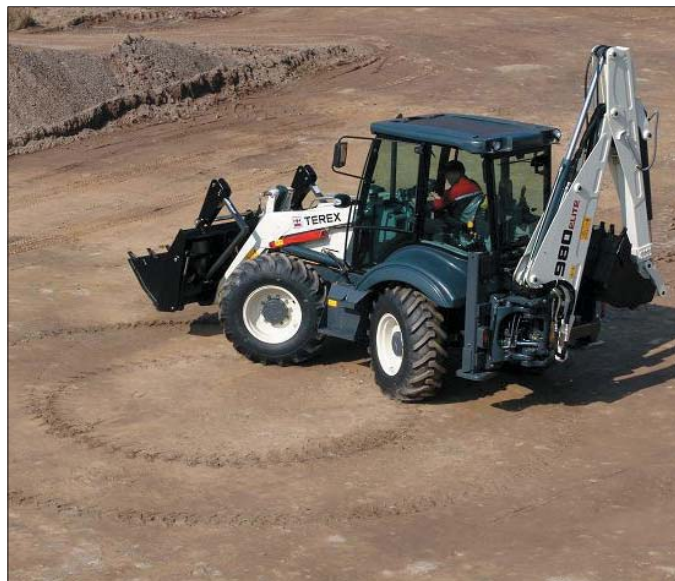
W modelu 970 Elite konstruktorzy zastosowali wszystkie koła skrętne. Zaletą takiego rozwiązania jest osiągnięcie jednego z najmniejszych – bo wynoszącego zaledwie 7,3 metra - promienia skrętu maszyny...
