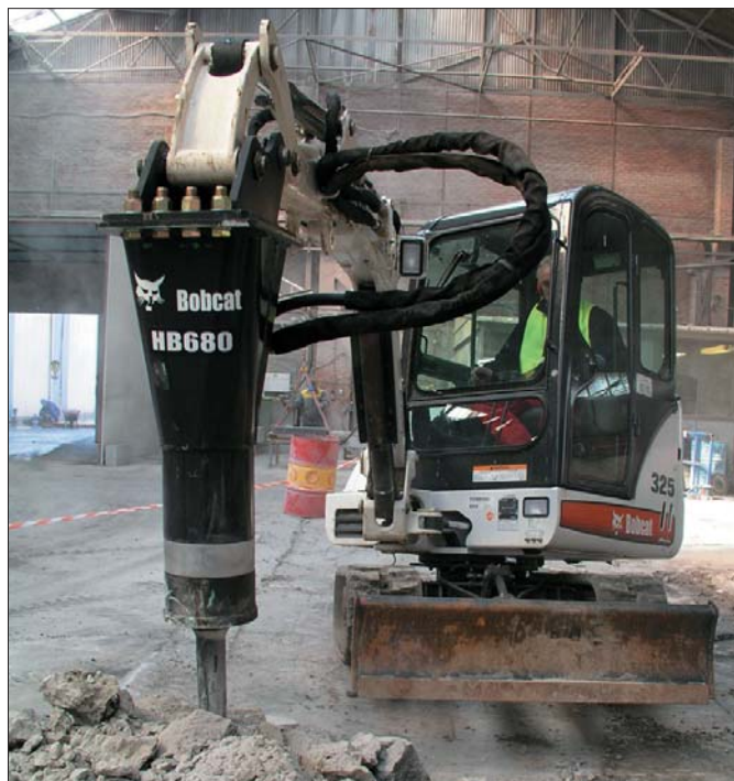
Możliwość wykorzystania różnego rodzaju przystawek roboczych, takich jak na przykład młot hydrauliczny, znacznie zwiększa zakres zastosowań maszyn kompaktowych Bobcat
